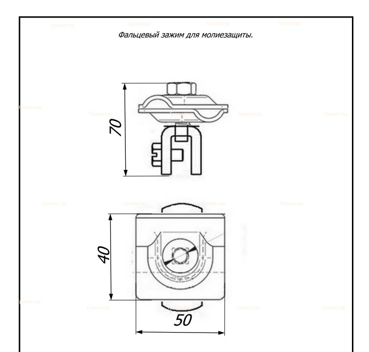
Фальцевый зажим для молиезащиты предназначен для крепления круглого проводника Ø6-Ø10 мм как элемент прикрепляющий к фальцу при установке системы молниезащиты или на нетипичные конструкции. Подходит к фальцевым кровельным покрытиям.
