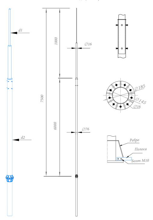
Молниеотвод 7,5 метров Gromostar предназначен для установки на объекты при выполнении работ по молниезащите. В комлект входит: молниеприёмная мачта, закладная для установки мачты на грунт, соединитель. Подробности касающиеся способа установки и крепления найдете на сайте.
