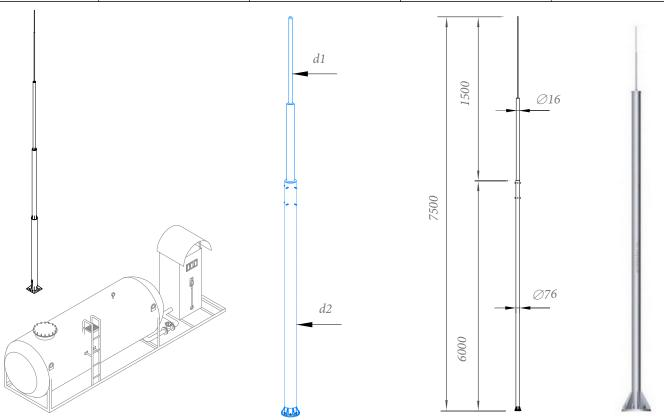
Молниеотвод 7,5 метров Gromostar выпускается из оцинкованной сталь St/Zn, нержавеющей стали VA. Возможна окраска в стандартные цвета. Соответствует нормативным документам регламентирующими требования к молниезащите зданий: «Инструкция по молниезащите зданий и сооружений» РД 34.21.122-87 от 30 июля 1987 года и «Инструкция по устройству молниезащиты зданий, сооружений и промышленных коммуникаций» СО 153-343.21.122-2003 от 30 июля 2003 г
