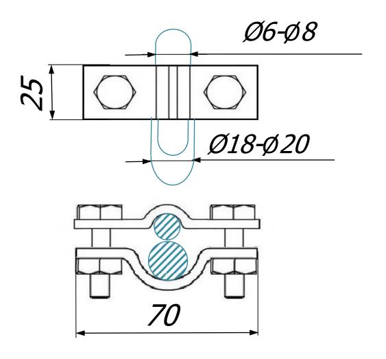
Соединитель круглого проводника Ø6 мм. - Ø8 мм. и прута Ø18 мм. - Ø20 мм. с двумя болтами зажатия, размером 70х70 мм предназначен для соединения круглых и плоских проводников. Соединители выпускаются из различных материалов что дает возмолность соединять круглые и плоские проводники, молниеприёмники и стержни заземления всех видов. При помощи соединителя можно соединить проводник параллельно.
