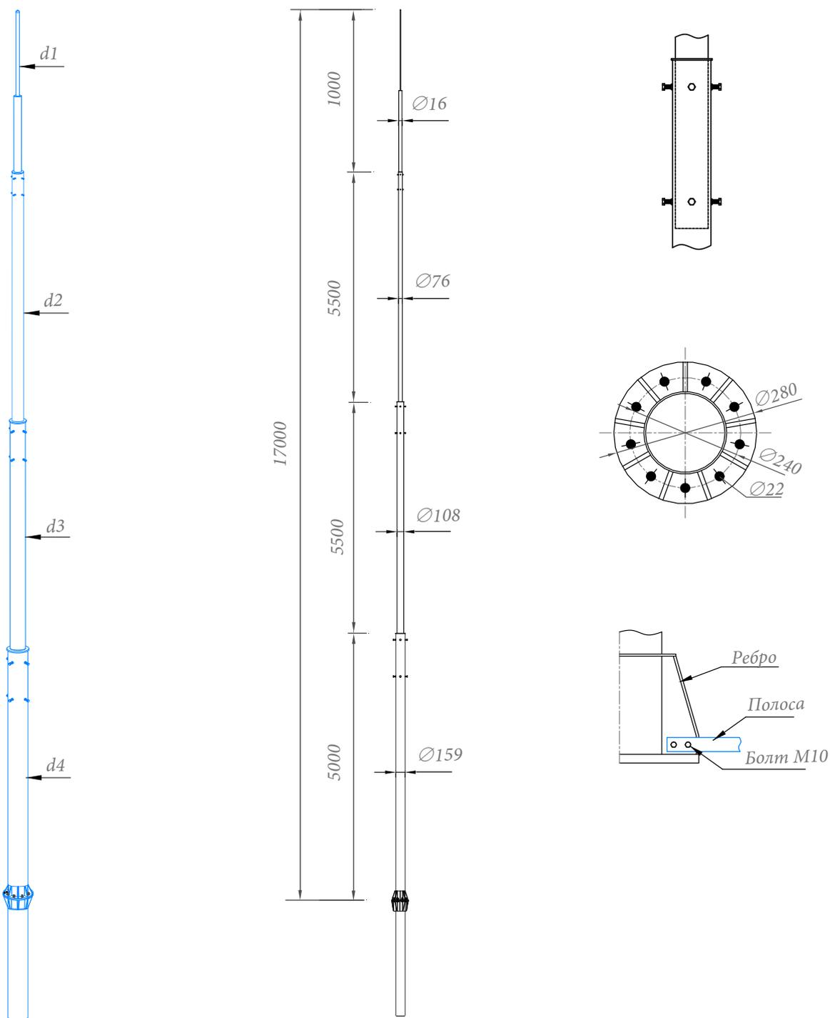
Молниеотвод 17 метров Gromostar предназначен для установки на объекты при выполнении работ по молниезащите. В комплект входит: молниеприёмная мачта, закладная для установки мачты на грунт, соединитель. Подробности касающиеся способа установки и крепления найдете на сайте.
