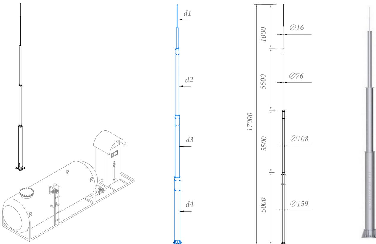
Молниеотвод 17 метров Gromostar выпускается из оцинкованной стали St/Zn, нержавеющей стали VA. Возможна окраска в стандартные цвета. Соответствует нормативным документам регламентирующими требования к молниезащите зданий: «Инструкция по молниезащите зданий и сооружений» РД 34.21.122-87 от 30 июля 1987 года и «Инструкция по устройству молниезащиты зданий, сооружений и промышленных коммуникаций» СО 153-343.21.122-2003 от 30 июня 2003 г
