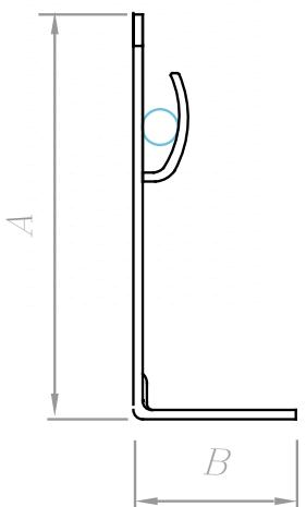
Держатель проводника устанавливается на кровлю из металлической, профнастила, мягкой (гибкой) черепицы и на кровлю из волновых листов. Так же может устанавливаться на паралеты, ветровые планки, стены и трубы.
