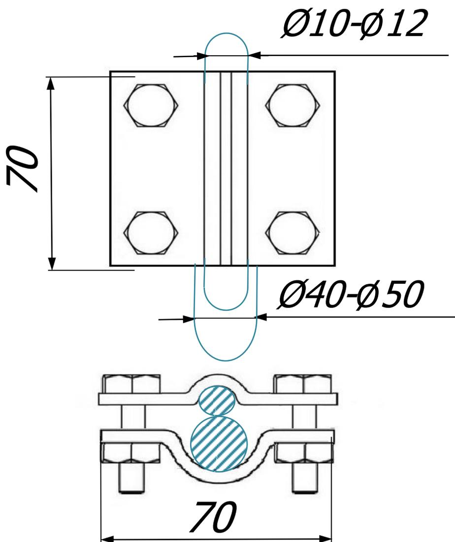
Соединитель круглого проводника  $\varnothing 10$  мм. -  $\varnothing 12$  мм. и молниеприемной мачты  $\varnothing 40$  мм. -  $\varnothing 50$  мм. с четырьмя болтами зажатия, размером 70x70 мм предназначен для соединения круглых и плоских проводников. Соединители выпускаются из различных материалов что дает возможность соединять круглые и плоские проводники, молниеприёмники и молниеприемной мачты. При помощи соединителя можно соединить проводник параллельно, перпендикулярно или Т-образно.
