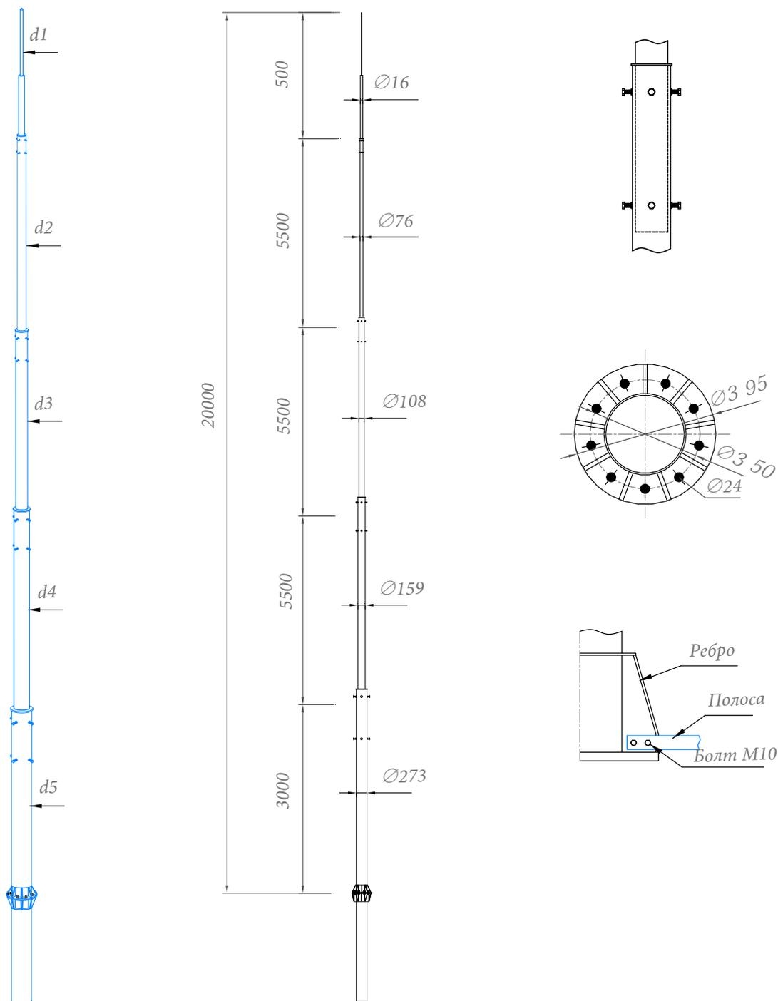
Молниеотвод 20 метров Gromostar предназначен для установки на объекты при выполнении работ по молниезащите. В комплект входит: молниеприёмная мачта, закладная для установки мачты на грунт, соединитель. Подробности касающиеся способа установки и крепления найдете на сайте.
