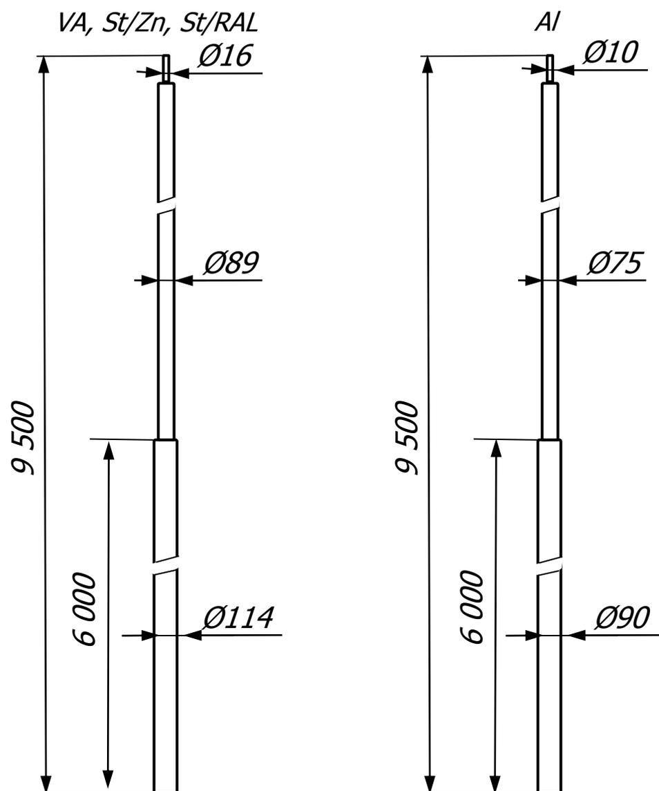
Мачта молниеприёмная 9,5 метров предназначен для молниезащиты элементов крыши, зданий, сооружений и т.д., которые согласно технике безопасности, должны быть защищены от попадания молнии. При установке надо использовать подходящие крепления для мачт, в зависимости от места их установки.
