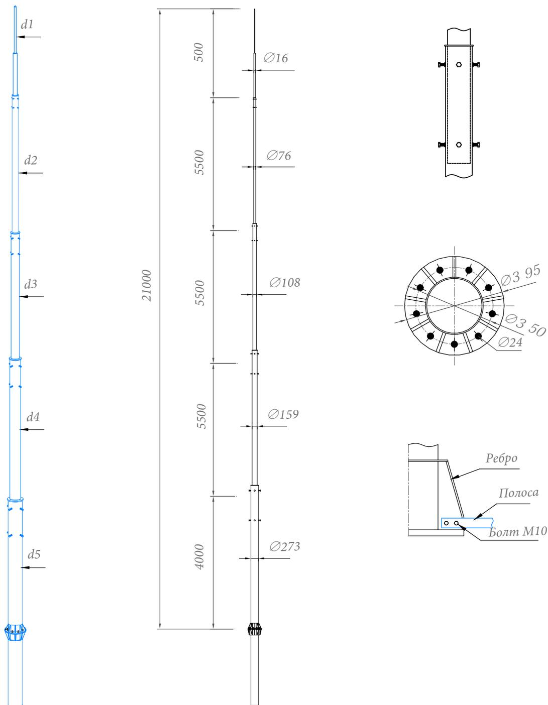
Молниеотвод 21 метр Gromostar предназначен для установки на объекты при выполнении работ по молниезащите. В комплект входит: молниеприёмная мачта, закладная для установки мачты на грунт, соединитель. Подробности касающиеся способа установки и крепления найдете на сайте.
