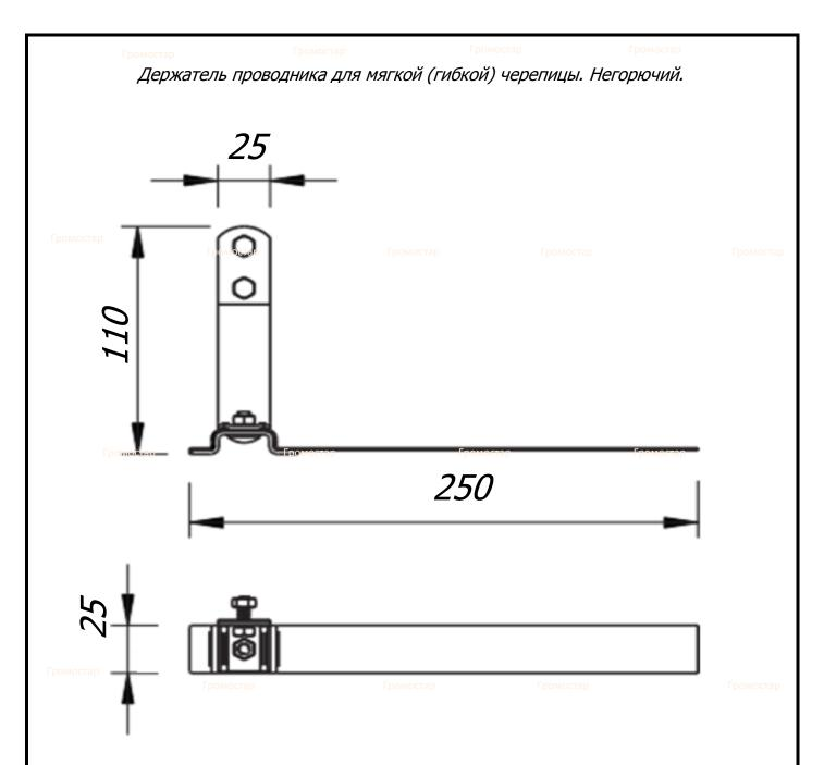
круглого проводника Ø6-Ø10 мм. на кровле. Высота H=110 мм. Крепится при помощи шурупов, заклёпок или гвоздей к обрешетике. Держатель позволяет на проведение проводника параллельно или перпендикулярно краю крыши. Проводник крепится посредством вжатия в зажим.
