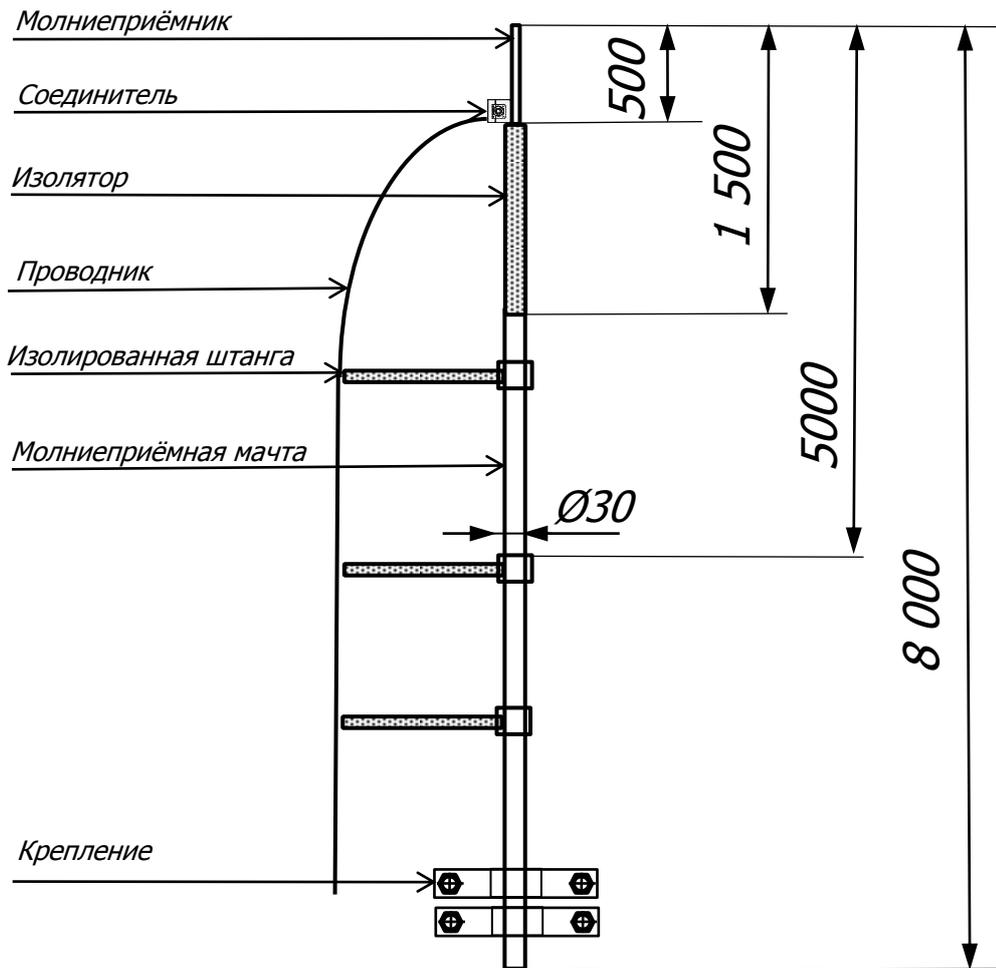
Молниеприёмная мачта с токоотводом высокого напряжения применяется в местах, где нет возможности установить мачту так, чтобы удалось сохранить изоляционные расстояния между молниеприёмной мачтой и устройством на крыше или другого охраняемого объекта. Выполнена молниеприёмная мачта из изолируемой штанги, на конце которой прикреплен молниеприёмник, который соединен с кабелем высокого напряжения при помощи соединения.
