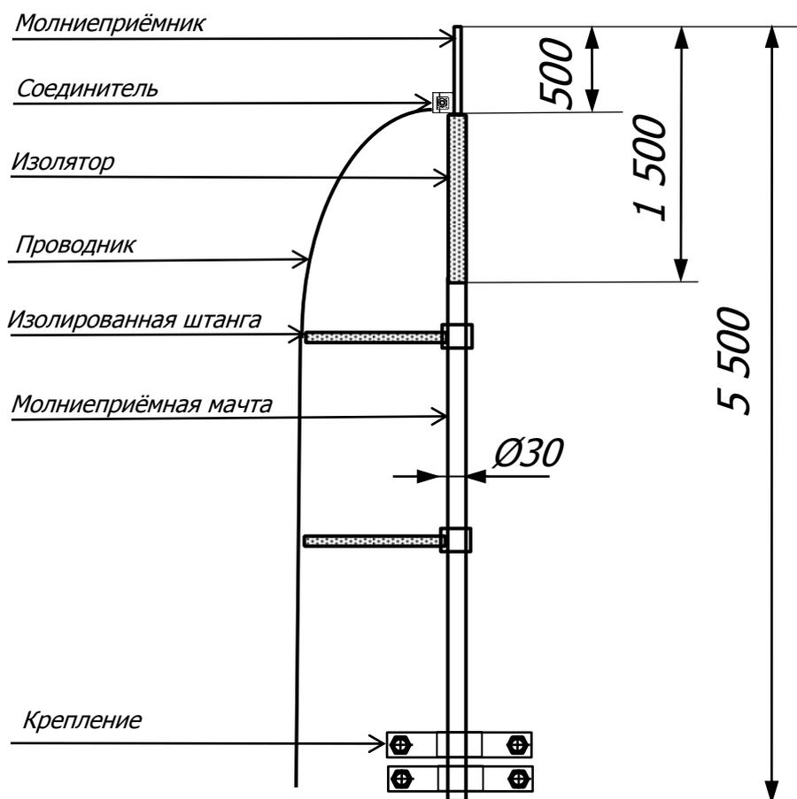
Молниеприёмная мачта с токоотводом высокого напряжения применяется в местах, где нет возможности установить мачту так, чтобы удалось сохранить изоляционные расстояния между молниеприёмной мачтой и устройством на крыше или другого охраняемого объекта. Выполнена молниеприёмная мачта из изолируемой штанги, на конце которой прикреплен молниеприёмник, который соединен с кабелем высокого напряжения при помощи соединения.
