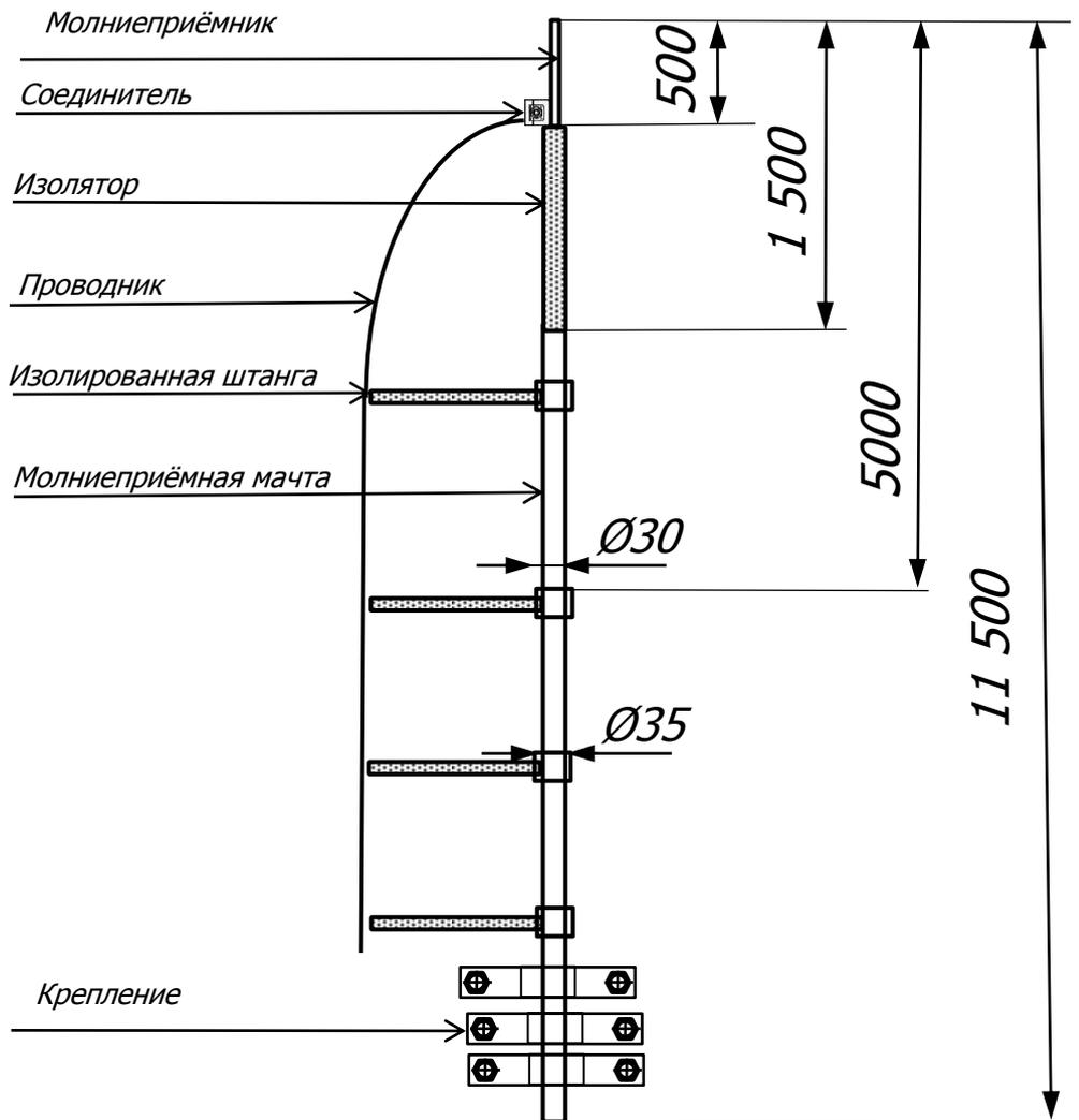
Молниеприёмная мачта с токоотводом высокого напряжения применяется в местах, где нет возможности установить мачту так, чтобы удалось сохранить изоляционные расстояния между молниеприёмной мачтой и устройством на крыше или другого охраняемого объекта. Выполнена молниеприёмная мачта из изолируемой штанги, на конце которой прикреплен молниеприёмник, который соединен с кабелем высокого напряжения при помощи соединения.
