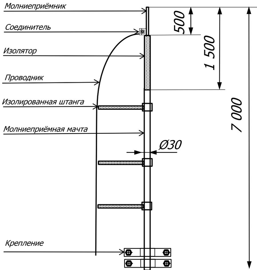
Молниеприёмная мачта с токоотводом высокого напряжения применяется в местах, где нет возможности установить мачту так, чтобы удалось сохранить изоляционные расстояния между молниеприёмной мачтой и устройством на крыше или другого охраняемого объекта. Выполнена молниеприёмная мачта из изолирующей штанги, на конце которой прикреплен молниеприёмник, который соединен с кабелем высокого напряжения при помощи соединения.
