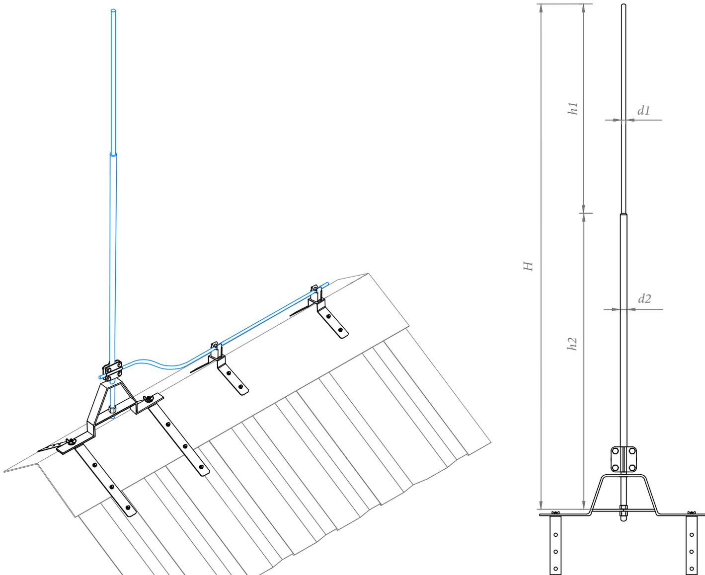
Мачта с креплением на прямой конек 3,5 метра Gromostar предназначен для установки на объекты при выполнении работ по молниезащите. Мачта с креплением на прямой конек имеет в комплекте: молниеприёмник, набор креплений на конёк, соединитель проводника и молниеприёмника. Мачта с креплением на прямой конек при правильных расчётах позволяет перехватывать молнии, тем самым защищать ваш объект. Подробности касающиеся способа установки и крепления найдете на сайте.
