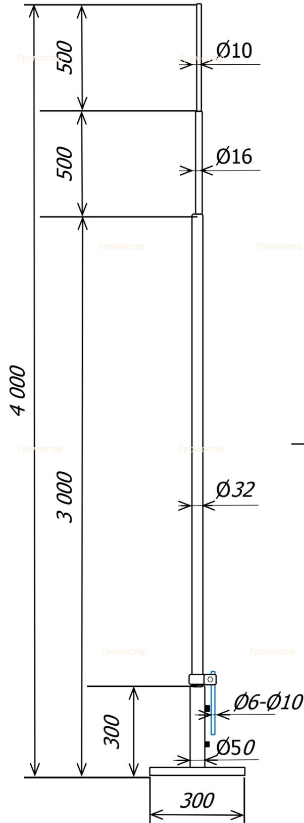
Молниеприёмная мачта Громостар на растяжках 4 метра предназначена для установки на плоскую и скатную кровлю. В комплект входит: молниеприёмная мачта, соединитель мачты и проводника диаметром 6-10 мм., крепление для мачты, комплект растяжек, крепёжные элементы. Устанавливается для защиты дымоходов либо других элементов крыши здания а также самого здания. Молниеприёмная мачта можно использовать также для защиты элементов вокруг неё.
