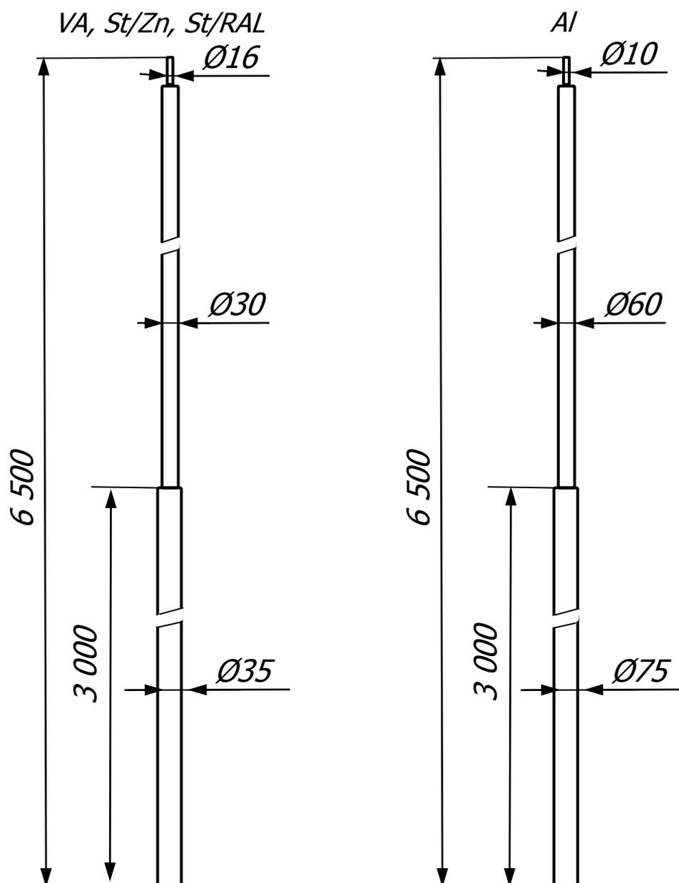
Мачта молниеприёмная 6,5 метров предназначен для молниезащиты элементов крыши, зданий, сооружений и т.д., которые согласно технике безопасности, должны быть защищены от попадания молнии. При установке надо использовать подходящие крепления для мачт, в зависимости от места их установки.
