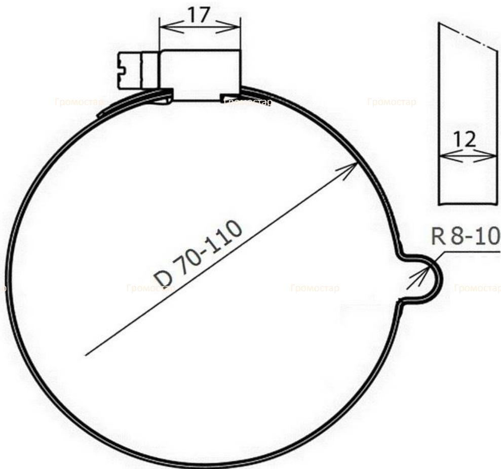
Хомут лента бандажная для труб до Ø 110 мм. для круглого проводника предназначена для закрепления токоотводов к водостокам или другим элементам конструкции. Гибкая и эластичная полоска из стали, адаптируется к различной форме, что позволяет установить систему молниезащиты на металлических конструкций различной форм. К обойме надо прикручивать непосредственно токоотвод.
