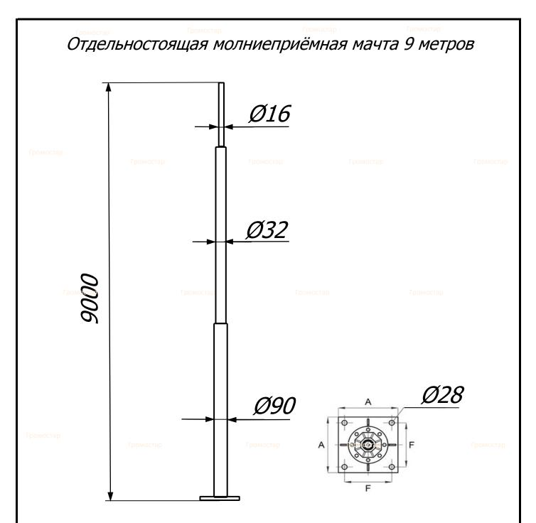
Отдельностоящая молниеприёмная мачта 9 метров Громостар предназначен для защиты от ударов молнии наружных установок, конструкций или других объектов, для которых необходимо использование системы молниезащиты. Сборная молниеприёмная мачта устанавливается на бетонный фундамент с анкерными закладными и закрепляется болтами.
