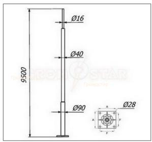
Отдельностоящая молниеприёмная мачта 9,5 метров Громостар выпускается из оцинкованной сталь St/Zn, нержавеющей стали VA, алюминия Al, окрашенной стали St/RAL с порошковой окраской в стандартные цвета. Для выполнения бетонного фундамента использовать закладные детали. Соответствует требованиям МЭК 50164
