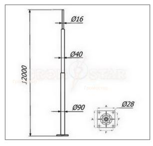
Отдельностоящая молниеприёмная мачта 12 метров Громостар выпускается из оцинкованной сталь St/Zn, нержавеющей стали VA, алюминия Al, окрашенной стали St/RAL с порошковой окраской в стандартные цвета. Для выполнения бетонного фундамента использовать закладные детали. Соответствует требованиям МЭК 50164
