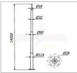
Отдельностоящая молниеприёмная мачта 14 метров Громостар выпускается из оцинкованной сталь St/Zn, нержавеющей стали VA, алюминия Al, окрашенной стали St/RAL с порошковой окраской в стандартные цвета. Для выполнения бетонного фундамента использовать закладные детали. Соответствует требованиям МЭК 50164
