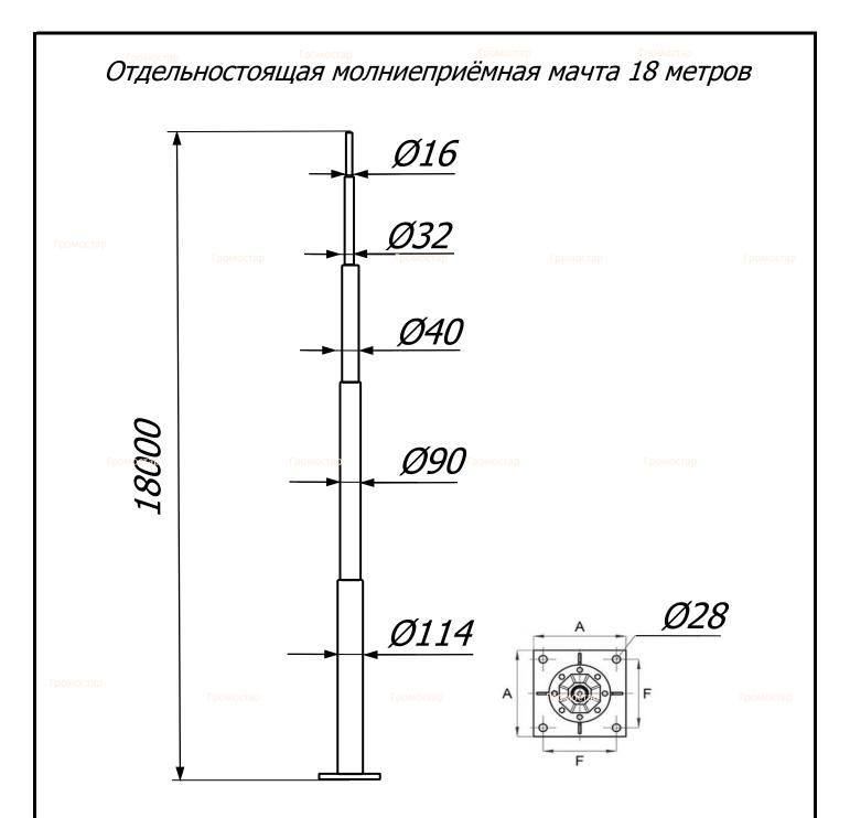
Отдельностоящая молниеприёмная мачта 18 метров Громостар предназначен для защиты от ударов молнии наружных установок, конструкций или других объектов, для которых необходимо использование системы молниезащиты. Сборная молниеприёмная мачта устанавливается на бетонный фундамент с анкерными закладными и закрепляется болтами.
