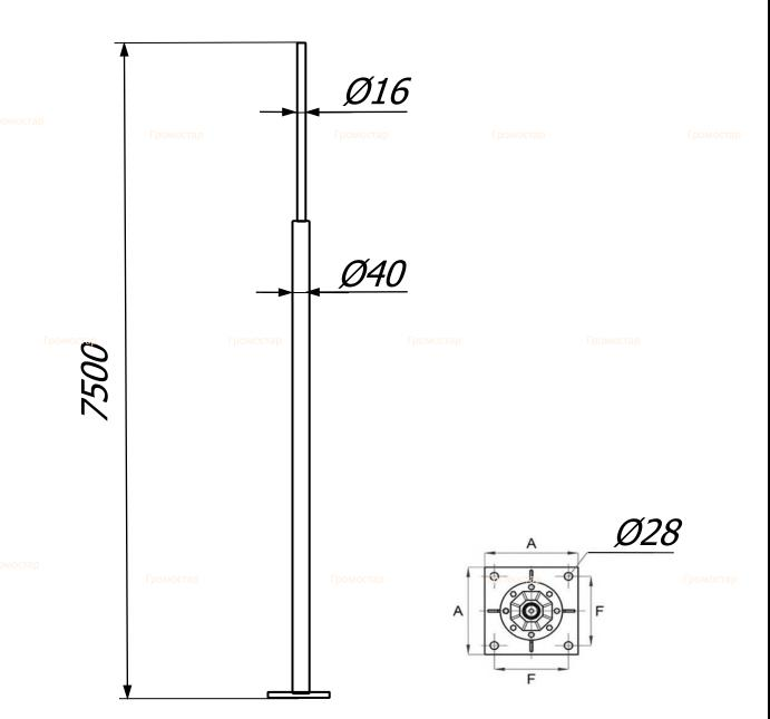
Отдельностоящая молниеприёмная мачта 7,5 метров Громостар предназначен для защиты от ударов молнии наружных установок, конструкций или других объектов, для которых необходимо использование системы молниезащиты. Сборная молниеприёмная мачта устанавливается на бетонный фундамент с анкерными закладными и закрепляется болтами.
