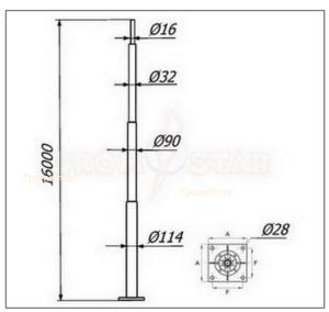
Отдельностоящая молниеприёмная мачта 16 метров Громостар выпускается из оцинкованной сталь St/Zn, нержавеющей стали VA, алюминия Al, окрашенной стали St/RAL с порошковой окраской в стандартные цвета. Для выполнения бетонного фундамента использовать закладные детали. Соответствует требованиям МЭК 50164
