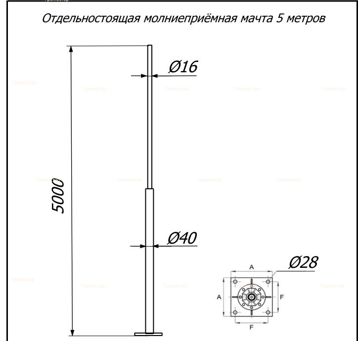
Отдельностоящая молниеприёмная мачта 5 метров Громостар предназначен для защиты от ударов молнии наружных установок, конструкций или других объектов, для которых необходимо использование системы молниезащиты. Сборная молниеприёмная мачта устанавливается на бетонный фундамент с анкерными закладными и закрепляется болтами.
