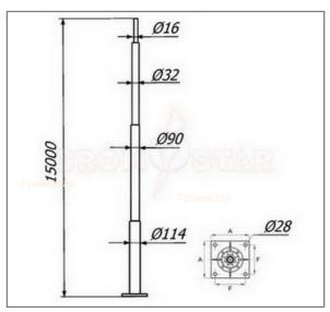
Отдельностоящая молниеприёмная мачта 15 метров Громостар выпускается из оцинкованной сталь St/Zn, нержавеющей стали VA, алюминия Al, окрашенной стали St/RAL с порошковой окраской в стандартные цвета. Для выполнения бетонного фундамента использовать закладные детали. Соответствует требованиям МЭК 50164
