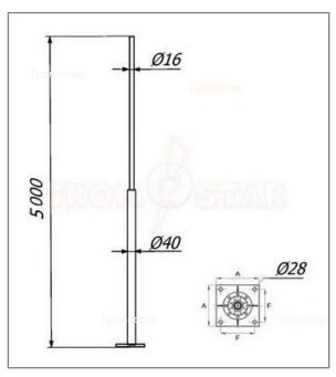
Отдельностоящая молниеприёмная мачта 5 метров Громостар выпускается из оцинкованной сталь St/Zn, нержавеющей стали VA, алюминия Al, окрашенной стали St/RAL с порошковой окраской в стандартные цвета. Для выполнения бетонного фундамента использовать закладные детали. Соответствует требованиям МЭК 50164
