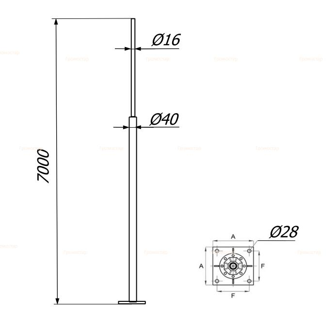
Отдельностоящая молниеприёмная мачта 7 метров Громостар предназначен для защиты от ударов молнии наружных установок, конструкций или других объектов, для которых необходимо использование системы молниезащиты. Сборная молниеприёмная мачта устанавливается на бетонный фундамент с анкерными закладными и закрепляется болтами.
