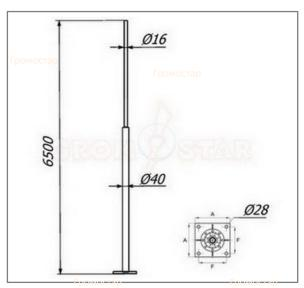
Отдельностоящая молниеприёмная мачта 6,5 метров Громостар выпускается из оцинкованной сталь St/Zn, нержавеющей стали VA, алюминия Al, окрашенной стали St/RAL с порошковой окраской в стандартные цвета. Для выполнения бетонного фундамента использовать закладные детали. Соответствует требованиям МЭК 50164
