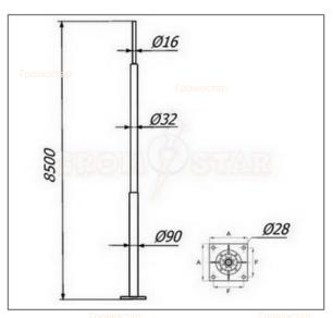
Отдельностоящая молниеприёмная мачта 8,5 метров Громостар выпускается из оцинкованной сталь St/Zn, нержавеющей стали VA, алюминия Al, окрашенной стали St/RAL с порошковой окраской в стандартные цвета. Для выполнения бетонного фундамента использовать закладные детали. Соответствует требованиям МЭК 50164
