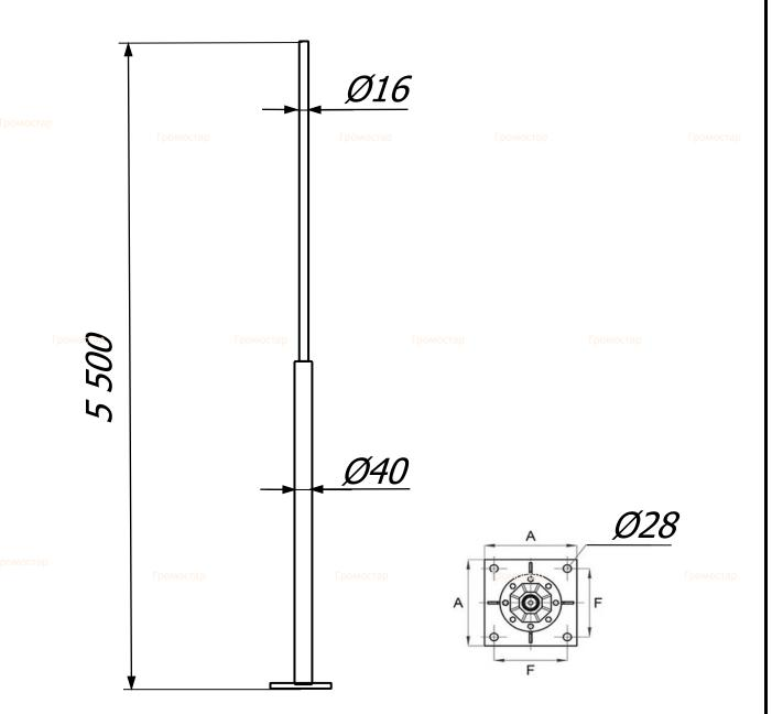
Отдельностоящая молниеприёмная мачта 5,5 метров Громостар предназначен для защиты от ударов молнии наружных установок, конструкций или других объектов, для которых необходимо использование системы молниезащиты. Сборная молниеприёмная мачта устанавливается на бетонный фундамент с анкерными закладными и закрепляется болтами.
