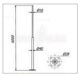
Отдельностоящая молниеприёмная мачта 6 метров Громостар выпускается из оцинкованной сталь St/Zn, нержавеющей стали VA, алюминия Al, окрашенной стали St/RAL с порошковой окраской в стандартные цвета. Для выполнения бетонного фундамента использовать закладные детали. Соответствует требованиям МЭК 50164
