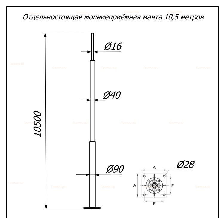
Отдельностоящая молниеприёмная мачта 10,5 метров Громостар предназначен для защиты от ударов молнии наружных установок, конструкций или других объектов, для которых необходимо использование системы молниезащиты. Сборная молниеприёмная мачта устанавливается на бетонный фундамент с анкерными закладными и закрепляется болтами.
