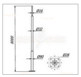
Отдельностоящая молниеприёмная мачта 8 метров Громостар выпускается из оцинкованной сталь St/Zn, нержавеющей стали VA, алюминия Al, окрашенной стали St/RAL с порошковой окраской в стандартные цвета. Для выполнения бетонного фундамента использовать закладные детали. Соответствует требованиям МЭК 50164
