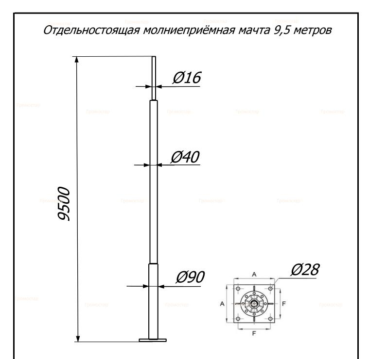
Отдельностоящая молниеприёмная мачта 9,5 метров Громостар предназначен для защиты от ударов молнии наружных установок, конструкций или других объектов, для которых необходимо использование системы молниезащиты. Сборная молниеприёмная мачта устанавливается на бетонный фундамент с анкерными закладными и закрепляется болтами.
