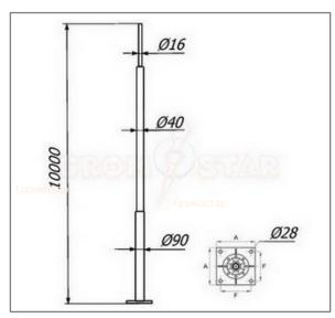
Отдельностоящая молниеприёмная мачта 10 метров Громостар выпускается из оцинкованной сталь St/Zn, нержавеющей стали VA, алюминия Al, окрашенной стали St/RAL с порошковой окраской в стандартные цвета. Для выполнения бетонного фундамента использовать закладные детали. Соответствует требованиям МЭК 50164
