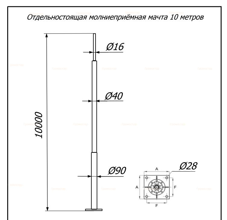
Отдельностоящая молниеприёмная мачта 10 метров Громостар предназначен для защиты от ударов молнии наружных установок, конструкций или других объектов, для которых необходимо использование системы молниезащиты. Сборная молниеприёмная мачта устанавливается на бетонный фундамент с анкерными закладными и закрепляется болтами.
