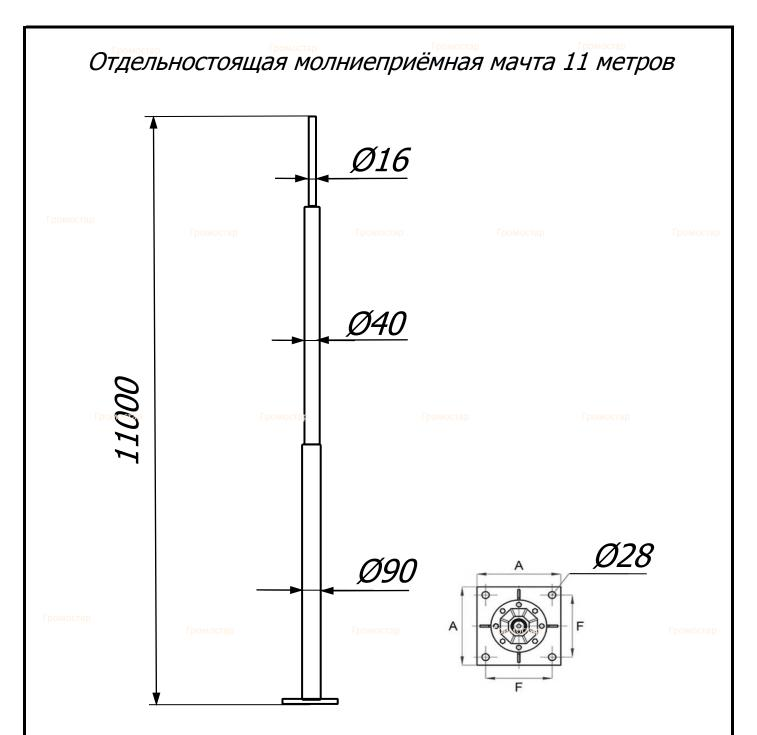
Отдельностоящая молниеприёмная мачта 11 метров Громостар предназначен для защиты от ударов молнии наружных установок, конструкций или других объектов, для которых необходимо использование системы молниезащиты. Сборная молниеприёмная мачта устанавливается на бетонный фундамент с анкерными закладными и закрепляется болтами.
