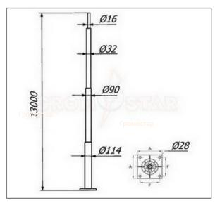
Отдельностоящая молниеприёмная мачта 13 метров Громостар выпускается из оцинкованной сталь St/Zn, нержавеющей стали VA, алюминия Al, окрашенной стали St/RAL с порошковой окраской в стандартные цвета. Для выполнения бетонного фундамента использовать закладные детали. Соответствует требованиям МЭК 50164
