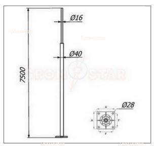
Отдельностоящая молниеприёмная мачта 7,5 метров Громостар выпускается из оцинкованной сталь St/Zn, нержавеющей стали VA, алюминия Al, окрашенной стали St/RAL с порошковой окраской в стандартные цвета. Для выполнения бетонного фундамента использовать закладные детали. Соответствует требованиям МЭК 50164
