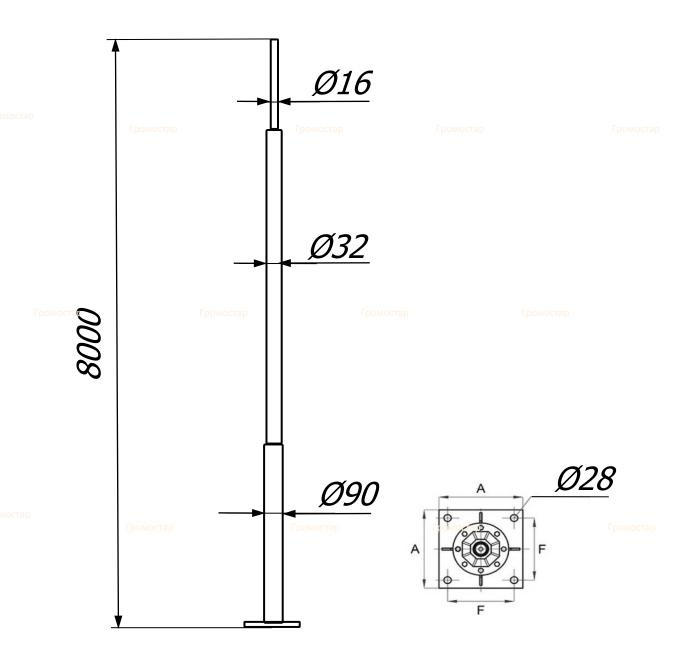
Отдельностоящая молниеприёмная мачта 8 метров Громостар предназначен для защиты от ударов молнии наружных установок, конструкций или других объектов, для которых необходимо использование системы молниезащиты. Сборная молниеприёмная мачта устанавливается на бетонный фундамент с анкерными закладными и закрепляется болтами.
