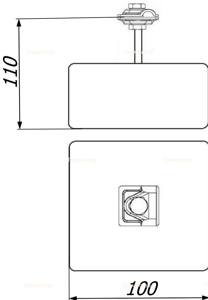
*Держатель проводника круглого с бетоном предназначен для прокладки прута  $\varnothing 6-\varnothing 10$  мм. на крышах с плоской кровлей. Высокая версия позволяет на проведение токоотвода на высоте на высшем расстоянии от крыши. Держатель можно приклеивать к крышам при помощи клея или клея для мембраны ПВХ. Используется для прута  $\varnothing 6-\varnothing 10$  мм. Подробности касающиеся способа приклеивания найдете на сайте.*
