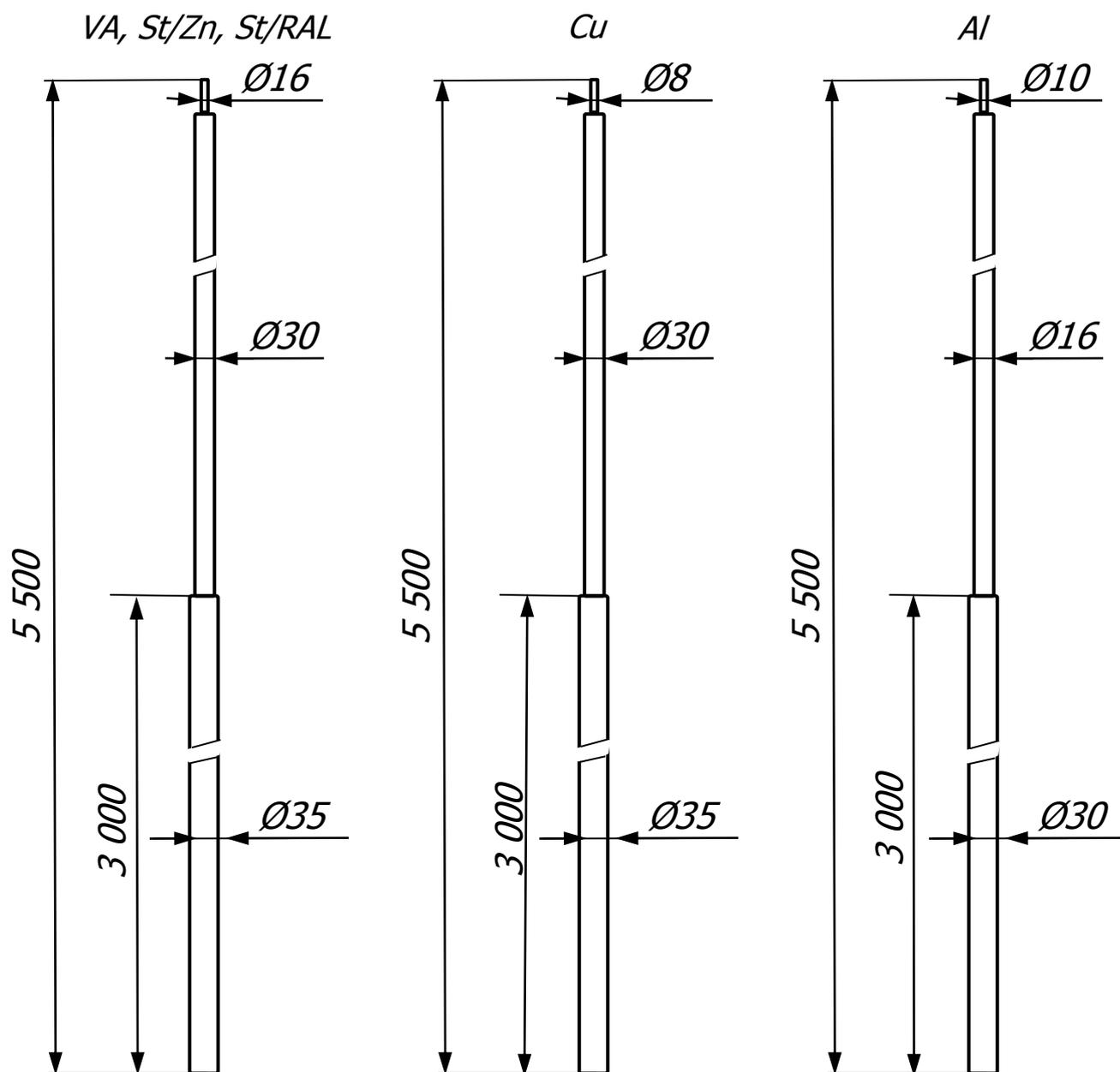
Молниеприёмная мачта 5,5 метров предназначен для молниезащиты элементов крыши, зданий, сооружений и т.д., которые согласно технике безопасности, должны быть защищены от попадания молнии. При установке надо использовать подходящие крепления для мачт, в зависимости от места их установки.
