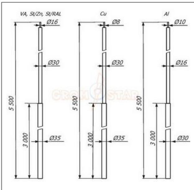
Молниеприёмная мачта 5,5 метров. выпускается из оцинкованной сталь St/Zn, меди Cu, нержавеющей стали VA, алюминия Al, окрашенной стали St/RAL с порошковой окраской в стандартные цвета кровельных материалов.
