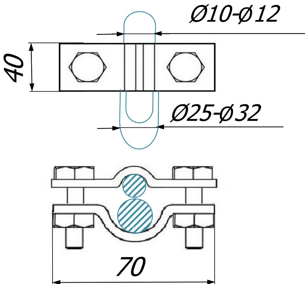
Соединитель круглого проводника Ø10 мм. - Ø12 мм. и молниеприемной мачты Ø25 мм. - Ø32 мм. с двумя болтами зажатия, размером 70x70 мм предназначен для соединения круглых и плоских проводников. Соединители выпускаются из различных материалов что дает возможность соединять круглые и плоские проводники, молниеприёмники и молниеприемной мачты. При помощи соединителя можно соединить проводник параллельно.
