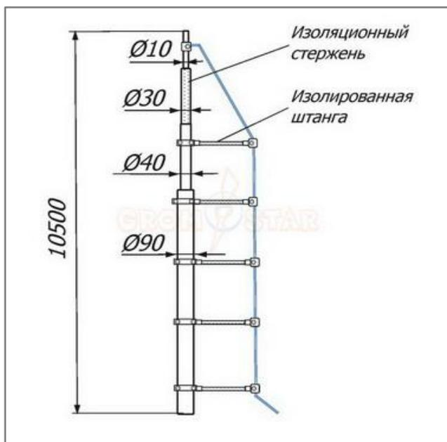
Изолированная молниеприёмная мачта 10,5 метров Громостар выпускается из оцинкованной сталь St/Zn, нержавеющей стали VA, алюминия Al. Изолированный от мачты токоотвод создает безопасное изоляционное расстояние между мачтой и токоотводом. Соответствует требованиям МЭК 50164 по молниеприемникам.
