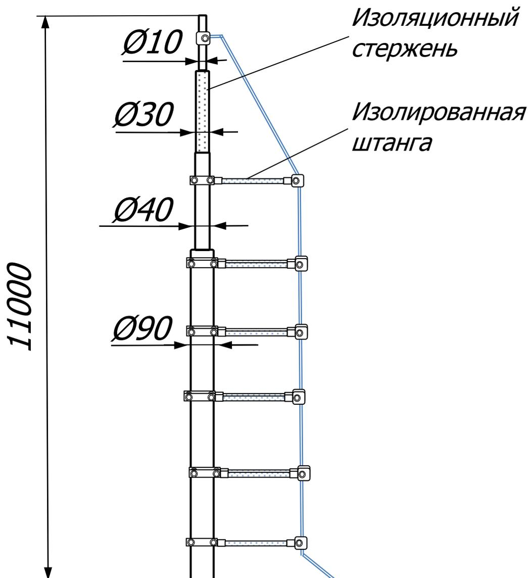
Изолированная молниеприёмная мачта 11 метров Громостар предназначен для защиты от ударов молнии элементов крыши или оборудования или конструкций, которые нельзя напрямую подсоединять к токоотводу, и для которых должно быть обеспечено изоляционное расстояние до токоотвода.
