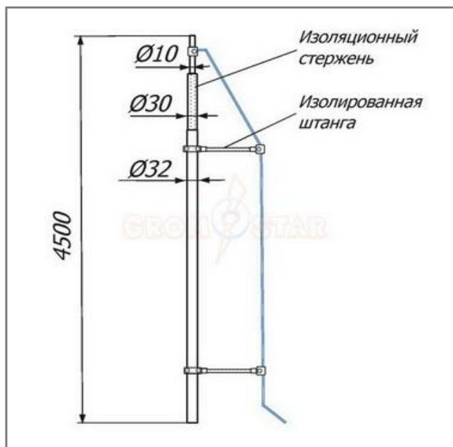
Изолированная молниеприёмная мачта 4,5 метра Громостар выпускается из оцинкованной сталь St/Zn, нержавеющей стали VA, алюминия Al. Изолированный от мачты токоотвод создает безопасное изоляционное расстояние между мачтой и токоотводом. Соответствует требованиям МЭК 50164 по молниеприемникам.
