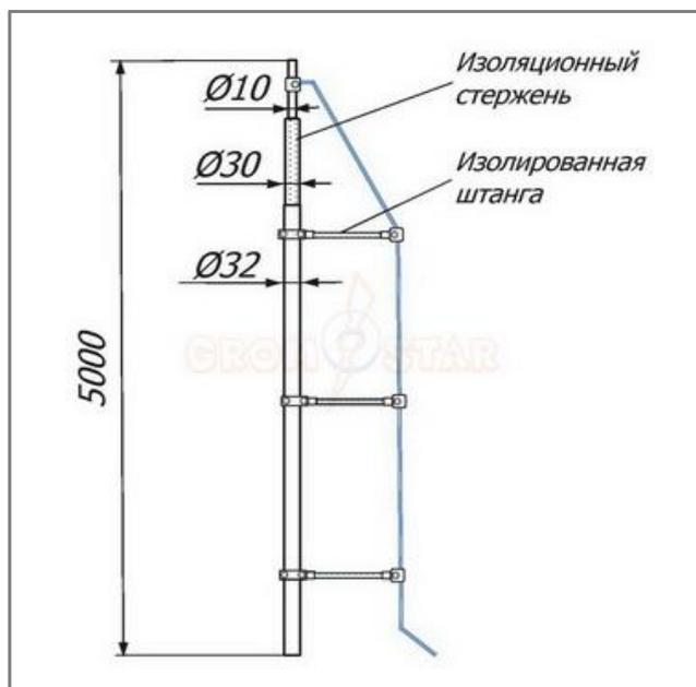
Изолированная молниеприёмная мачта 5 метров Громостар выпускается из оцинкованной сталь St/Zn, нержавеющей стали VA, алюминия Al. Изолированный от мачты токоотвод создает безопасное изоляционное расстояние между мачтой и токоотводом. Соответствует требованиям МЭК 50164 по молниеприемникам.
