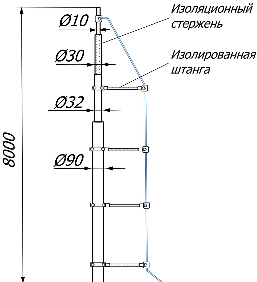
Изолированная молниеприёмная мачта 8 метров Громостар предназначен для защиты от ударов молнии элементов крыши или оборудования или конструкций, которые нельзя напрямую подсоединять к токоотводу, и для которых должно быть обеспечено изоляционное расстояние до токоотвода.
