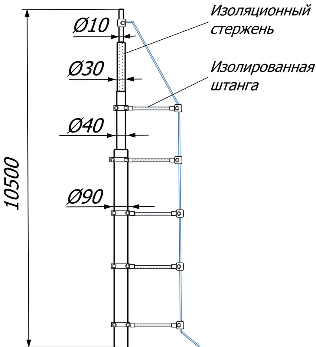
Изолированная молниеприёмная мачта 10,5 метров Громостар предназначен для защиты от ударов молнии элементов крыши или оборудования или конструкций, которые нельзя напрямую подсоединять к токоотводам, и для которых должно быть обеспечено изоляционное расстояние до токоотвода.
