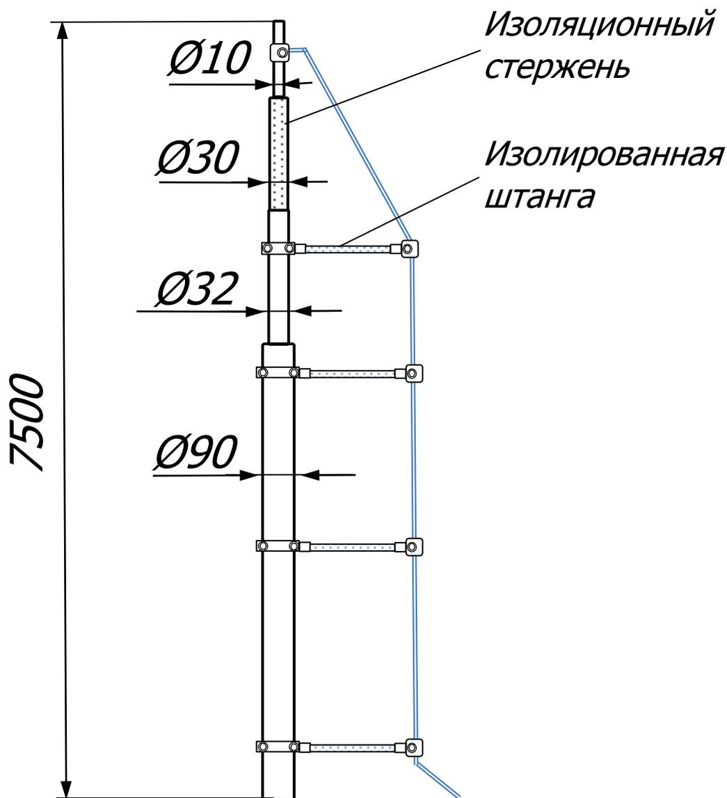
Изолированная молниеприёмная мачта 7,5 метров Громостар предназначен для защиты от ударов молнии элементов крыши или оборудования или конструкций, которые нельзя напрямую подсоединять к токоотводам, и для которых должно быть обеспечено изоляционное расстояние до токоотвода.
