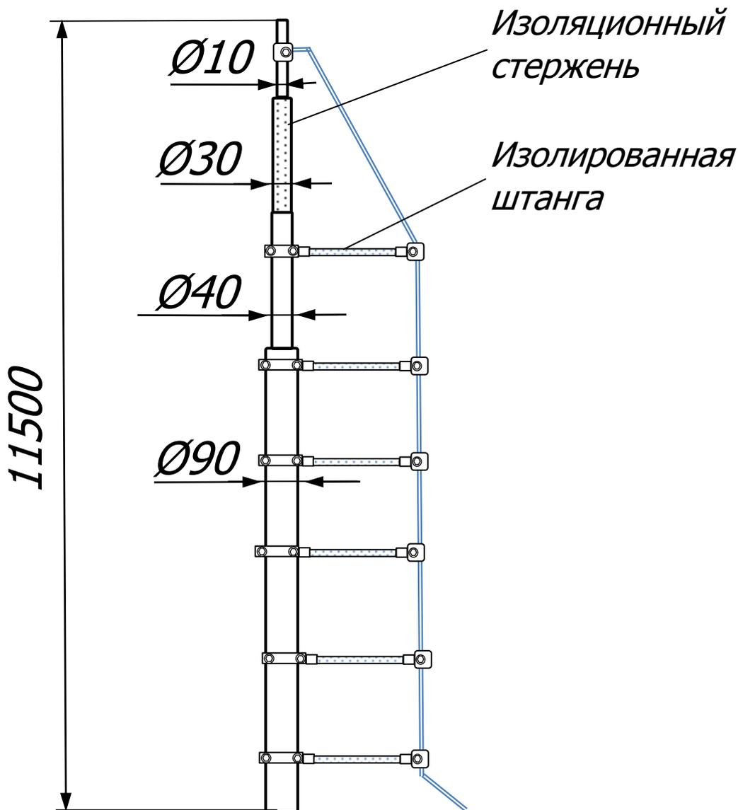
Изолированная молниеприёмная мачта 11,5 метров Громостар предназначен для защиты от ударов молнии элементов крыши или оборудования или конструкций, которые нельзя напрямую подсоединять к токоотводам, и для которых должно быть обеспечено изоляционное расстояние до токоотвода.
