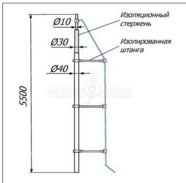
Изолированная молниеприёмная мачта 5,5 метров Громостар выпускается из оцинкованной сталь St/Zn, нержавеющей стали VA, алюминия Al. Изолированный от мачты токоотвод создает безопасное изоляционное расстояние между мачтой и токоотводом. Соответствует требованиям МЭК 50164 по молниеприемникам.
