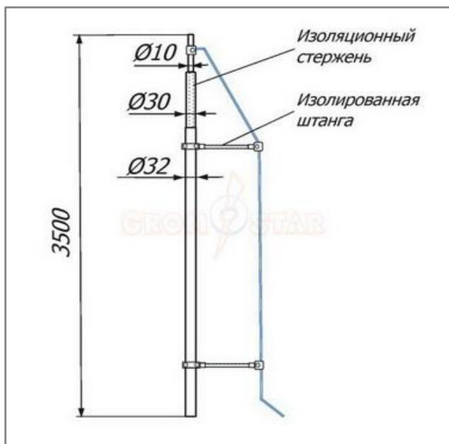
Изолированная молниеприёмная мачта 3,5 метра Громостар выпускается из оцинкованной сталь St/Zn, нержавеющей стали VA, алюминия Al. Изолированный от мачты токоотвод создает безопасное изоляционное расстояние между мачтой и токоотводом. Соответствует требованиям МЭК 50164 по молниеприемникам.
