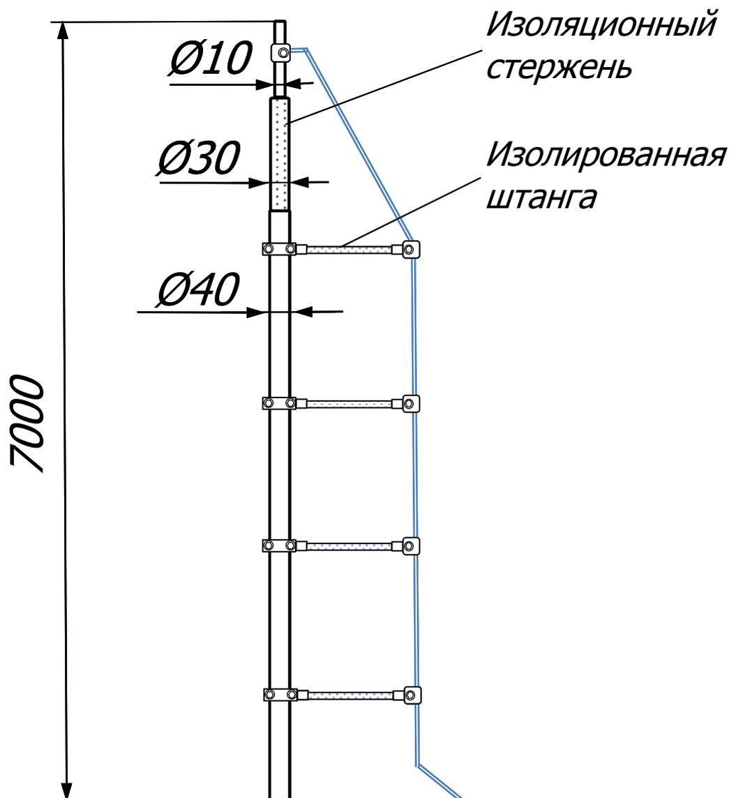
Изолированная молниеприёмная мачта 7 метров Громостар предназначен для защиты от ударов молнии элементов крыши или оборудования или конструкций, которые нельзя напрямую подсоединять к токоотводу, и для которых должно быть обеспечено изоляционное расстояние до токоотвода.
