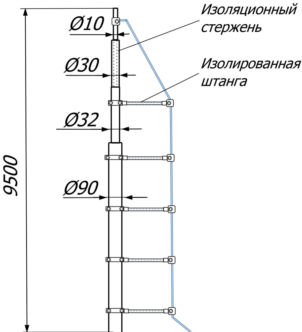
Изолированная молниеприёмная мачта 9,5 метров Громостар предназначен для защиты от ударов молнии элементов крыши или оборудования или конструкций, которые нельзя напрямую подсоединять к токоотводам, и для которых должно быть обеспечено изоляционное расстояние до токоотвода.
