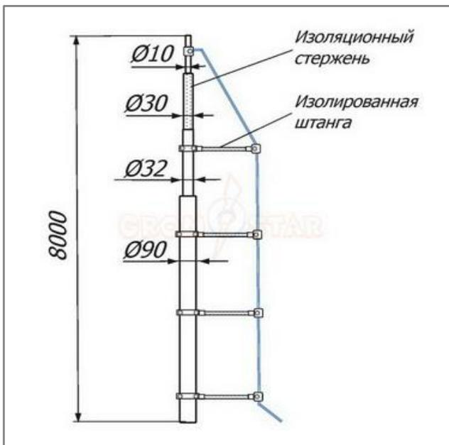
Изолированная молниеприёмная мачта 8 метров Громостар выпускается из оцинкованной сталь St/Zn, нержавеющей стали VA, алюминия Al. Изолированный от мачты токоотвод создает безопасное изоляционное расстояние между мачтой и токоотводом. Соответствует требованиям МЭК 50164 по молниеприемникам.
