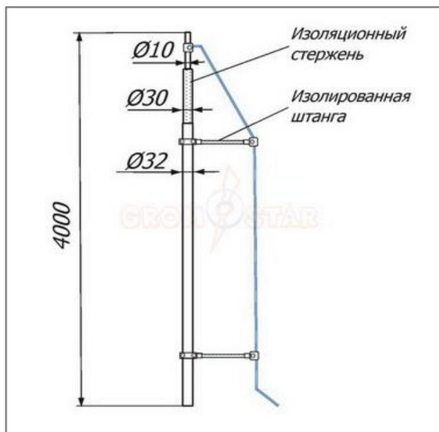
Изолированная молниеприёмная мачта 4 метра Громостар выпускается из оцинкованной сталь St/Zn, нержавеющей стали VA, алюминия Al. Изолированный от мачты токоотвод создает безопасное изоляционное расстояние между мачтой и токоотводом. Соответствует требованиям МЭК 50164 по молниеприемникам.
