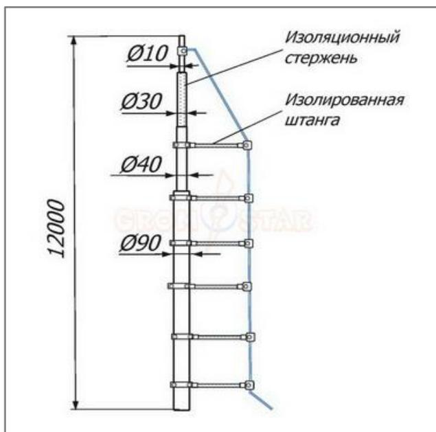
Изолированная молниеприёмная мачта 12 метров Громостар выпускается из оцинкованной сталь St/Zn, нержавеющей стали VA, алюминия Al. Изолированный от мачты токоотвод создает безопасное изоляционное расстояние между мачтой и токоотводом. Соответствует требованиям МЭК 50164 по молниеприемникам.
