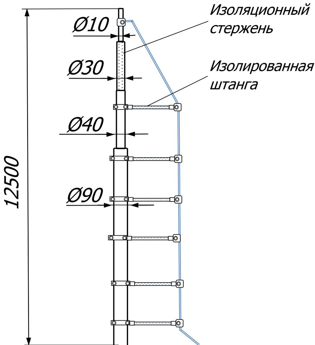
Изолированная молниеприёмная мачта 12,5 метров Громостар предназначен для защиты от ударов молнии элементов крыши или оборудования или конструкций, которые нельзя напрямую подсоединять к токоотводам, и для которых должно быть обеспечено изоляционное расстояние до токоотвода.
