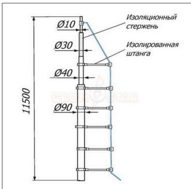
Изолированная молниеприёмная мачта 11,5 метров Громостар выпускается из оцинкованной сталь St/Zn, нержавеющей стали VA, алюминия Al. Изолированный от мачты токоотвод создает безопасное изоляционное расстояние между мачтой и токоотводом. Соответствует требованиям МЭК 50164 по молниеприемникам.
