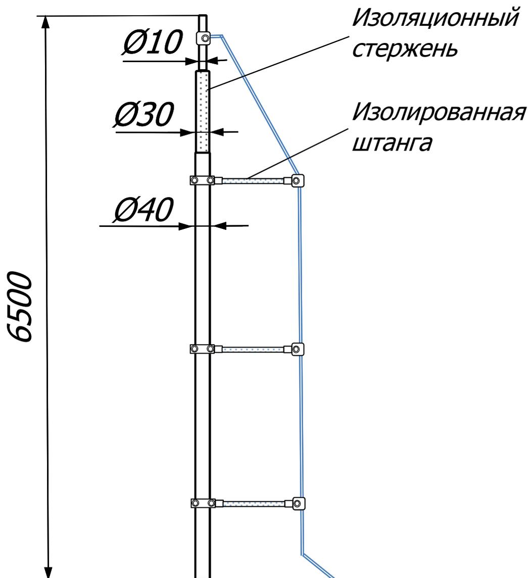
Изолированная молниеприёмная мачта 6,5 метров Громостар предназначен для защиты от ударов молнии элементов крыши или оборудования или конструкций, которые нельзя напрямую подсоединять к токоотводам, и для которых должно быть обеспечено изоляционное расстояние до токоотвода.
