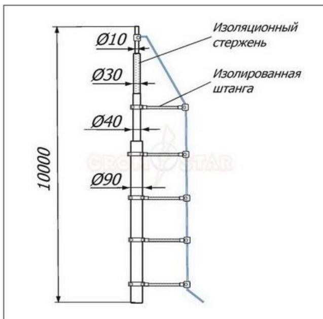
Изолированная молниеприёмная мачта 10 метров Громостар выпускается из оцинкованной сталь St/Zn, нержавеющей стали VA, алюминия Al. Изолированный от мачты токоотвод создает безопасное изоляционное расстояние между мачтой и токоотводом. Соответствует требованиям МЭК 50164 по молниеприемникам.
