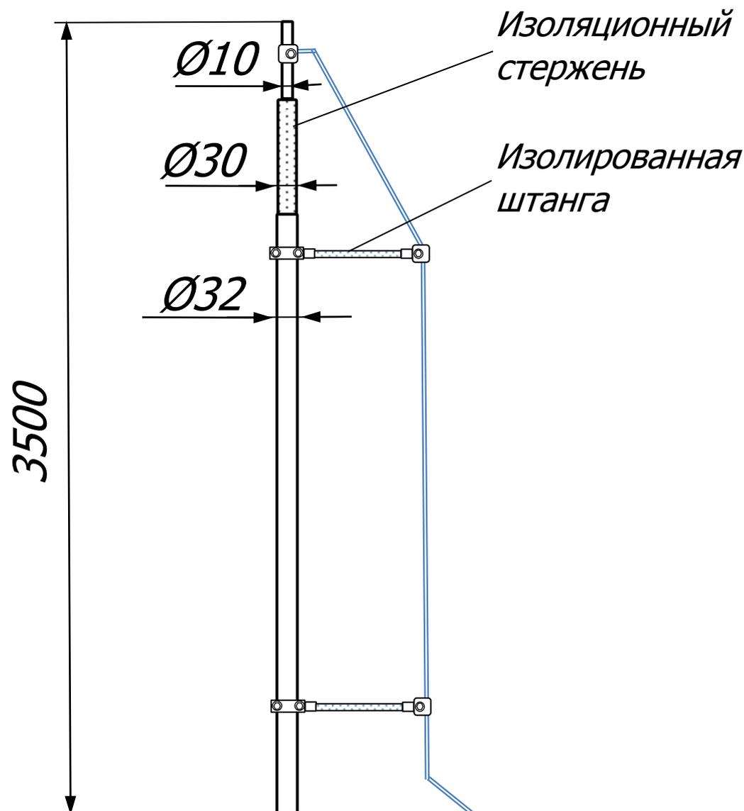
Изолированная молниеприёмная мачта 3,5 метра Громостар предназначен для защиты от ударов молнии элементов крыши или оборудования или конструкций, которые нельзя напрямую подсоединять к токоотводам, и для которых должно быть обеспечено изоляционное расстояние до токоотвода.
