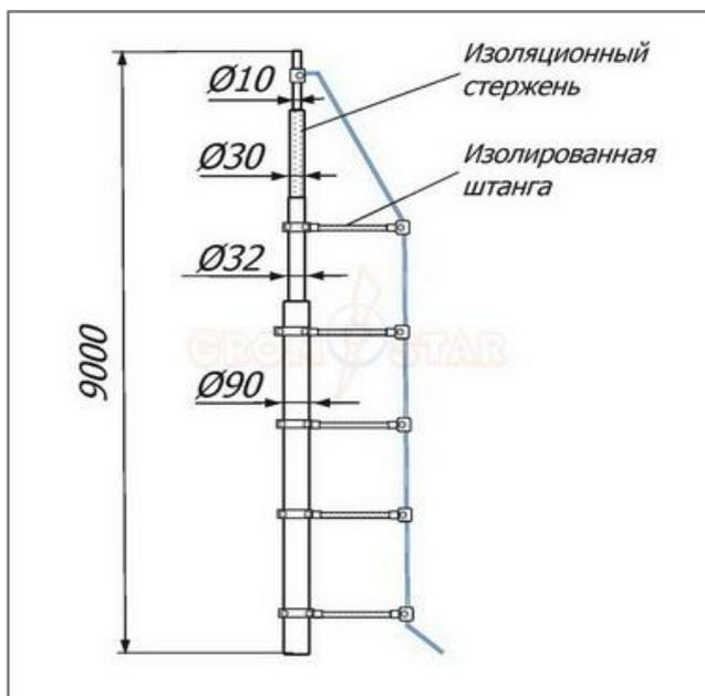
Изолированная молниеприёмная мачта 9 метров Громостар выпускается из оцинкованной сталь St/Zn, нержавеющей стали VA, алюминия Al. Изолированный от мачты токоотвод создает безопасное изоляционное расстояние между мачтой и токоотводом. Соответствует требованиям МЭК 50164 по молниеприемникам.
