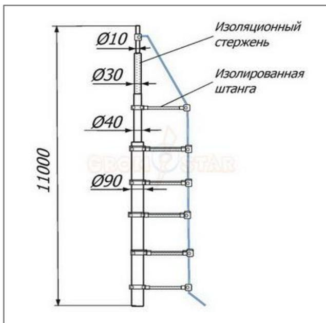
Изолированная молниеприёмная мачта 11 метров Громостар выпускается из оцинкованной сталь St/Zn, нержавеющей стали VA, алюминия Al. Изолированный от мачты токоотвод создает безопасное изоляционное расстояние между мачтой и токоотводом. Соответствует требованиям МЭК 50164 по молниеприемникам.
