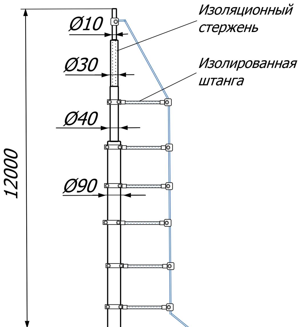
Изолированная молниеприёмная мачта 12 метров Громостар предназначен для защиты от ударов молнии элементов крыши или оборудования или конструкций, которые нельзя напрямую подсоединять к токоотводу, и для которых должно быть обеспечено изоляционное расстояние до токоотвода.
