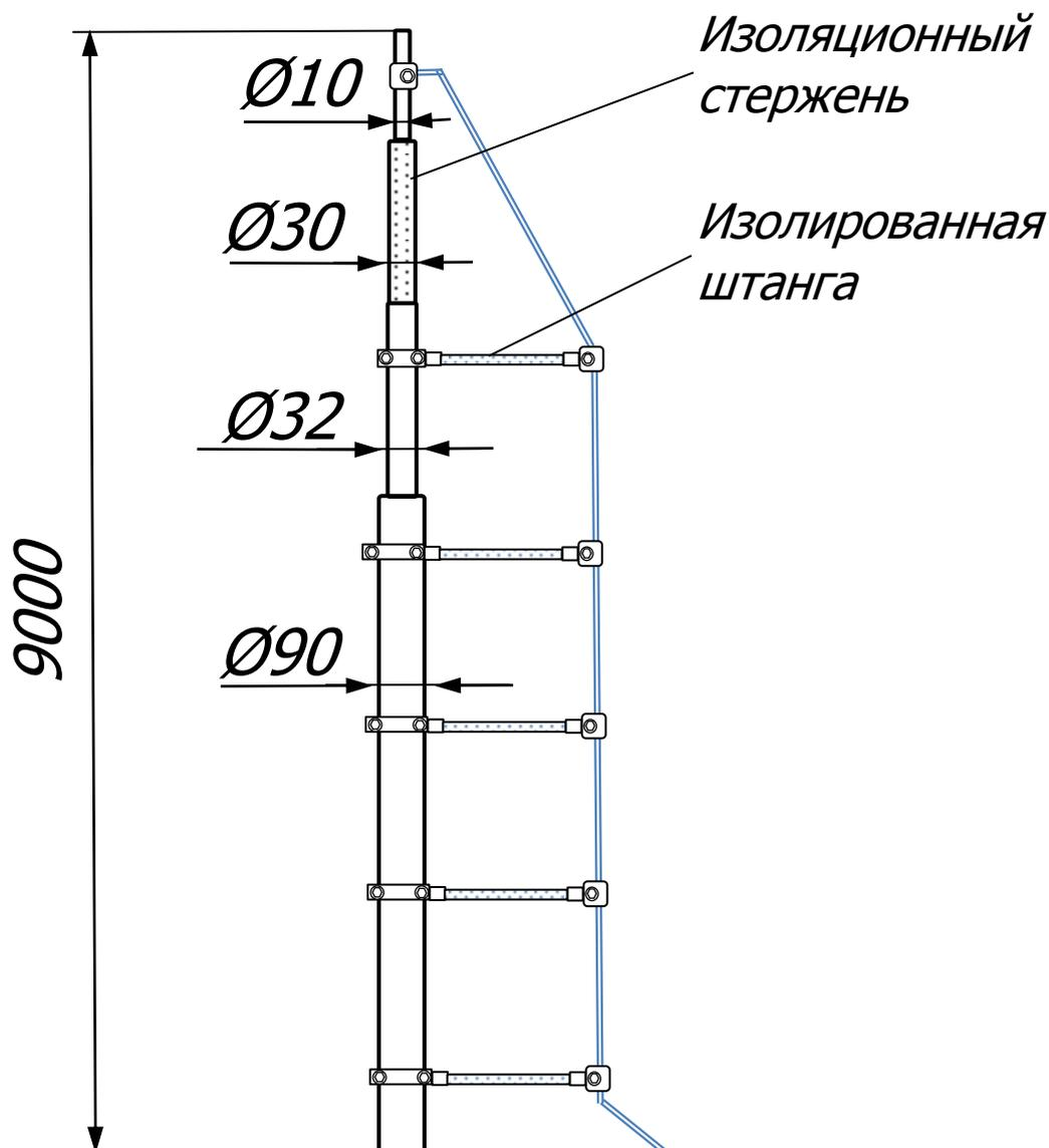
Изолированная молниеприёмная мачта 9 метров Громостар предназначен для защиты от ударов молнии элементов крыши или оборудования или конструкций, которые нельзя напрямую подсоединять к токоотводу, и для которых должно быть обеспечено изоляционное расстояние до токоотвода.
