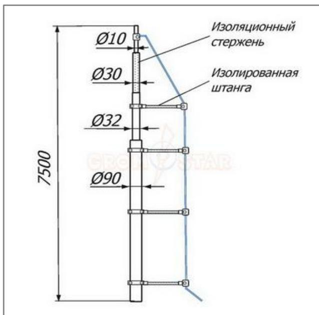
Изолированная молниеприёмная мачта 7,5 метров Громостар выпускается из оцинкованной сталь St/Zn, нержавеющей стали VA, алюминия Al. Изолированный от мачты токоотвод создает безопасное изоляционное расстояние между мачтой и токоотводом. Соответствует требованиям МЭК 50164 по молниеприемникам.
