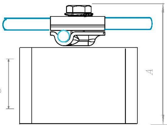
Держатель устанавливается на плоскую, инверсионную, ПВХ кровлю и держится на кровле под собственным весом. Дополнительно можно приклеить. На держателе имеется соединитель которым можно соединить проводник параллельно или перпендикулярно.
