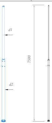
Молниеприёмная мачта для тросового молниеприёмника 7,5 метров Gromostar выпускается из оцинкованной сталь St/Zn, нержавеющей стали VA. Возможна окраска в стандартные цвета. Соответствует нормативным документам регламентирующими требования к молниезащите зданий: «Инструкция по молниезащите зданий и сооружений» РД 34.21.122-87 от 30 июля 1987 года и «Инструкция по устройству молниезащиты зданий, сооружений и промышленных коммуникаций» СО 153-343.21.122-2003 от 30 июня 2003 г
