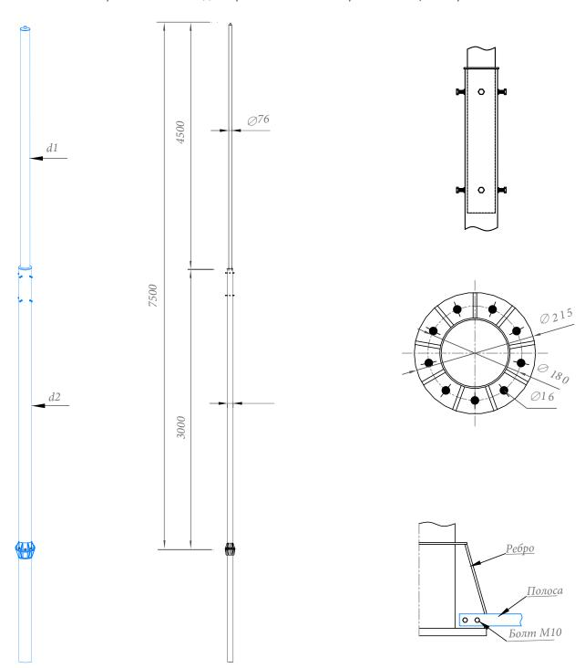
Молниеприёмная мачта для тросового молниеприёмника 7,5 метров Gromostar предназначен для установки на объекты при выполнении работ по молниезащите. В комлект входит: молниеприёмная мачта, закладная для установки мачты на грунт, соединитель. Подробности касающиеся способа установки и крепления найдете на сайте.
