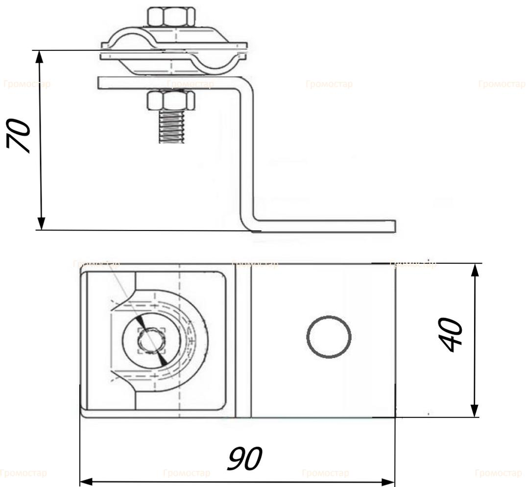
Держатель круглого проводника на трубы  $\text{Ø}30\text{-}\text{Ø}45$  мм. предназначена для закрепления токоотводов к трубопроводам или другим элементам конструкции. Гибкая и эластичная полоска из стали, адаптируется к различной форме, что позволяет установить систему молниезащиты на металлических конструкций различной форм. К обойме надо прикручивать непосредственно токоотвод.
