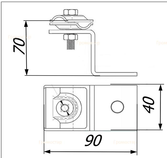
Держатель круглого проводника на трубы Ø30-Ø45 мм. для круглого проводника Ø6-Ø10 мм. Диаметр D=Ø30-Ø45 мм. Выпускается из оцинкованной стали, нержавеющей стали, окрашенной стали с порошковой окраской в цвета коричневый RAL8019, серебрянный RAL9006, серый RAL9007, терракотовый RAL8004, чёрный RAL9005, синий RAL5001, зелёный RAL6002, красный RAL3009.
