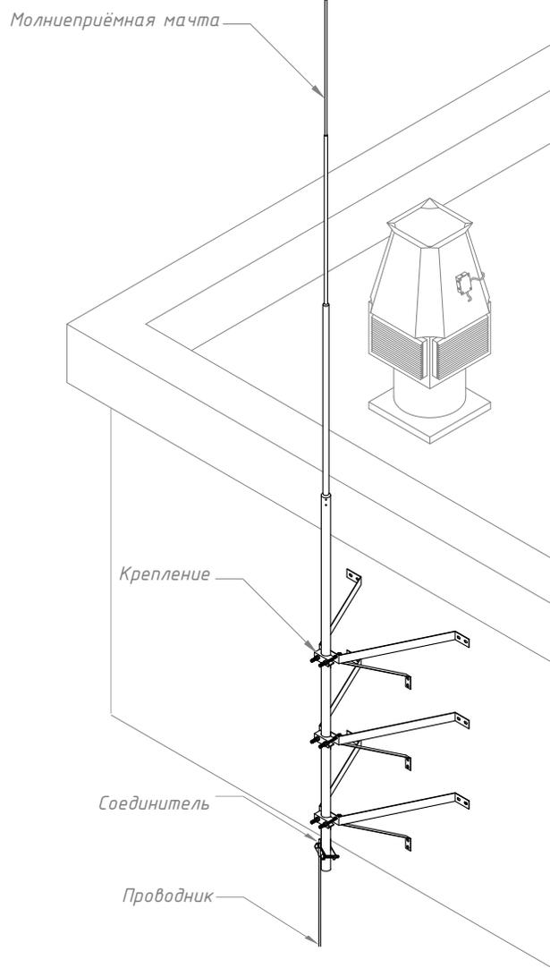
Молниеприёмная мачта с крепление на стену 7 м. Gromostar предназначен для установки на объекты при выполнении работ по молниезащите. Молниеприёмная мачта с крепление на стену имеет в комплекте: молниеприёмная мачта, набор креплений на стену, соединитель проводника и мачты. Молниеприёмная мачта с крепление на стену при правильных расчётах позволяет перехватывать молнии, тем самым защищать ваш объект. Подробности касающиеся способа установки и крепления найдете на сайте.
