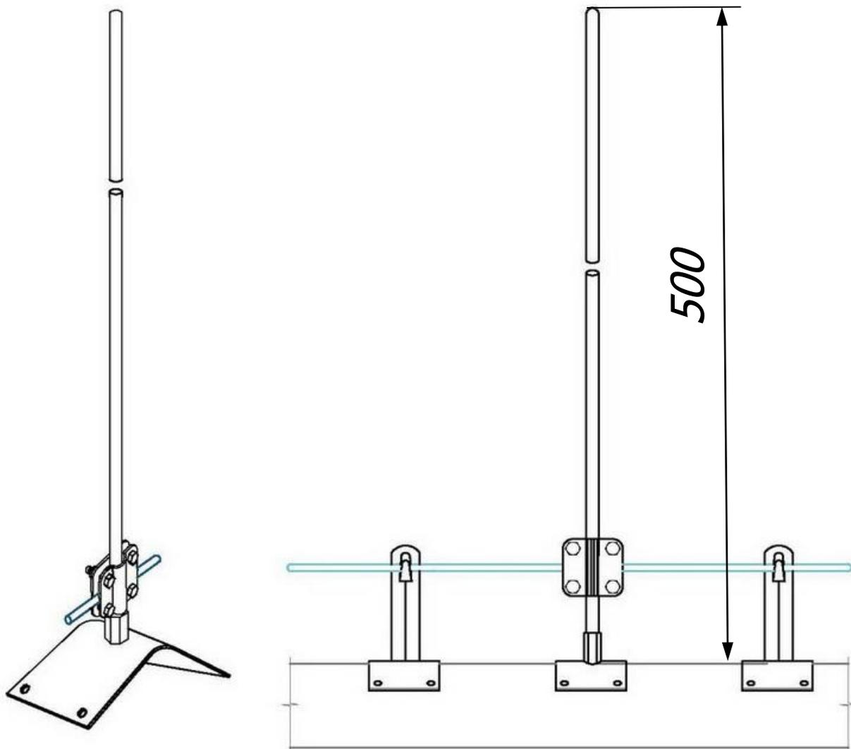
*Молниеприёмник на прямой конёк 0,5 метра предназначен для молниезащиты элементов крыши или устройств, которые, согласно технике безопасности, невозможно присоединить к токоотводам. Крепится на саморезы или заклёпки, на вершине крыши. Набор имеет соединитель для подключения молниеприемника к горизонтальному токоотводу на крыше. Выпускается из меди, алюминия, оцинкованной, нержавеющей и окрашенной стали, с порошковой окраской в стандартные цвета кровельных материалов.*
