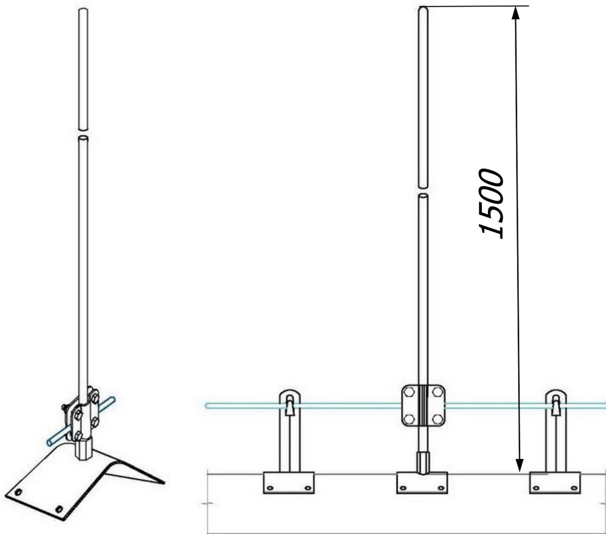
*Молниеприёмник на прямой конёк 1,5 метра предназначен для молниезащиты элементов крыши или устройств, которые, согласно технике безопасности, невозможно присоединить к токоотводам. Крепится на саморезы или заклёпки, на вершине крыши. Набор имеет соединитель для подключения молниеприемника к горизонтальному токоотводу на крыше. Выпускается из меди, алюминия, оцинкованной, нержавеющей и окрашенной стали, с порошковой окраской в стандартные цвета кровельных материалов.*
