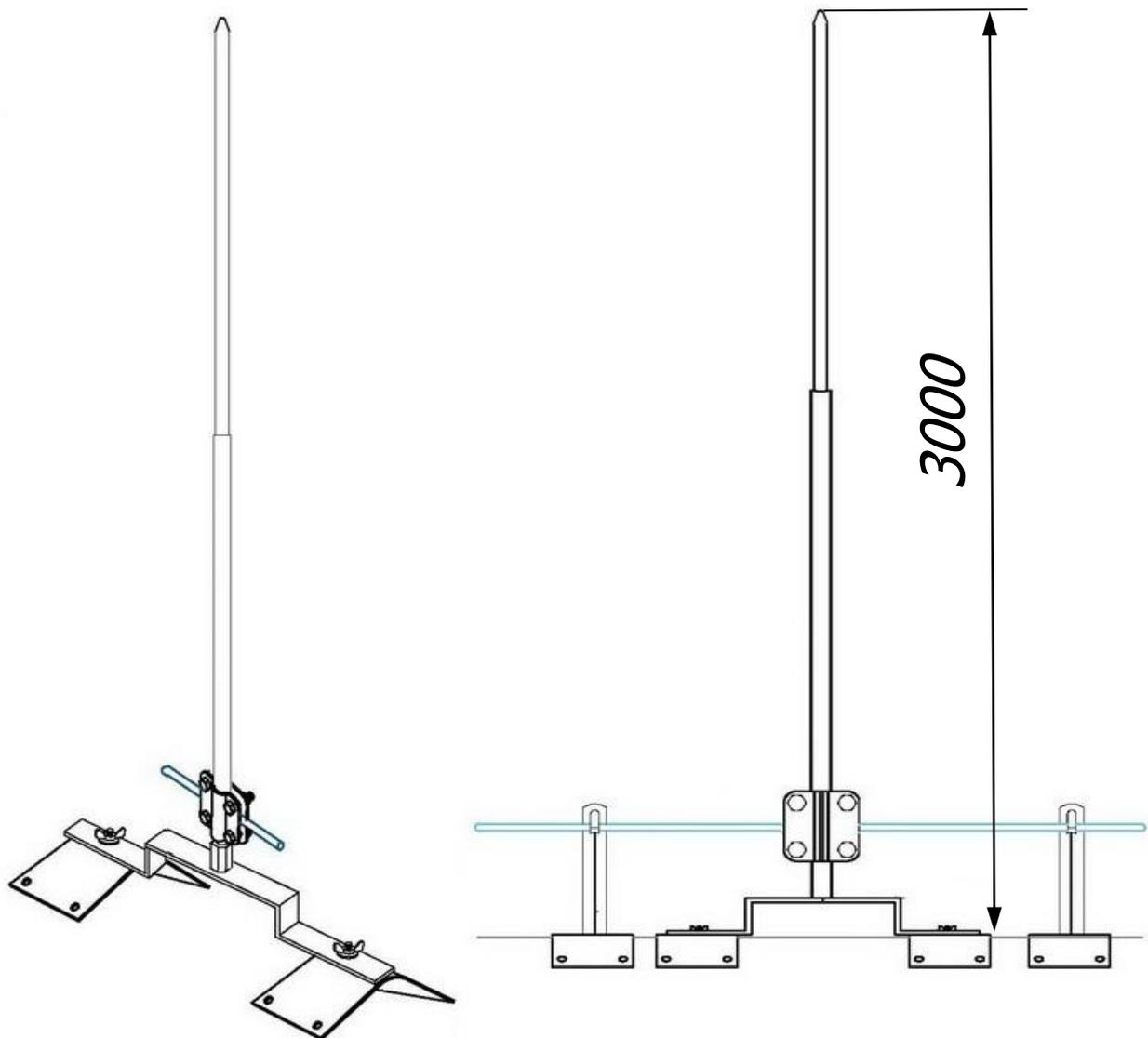
*Молниеприёмник на прямой конёк 3 метра предназначен для молниезащиты элементов крыши или устройств, которые, согласно технике безопасности, невозможно присоединить к токоотводам. Крепится на на коньковых зажимах, на вершине крыши. Набор имеет соединитель для подключения молниеприемника к горизонтальному токоотводу на крыше. Выпускается из меди, алюминия, оцинкованной, нержавеющей и окрашенной стали, с порошковой окраской в стандартные цвета кровельных материалов.*
