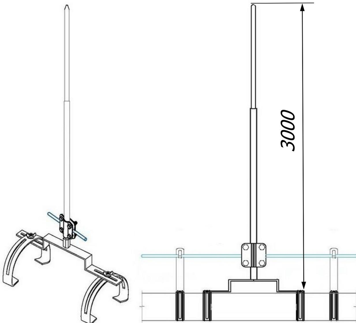
Молниеприёмник на круглый конёк 3 метра предназначен для молниезащиты элементов крыши или устройств, которые, согласно технике безопасности, невозможно присоединить к токоотводам. Крепится на коньковых зажимах, на вершине крыши. Набор имеет соединитель для подключения молниеприемника к горизонтальному токоотводу на крыше. Выпускается из меди, алюминия, оцинкованной, нержавеющей и окрашенной стали, с порошковой окраской в стандартные цвета кровельных материалов.
