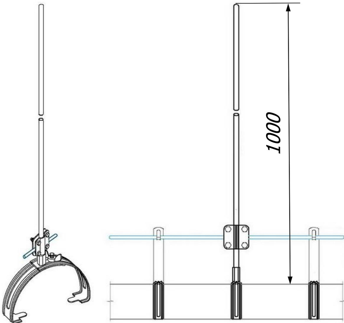
*Молниеприёмник на круглый конёк 1 метр предназначен для молниезащиты элементов крыши или устройств, которые, согласно технике безопасности, невозможно присоединить к токоотводам. Крепится на коньковых зажимах, на вершине крыши. Набор имеет соединитель для подключения молниеприемника к горизонтальному токоотводу на крыше. Выпускается из меди, алюминия, оцинкованной, нержавеющей и окрашенной стали, с порошковой окраской в стандартные цвета кровельных материалов.*
