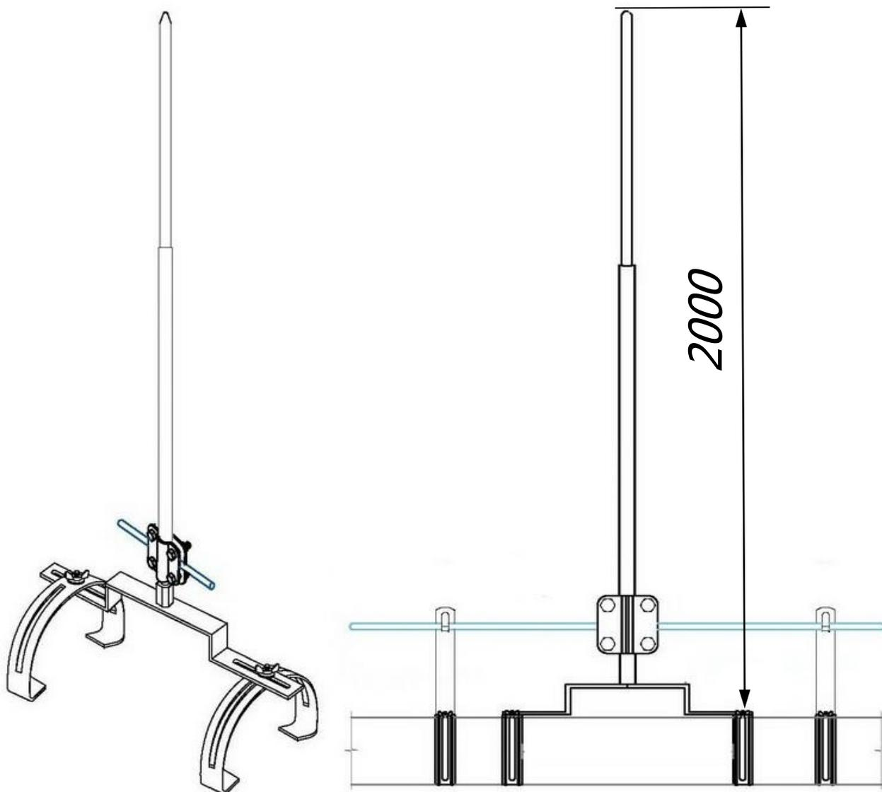
Молниеприёмник на круглый конёк 2 метра предназначен для молниезащиты элементов крыши или устройств, которые, согласно технике безопасности, невозможно присоединить к токоотводам. Крепится на коньковых зажимах, на вершине крыши. Набор имеет соединитель для подключения молниеприемника к горизонтальному токоотводу на крыше. Выпускается из меди, алюминия, оцинкованной, нержавеющей и окрашенной стали, с порошковой окраской в стандартные цвета кровельных материалов.
