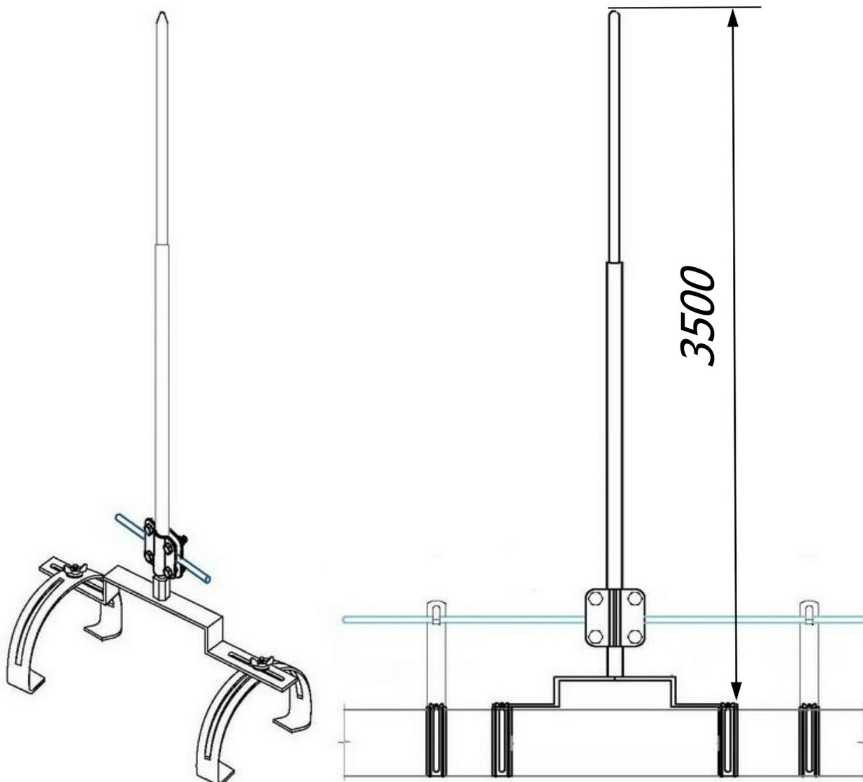
*Молниеприёмник на круглый конёк 3,5 метра предназначен для молниезащиты элементов крыши или устройств, которые, согласно технике безопасности, невозможно присоединить к токоотводам. Крепится на коньковых зажимах, на вершине крыши. Набор имеет соединитель для подключения молниеприемника к горизонтальному токоотводу на крыше. Выпускается из меди, алюминия, оцинкованной, нержавеющей и окрашенной стали, с порошковой окраской в стандартные цвета кровельных материалов.*
