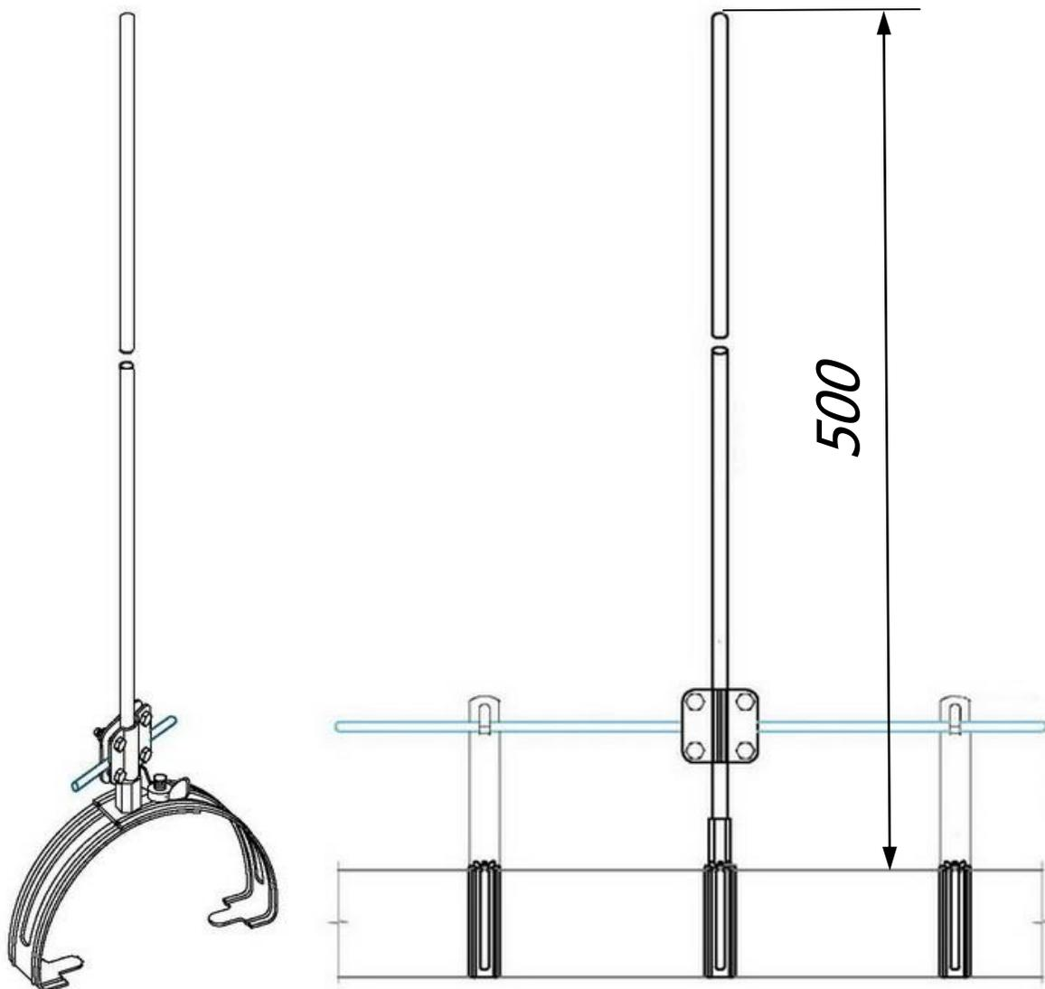
*Молниеприёмник на круглый конёк 0,5 метра предназначен для молниезащиты элементов крыши или устройств, которые, согласно технике безопасности, невозможно присоединить к токоотводам. Крепится на коньковых зажимах, на вершине крыши. Набор имеет соединитель для подключения молниеприемника к горизонтальному токоотводу на крыше. Выпускается из меди, алюминия, оцинкованной, нержавеющей и окрашенной стали, с порошковой окраской в стандартные цвета кровельных материалов.*
