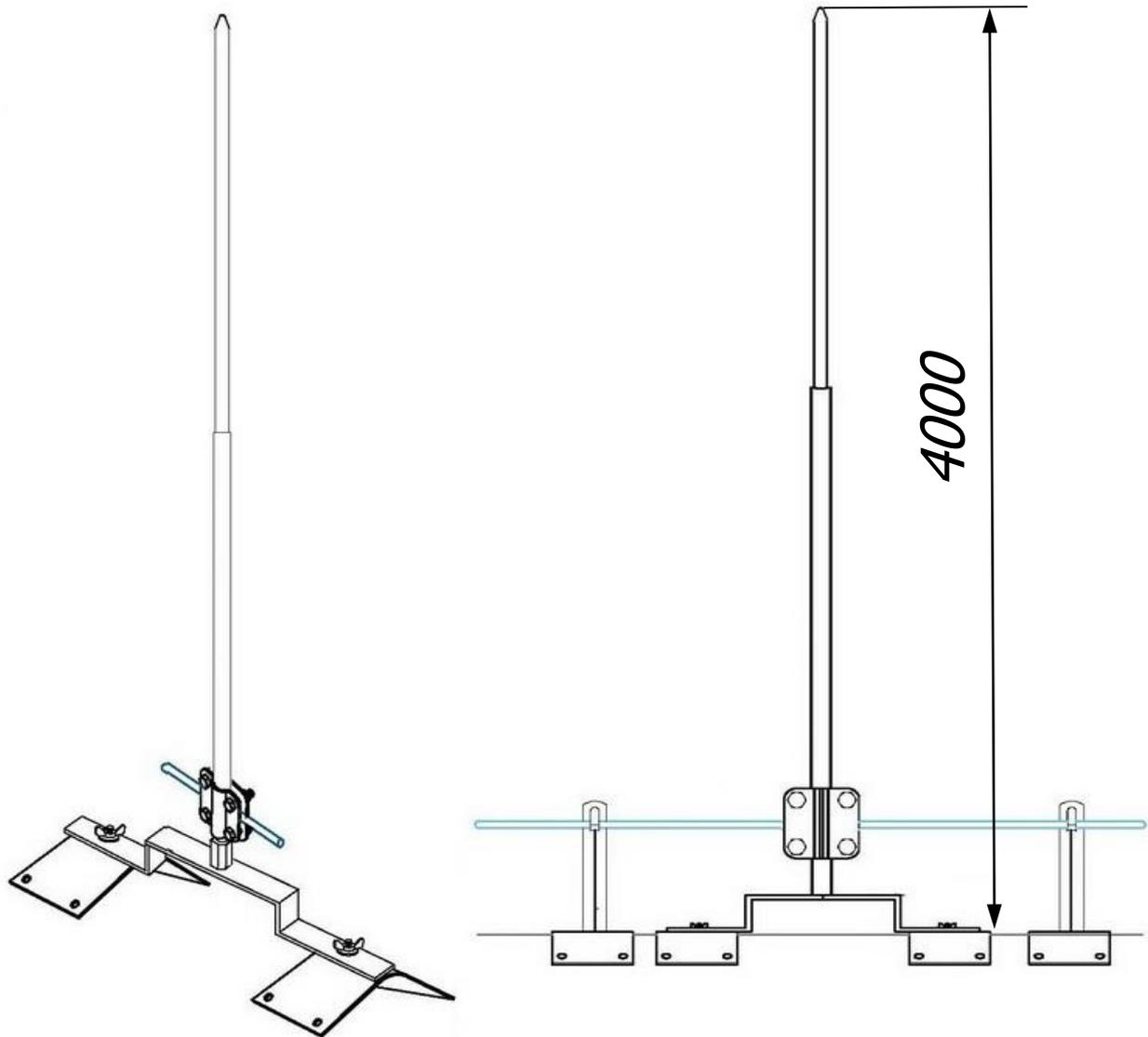
*Молниеприёмник на прямой конёк 4 метра предназначен для молниезащиты элементов крыши или устройств, которые, согласно технике безопасности, невозможно присоединить к токоотводам. Крепится на на коньковых зажимах, на вершине крыши. Набор имеет соединитель для подключения молниеприемника к горизонтальному токоотводу на крыше. Выпускается из меди, алюминия, оцинкованной, нержавеющей и окрашенной стали, с порошковой окраской в стандартные цвета кровельных материалов.*
