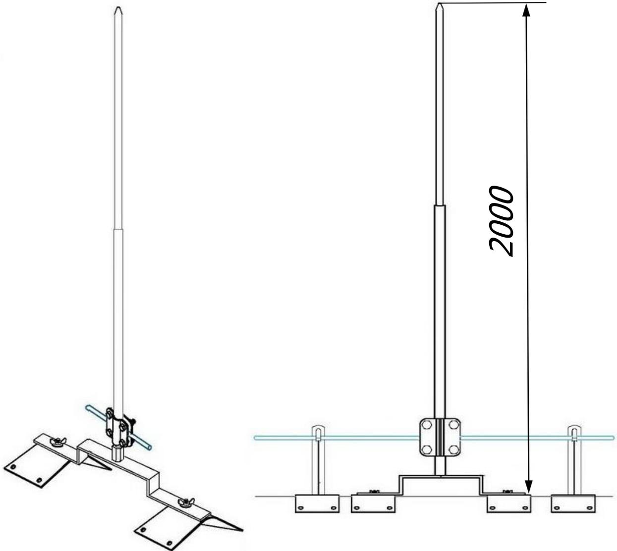
*Молниеприёмник на прямой конёк 2 метра предназначен для молниезащиты элементов крыши или устройств, которые, согласно технике безопасности, невозможно присоединить к токоотводам. Крепится на на коньковых зажимах, на вершине крыши. Набор имеет соединитель для подключения молниеприемника к горизонтальному токоотводу на крыше. Выпускается из меди, алюминия, оцинкованной, нержавеющей и окрашенной стали, с порошковой окраской в стандартные цвета кровельных материалов.*
