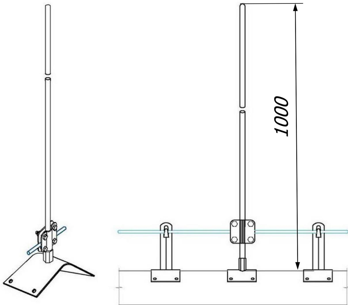
*Молниеприёмник на прямой конёк 1 метр предназначен для молниезащиты элементов крыши или устройств, которые, согласно технике безопасности, невозможно присоединить к токоотводам. Крепится на саморезы или заклёпки, на вершине крыши. Набор имеет соединитель для подключения молниеприемника к горизонтальному токоотводу на крыше. Выпускается из меди, алюминия, оцинкованной, нержавеющей и окрашенной стали, с порошковой окраской в стандартные цвета кровельных материалов.*
