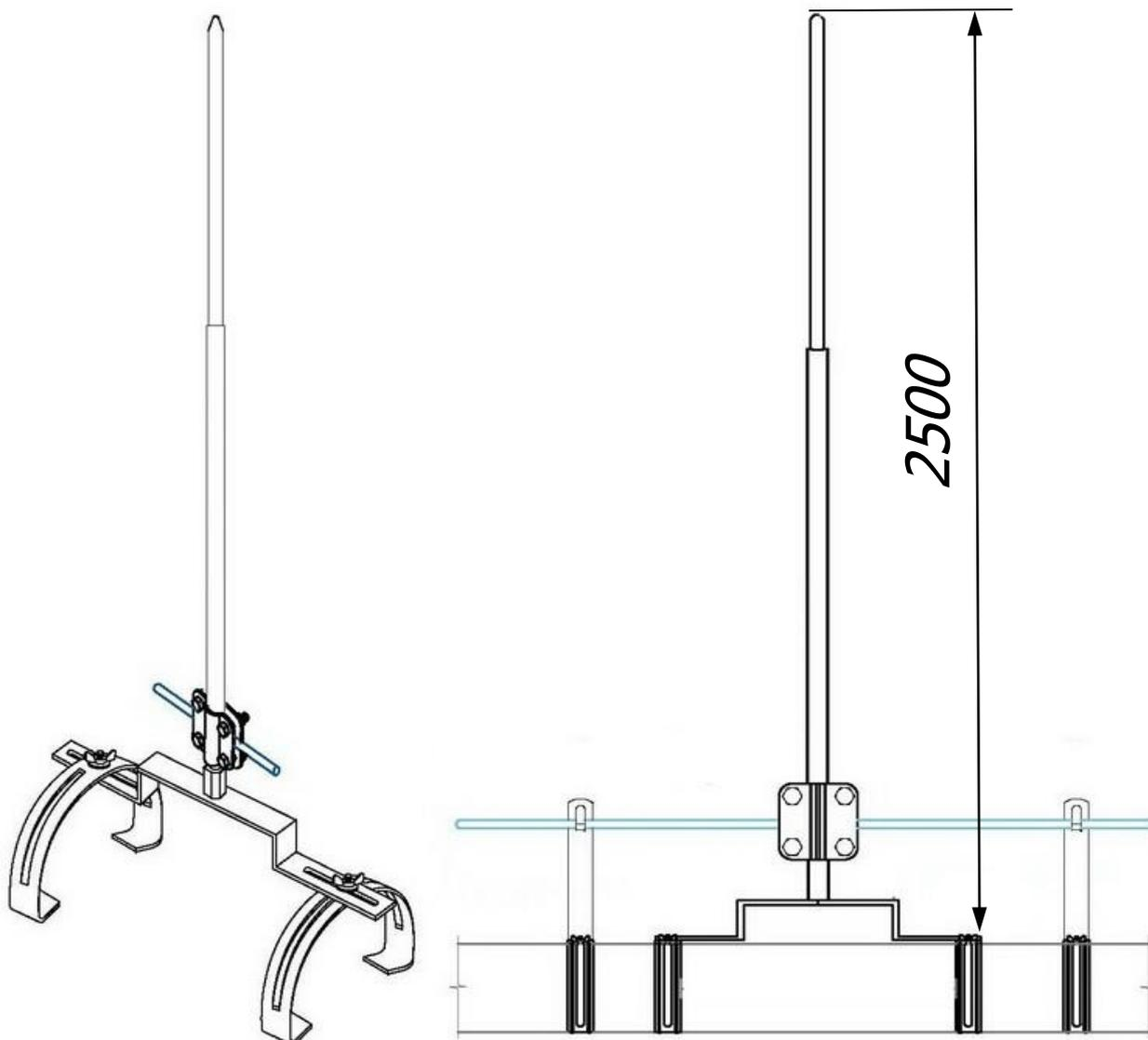
*Молниеприёмник на круглый конёк 2,5 метра предназначен для молниезащиты элементов крыши или устройств, которые, согласно технике безопасности, невозможно присоединить к токоотводам. Крепится на коньковых зажимах, на вершине крыши. Набор имеет соединитель для подключения молниеприемника к горизонтальному токоотводу на крыше. Выпускается из меди, алюминия, оцинкованной, нержавеющей и окрашенной стали, с порошковой окраской в стандартные цвета кровельных материалов.*
