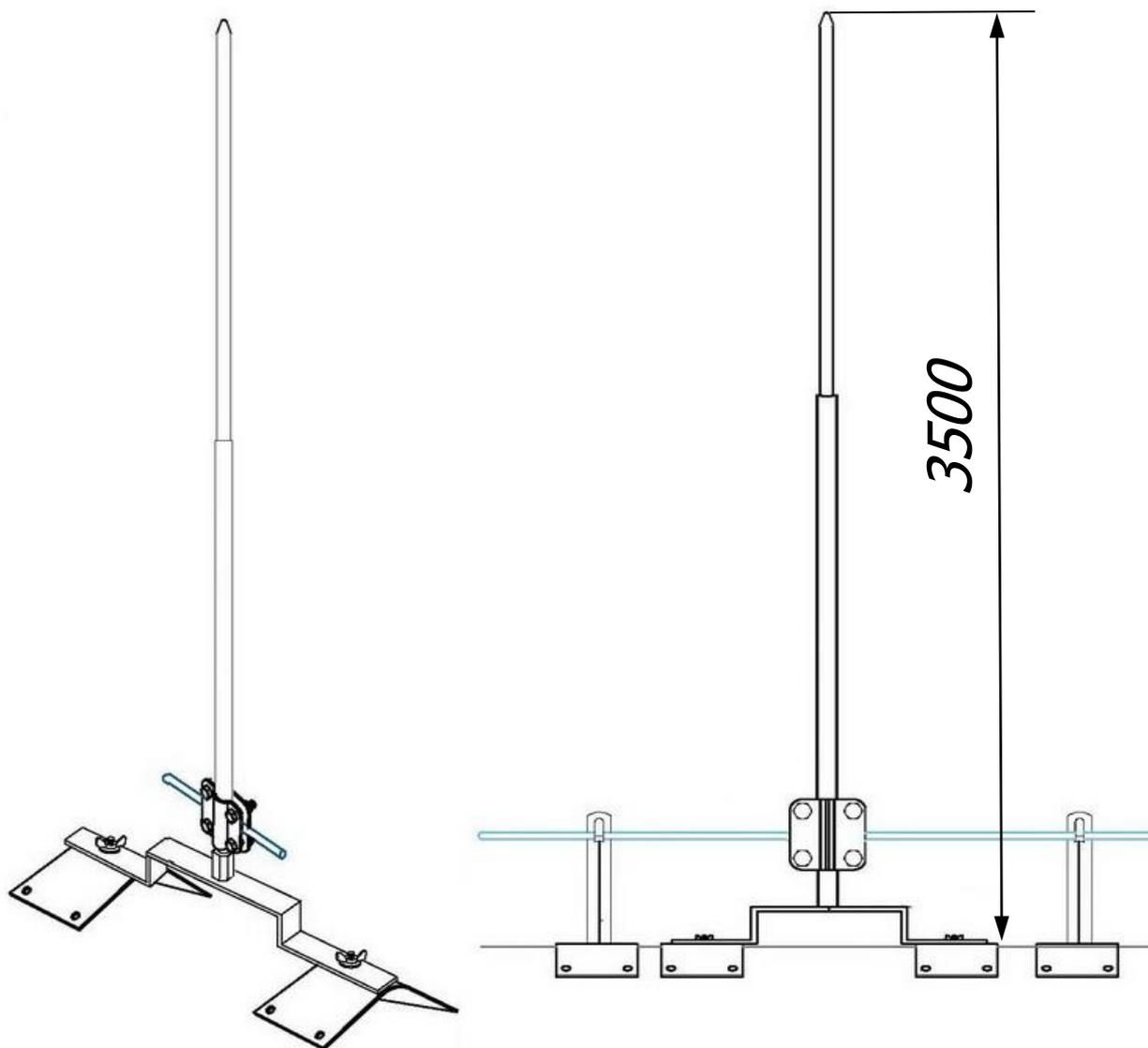
*Молниеприёмник на прямой конёк 3,5 метра предназначен для молниезащиты элементов крыши или устройств, которые, согласно технике безопасности, невозможно присоединить к токоотводам. Крепится на на коньковых зажимах, на вершине крыши. Набор имеет соединитель для подключения молниеприемника к горизонтальному токоотводу на крыше. Выпускается из меди, алюминия, оцинкованной, нержавеющей и окрашенной стали, с порошковой окраской в стандартные цвета кровельных материалов.*
