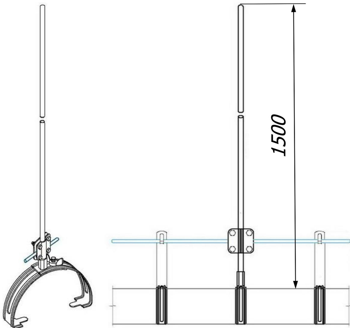
*Молниеприёмник на круглый конёк 1,5 метра предназначен для молниезащиты элементов крыши или устройств, которые, согласно технике безопасности, невозможно присоединить к токоотводам. Крепится на коньковых зажимах, на вершине крыши. Набор имеет соединитель для подключения молниеприемника к горизонтальному токоотводу на крыше. Выпускается из меди, алюминия, оцинкованной, нержавеющей и окрашенной стали, с порошковой окраской в стандартные цвета кровельных материалов.*
