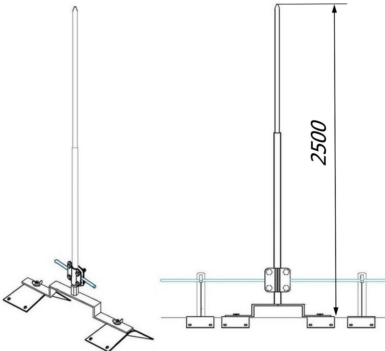
*Молниеприёмник на прямой конёк 2,5 метра предназначен для молниезащиты элементов крыши или устройств, которые, согласно технике безопасности, невозможно присоединить к токоотводам. Крепится на на коньковых зажимах, на вершине крыши. Набор имеет соединитель для подключения молниеприемника к горизонтальному токоотводу на крыше. Выпускается из меди, алюминия, оцинкованной, нержавеющей и окрашенной стали, с порошковой окраской в стандартные цвета кровельных материалов.*
