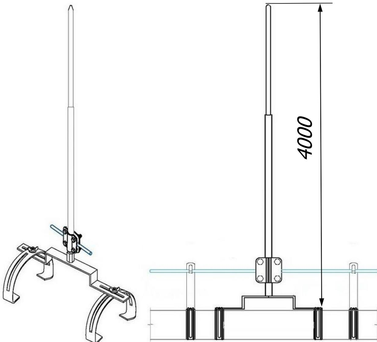
*Молниеприёмник на круглый конёк 4 метра предназначен для молниезащиты элементов крыши или устройств, которые, согласно технике безопасности, невозможно присоединить к токоотводам. Крепится на коньковых зажимах, на вершине крыши. Набор имеет соединитель для подключения молниеприемника к горизонтальному токоотводу на крыше. Выпускается из меди, алюминия, оцинкованной, нержавеющей и окрашенной стали, с порошковой окраской в стандартные цвета кровельных материалов.*
