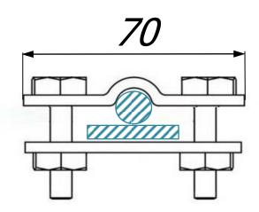
Соединитель плоского проводника и молниеприемной мачты Ø32 мм. - Ø40 мм. с двумя болтами зажатия, размером 70х70 мм предназначен для соединения круглых и плоских проводников. Соединители выпускаются из различных материалов что дает возмолность соединять круглые и плоские проводники, молниеприёмники и молниеприемные мачты всех видов. При помощи соединителя можно соединить проводник параллельно.
