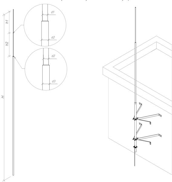
Мачта молниеприёмная с крепление на стену 5,5 м. Gromostar высотой 5,5 м., предназначен для установки на объекты при выполнении работ по молниезащите. Мачта молниеприёмная с крепление на стену имеет в комлекте: мачта молниеприёмная, набор креплений на стену, соединитель проводника и мачты. Мачта молниеприёмная с крепление на стену при правильных расчётах позволяет перехватывать молнии, тем самым защещать ваш объект. Подробности касающиеся способа установки и крепления найдете на сайте.
