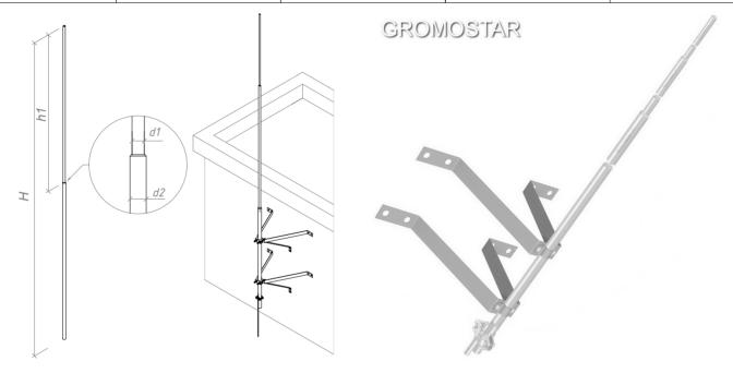
Мачта молниеприёмная с крепление на стену 5,5 м. Gromostar выпускается из оцинкованной сталь St/Zn, меди Cu, нержавеющей стали VA и алюминия Al. Возможна порошковая окраска в стандартные цвета. Соответствует нормативным документам регламентирующими требования к молниезащите зданий: «Инструкция по молниезащите зданий и сооружений» РД 34.21.122-87 от 30 июля 1987 года и «Инструкция по устройству молниезащиты зданий, сооружений и промышленных коммуникаций» CO 153-343.21.122-2003 от 30 июня 2003 г.
