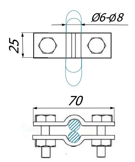
Соединитель круглого проводника Ø6 мм. - Ø8 мм. и круглого проводника Ø6 мм. - Ø8 мм. с двумя болтами зажатия, размером 70х70 мм предназначен для соединения круглого проводника Ø6 мм. - Ø8 мм. Соединители выпускаются из различных материалов что дает возмолность соединять круглые и плоские проводники. При помощи соединителя можно соединить проводник параллельно.
