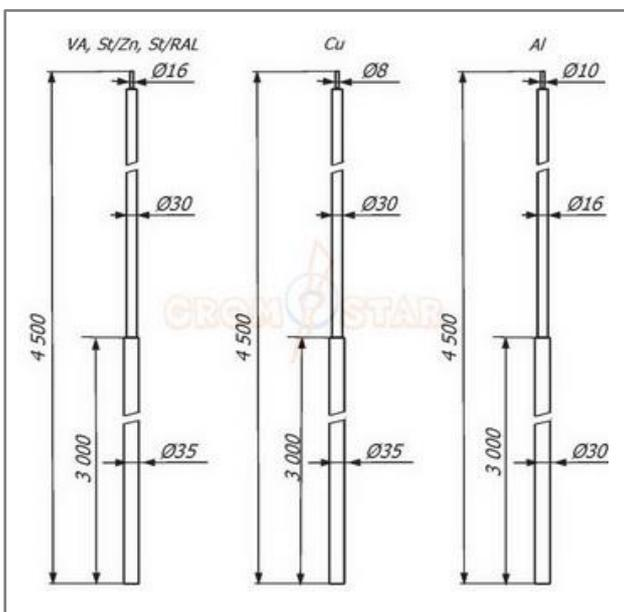
Стержневой молниеприёмник 4,5 метра выпускается из оцинкованной сталь St/Zn, меди Cu, нержавеющей стали VA, алюминия Al, окрашенной стали St/RAL с порошковой окраской в стандартные цвета кровельных материалов.
