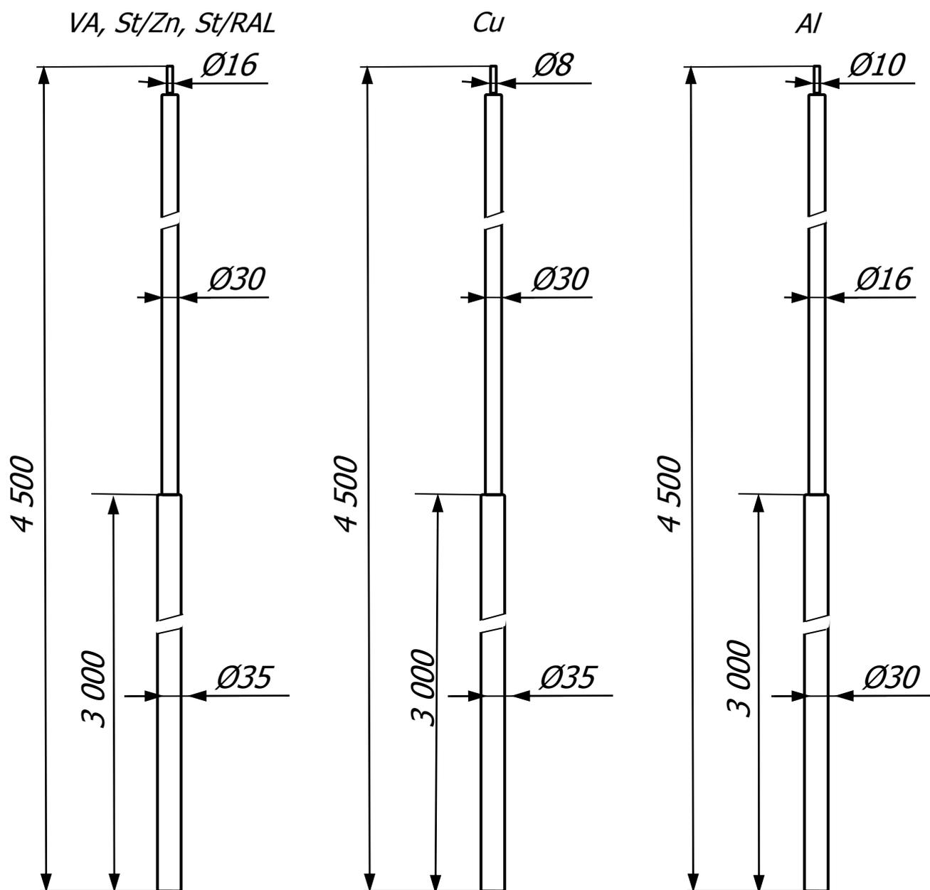
Стержневой молниеприёмник 4,5 метра предназначен для молниезащиты элементов крыши, зданий, сооружений и т.д., которые согласно технике безопасности, должны быть защищены от попадания молнии. При установке надо использовать подходящие крепления для мачт, в зависимости от места их установки.
