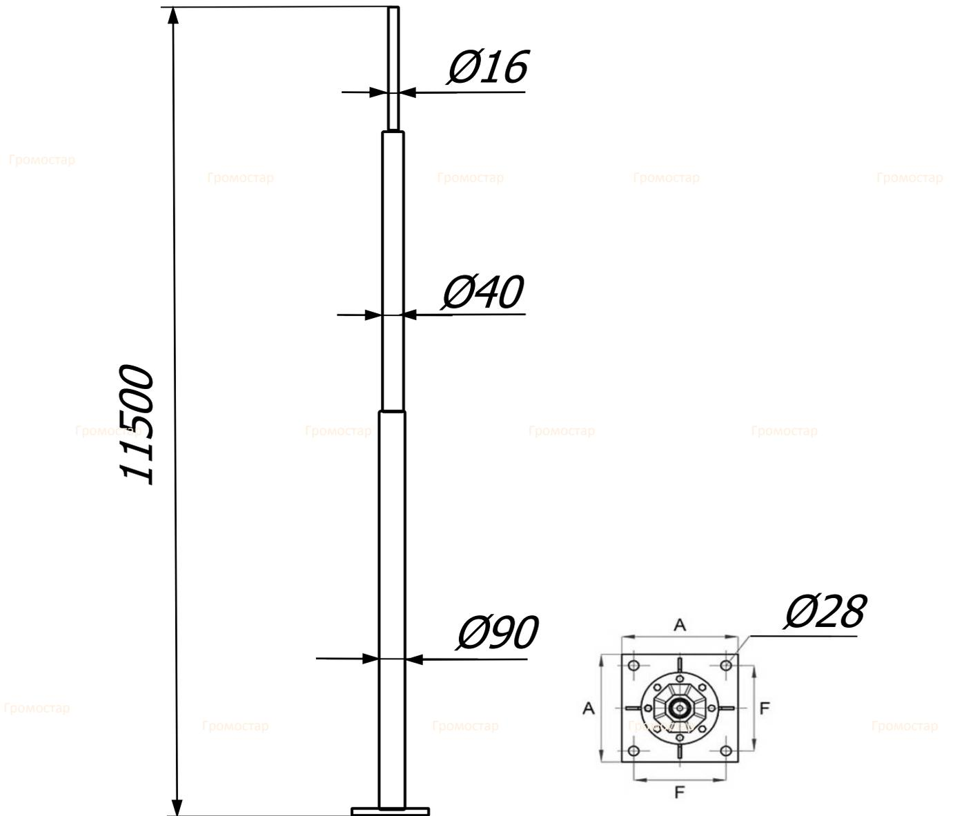
Отдельностоящая молниеприёмная мачта 11,5 метров Громостар предназначен для защиты от ударов молнии наружных установок, конструкций или других объектов, для которых необходимо использование системы молниезащиты. Сборная молниеприёмная мачта устанавливается на бетонный фундамент с анкерными закладными и закрепляется болтами.
