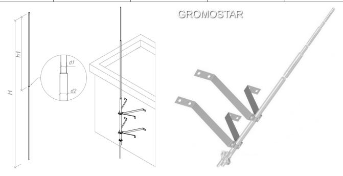
Мачта молниеприёмная с крепление на стену 6,5 м. Gromostar выпускается из оцинкованной сталь St/Zn, меди Cu, нержавеющей стали VA и алюминия Al. Возможна порошковая окраска в стандартные цвета. Соответствует нормативным документам регламентирующими требования к молниезащите зданий: «Инструкция по молниезащите зданий и сооружений» РД 34.21.122-87 от 30 июля 1987 года и «Инструкция по устройству молниезащиты зданий, сооружений и промышленных коммуникаций» CO 153-343.21.122-2003 от 30 июня 2003 г.
