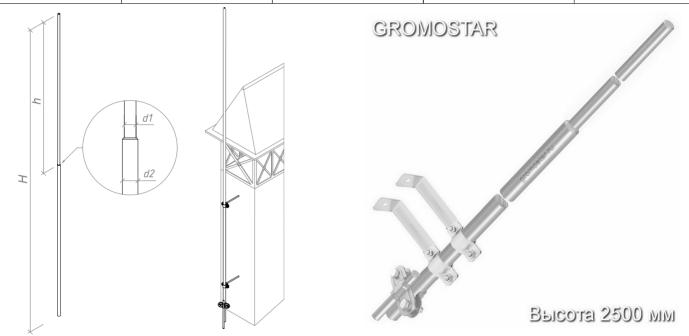
Молниеприёмник с крепление на стену 2,5 м. Gromostar выпускается из оцинкованной сталь St/Zn, меди Cu, нержавеющей стали VA и алюминия Al. Возможна порошковая окраска в стандартные цвета. Соответствует нормативным документам регламентирующими требования к молниезащите зданий: «Инструкция по молниезащите зданий и сооружений» РД 34.21.122-87 от 30 июля 1987 года и «Инструкция по устройству молниезащиты зданий, сооружений и промышленных коммуникаций» CO 153-343.21.122-2003 от 30 июня 2003 г.
