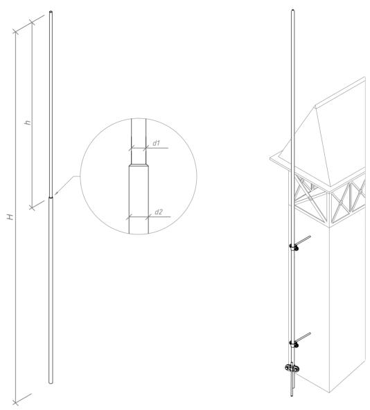
Молниеприёмник с крепление на стену 2,5 м. Gromostar предназначен для установки на объекты при выполнении работ по молниезащите. Молниеприёмник с крепление на стену имеет в комлекте: молниеприёмник, набор креплений на стену, соединитель проводника и молниеприёмника. Молниеприёмник с крепление на стену при правильных расчётах позволяет перехватывать молнии, тем самым защещать ваш объект. Подробности касающиеся способа установки и крепления найдете на сайте.
