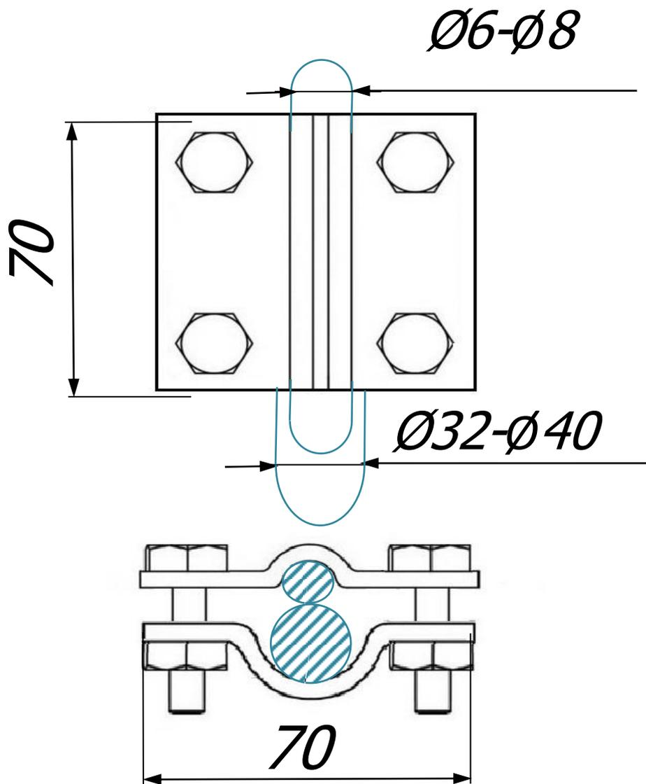
Соединитель круглого проводника  $\varnothing 6$  мм. -  $\varnothing 8$  мм. и молниеприемной мачты  $\varnothing 32$  мм. -  $\varnothing 40$  мм. с четырьмя болтами зажатия, размером 70x70 мм предназначен для соединения круглых и плоских проводников. Соединители выпускаются из различных материалов что дает возможность соединять круглые и плоские проводники, молниеприёмники и молниеприемной мачты. При помощи соединителя можно соединить проводник параллельно, перпендикулярно или T-образно.
