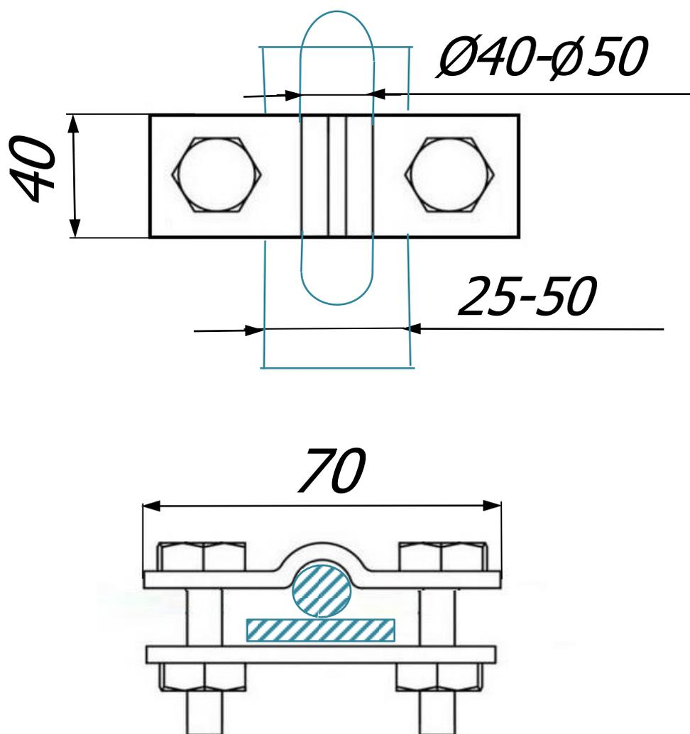
Соединитель плоского проводника и молниеприемной мачты Ø40 мм. - Ø50 мм. с двумя болтами зажатия, размером 70x70 мм предназначен для соединения круглых и плоских проводников. Соединители выпускаются из различных материалов что дает возможность соединять круглые и плоские проводники, молниеприёмники и молниеприемные мачты всех видов. При помощи соединителя можно соединить проводник параллельно.
