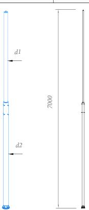
Молниеприёмная мачта для тросового молниеприёмника 7 метров Gromostar выпускается из оцинкованной сталь St/Zn, нержавеющей стали VA. Возможна окраска в стандартные цвета. Соответствует нормативным документам регламентирующими требования к молниезащите зданий: «Инструкция по молниезащите зданий и сооружений» РД 34.21.122-87 от 30 июля 1987 года и «Инструкция по устройству молниезащиты зданий, сооружений и промышленных коммуникаций» CO 153-343.21.122-2003 от 30 июня 2003 г
