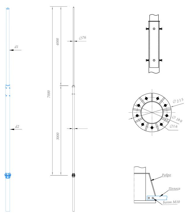
Молниеприёмная мачта для тросового молниеприёмника 7 метров Gromostar предназначен для установки на объекты при выполнении работ по молниезащите. В комлект входит: молниеприёмная мачта, закладная для установки мачты на грунт, соединитель. Подробности касающиеся способа установки и крепления найдете на сайте.
