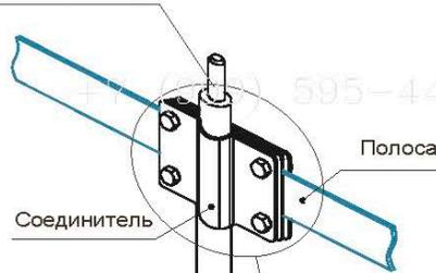
Обмотать место присоединения стержня и полосы антикоррозийной лентой
