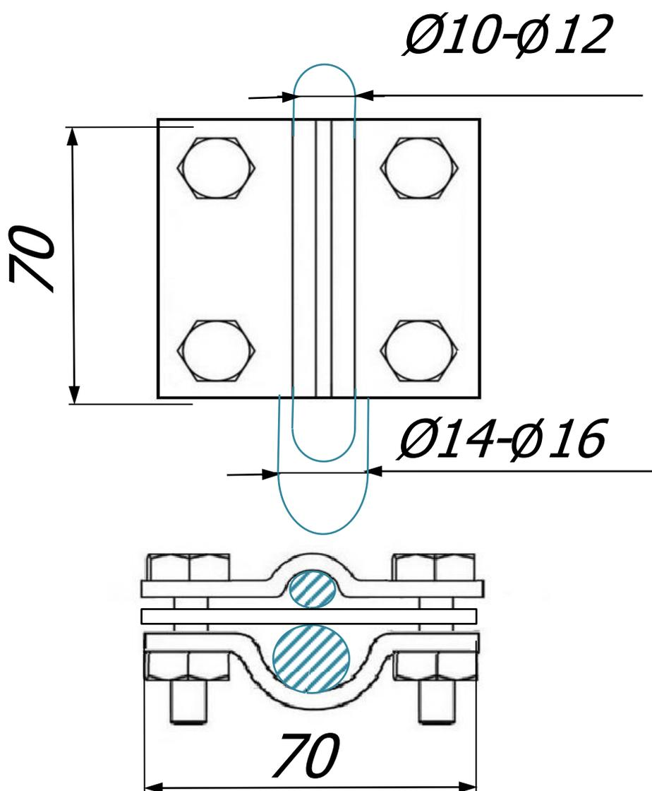
Соединитель круглого проводника Ø10 мм. - Ø12 мм. и прута Ø14 мм. - Ø16 мм. с четырьмя болтами зажатия и разделительной пластиной, размером 70x70 мм предназначен для соединения круглых и плоских проводников. Соединители выпускаются из различных материалов что дает возможность соединять круглые и плоские проводники, молниеприёмники и стержней заземления всех видов. При помощи соединителя можно соединить проводник параллельно, перпендикулярно или Т-образно.
