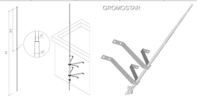
Мачта молниеприёмная с крепление на стену 4,5 м. Gromostar выпускается из оцинкованной сталь St/Zn, меди Cu, нержавеющей стали VA и алюминия Al. Возможна порошковая окраска в стандартные цвета. Соответствует нормативным документам регламентирующими требования к молниезащите зданий: «Инструкция по молниезащите зданий и сооружений» РД 34.21.122-87 от 30 июля 1987 года и «Инструкция по устройству молниезащиты зданий, сооружений и промышленных коммуникаций» CO 153-343.21.122-2003 от 30 июня 2003 г.
