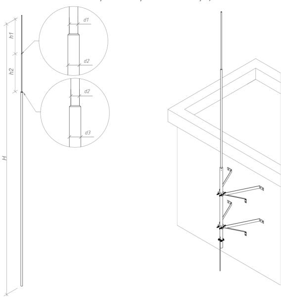
Мачта молниеприёмная с крепление на стену 4,5 м. Gromostar предназначен для установки на объекты при выполнении работ по молниезащите. Мачта молниеприёмная с крепление на стену имеет в комлекте: мачта молниеприёмная, набор креплений на стену, соединитель проводника и мачты. Мачта молниеприёмная с крепление на стену при правильных расчётах позволяет перехватывать молнии, тем самым защещать ваш объект. Подробности касающиеся способа установки и крепления найдете на сайте.
