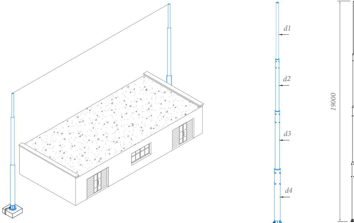
Молниеприёмная мачта для тросового молниеприёмника 19 метров Gromostar выпускается из оцинкованной сталь St/Zn, нержавеющей стали VA. Возможна окраска в стандартные цвета. Соответствует нормативным документам регламентирующими требования к молниезащите зданий: «Инструкция по молниезащите зданий и сооружений» РД 34.21.122-87 от 30 июля 1987 года и «Инструкция по устройству молниезащиты зданий, сооружений и промышленных коммуникаций» СО 153-343.21.122-2003 от 30 июня 2003 г
