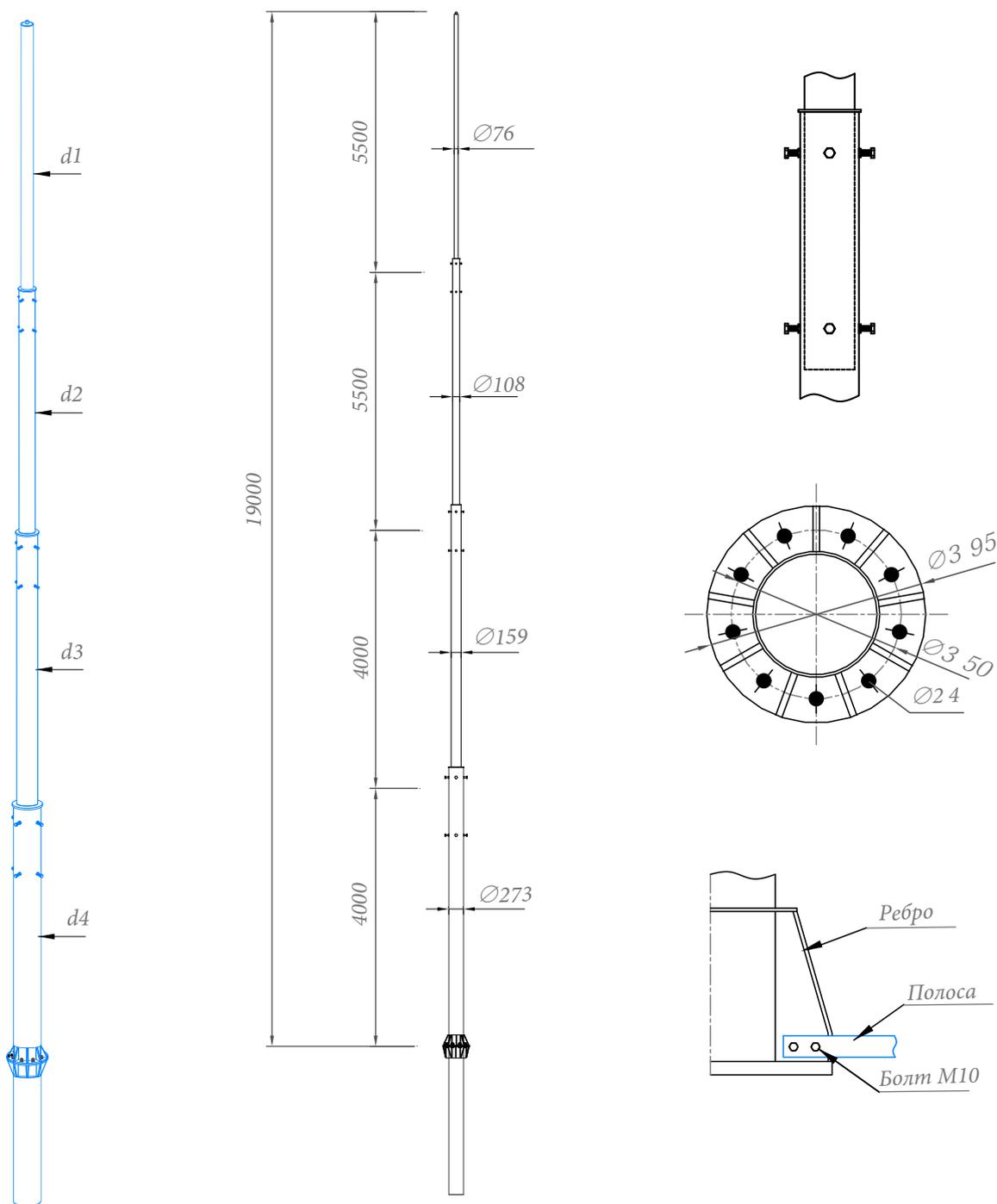
Молниеприёмная мачта для тросового молниеприёмника 19 метров Gromostar предназначен для установки на объекты при выполнении работ по молниезащите. В комплект входит: молниеприёмная мачта, закладная для установки мачты на грунт, соединитель. Подробности касающиеся способа установки и крепления найдете на сайте.
