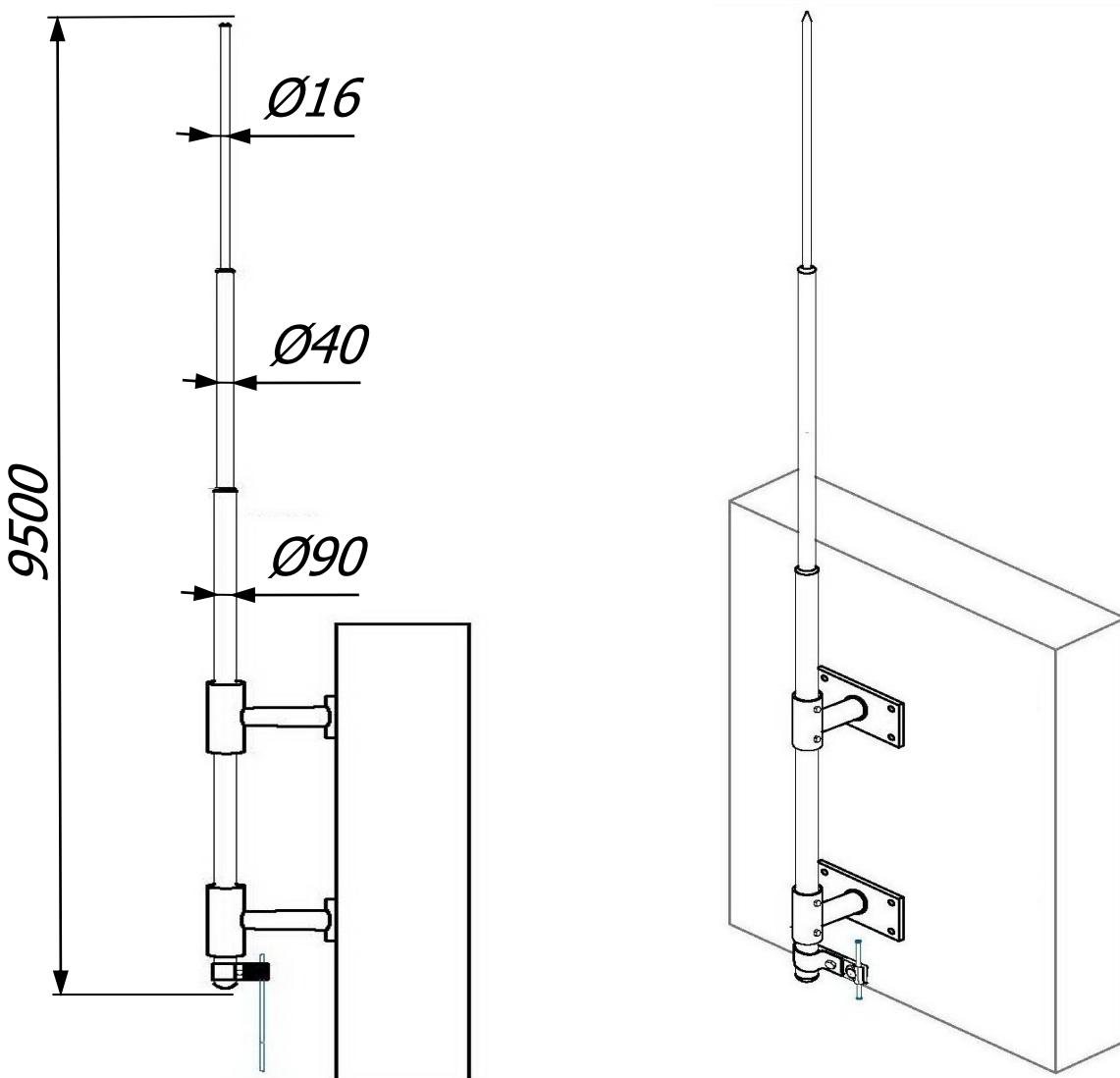
Молниеприёмная мачта 9,5 метра с креплением на стену и соединителем Громостар предназначена для защиты от ударов молнии элементов крыши или оборудования или конструкций, которые размещены на крышах зданий. Молниеприемник содержит все необходимые для монтажа компоненты, которые легко и надежно соединяются без использования сварки.
