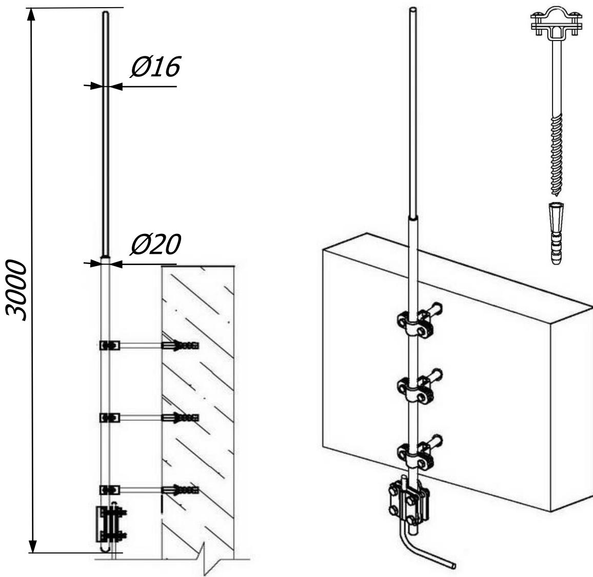
Стержневой молниеприёмник 3 метра с креплением на стену и соединителем Громостар предназначена для защиты от ударов молнии элементов крыши или оборудования или конструкций, которые размещены на крышах зданий. Молниеприемник содержит все необходимые для монтажа компоненты, которые легко и надежно соединяются без использования сварки.
