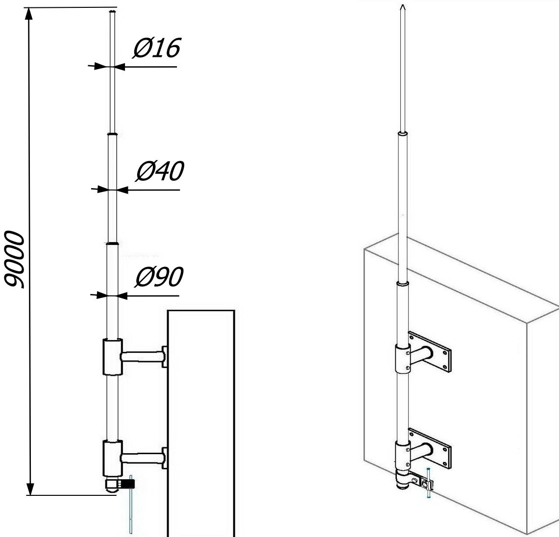
Молниеприёмная мачта 9 метра с креплением на стену и соединителем Громостар предназначена для защиты от ударов молнии элементов крыши или оборудования или конструкций, которые размещены на крышах зданий. Молниеприемник содержит все необходимые для монтажа компоненты, которые легко и надежно соединяются без использования сварки.
