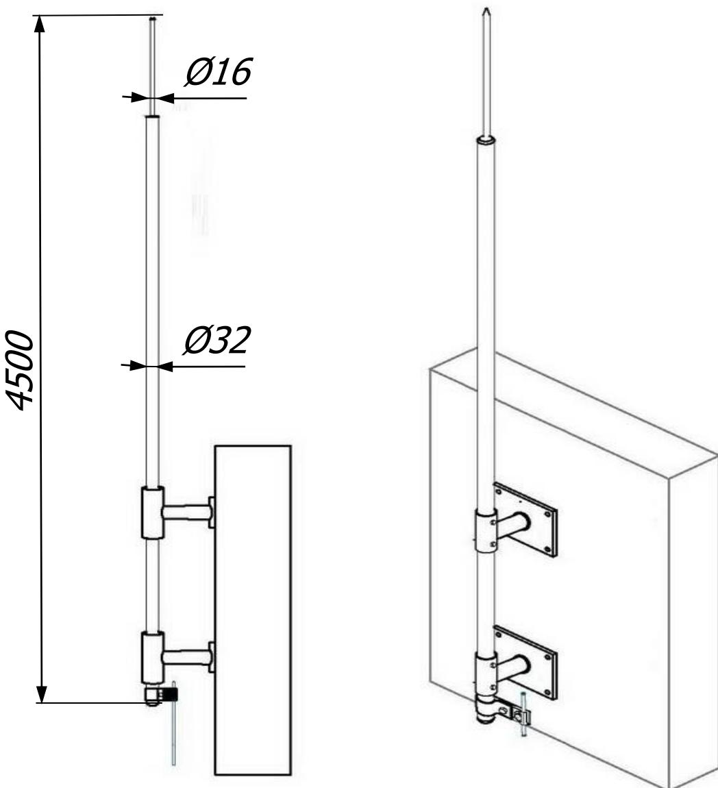
*Молниеприёмная мачта 4,5 метра с креплением на стену и соединителем Громостар предназначена для защиты от ударов молнии элементов крыши или оборудования или конструкций, которые размещены на крышах зданий. Молниеприемник содержит все необходимые для монтажа компоненты, которые легко и надежно соединяются без использования сварки.*
