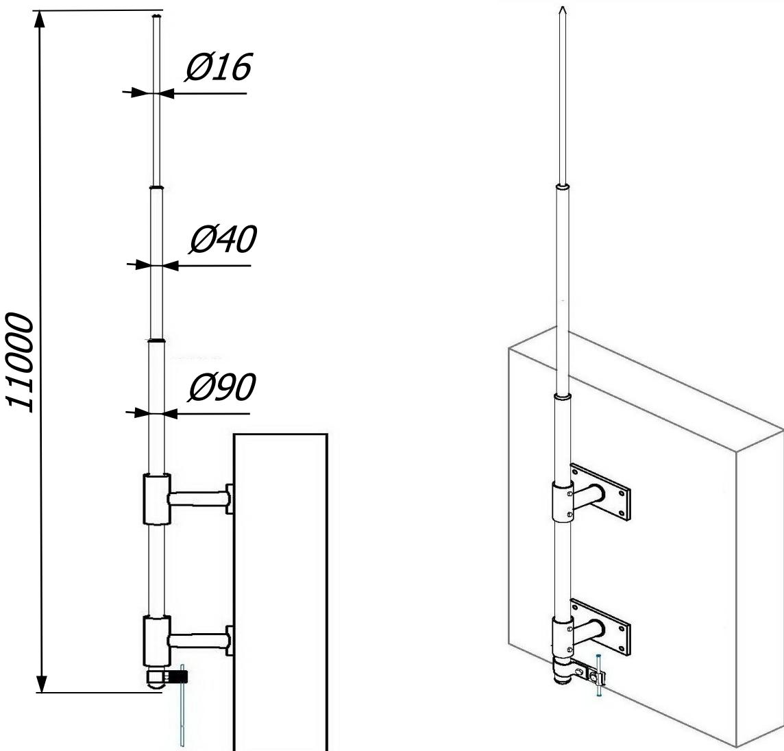
Молниеприёмная мачта 11 метра с креплением на стену и соединителем Громостар предназначена для защиты от ударов молнии элементов крыши или оборудования или конструкций, которые размещены на крышах зданий. Молниеприемник содержит все необходимые для монтажа компоненты, которые легко и надежно соединяются без использования сварки.
