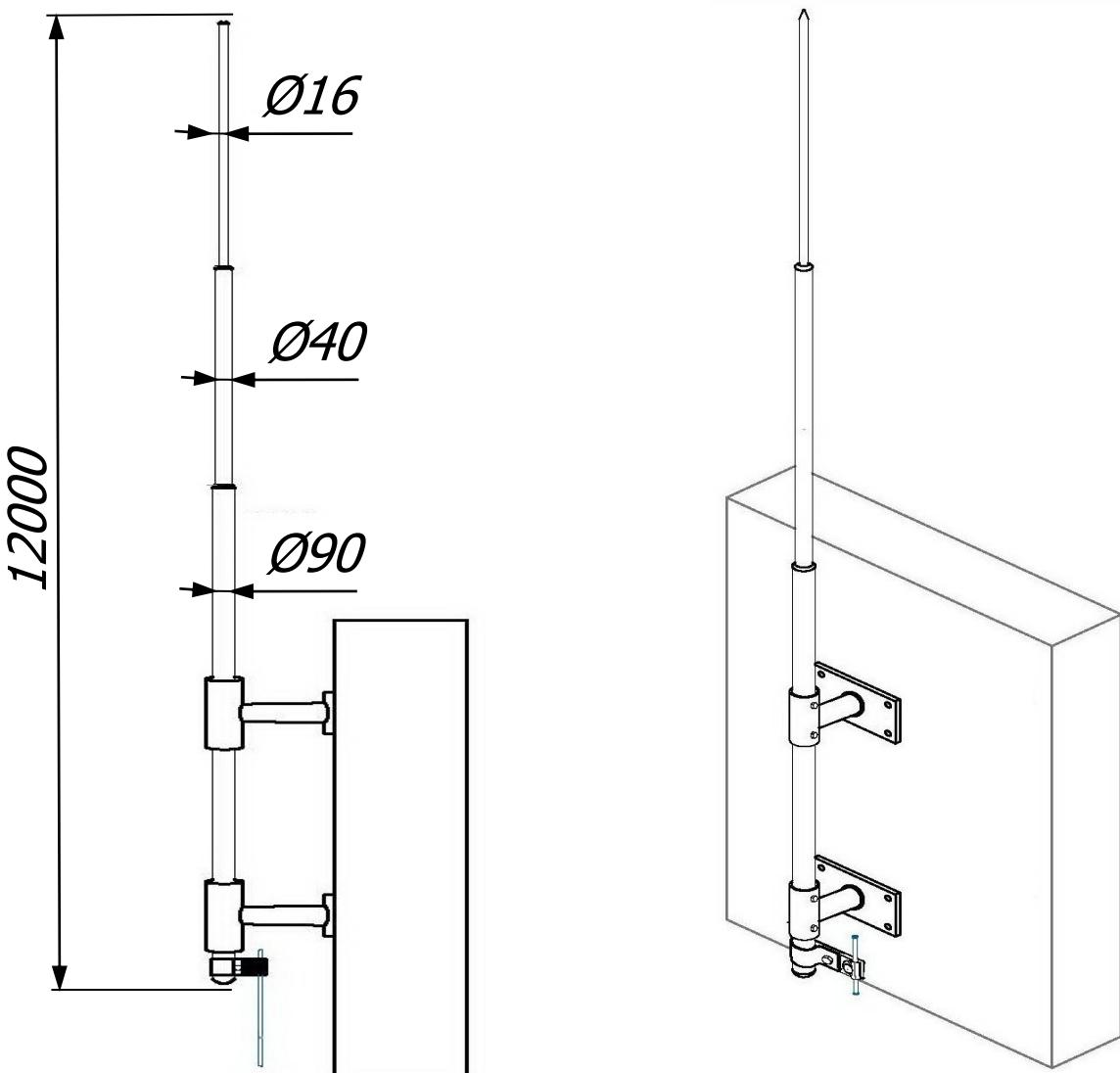
Молниеприёмная мачта 12 метра с креплением на стену и соединителем Громостар предназначена для защиты от ударов молнии элементов крыши или оборудования или конструкций, которые размещены на крышах зданий. Молниеприемник содержит все необходимые для монтажа компоненты, которые легко и надежно соединяются без использования сварки.
