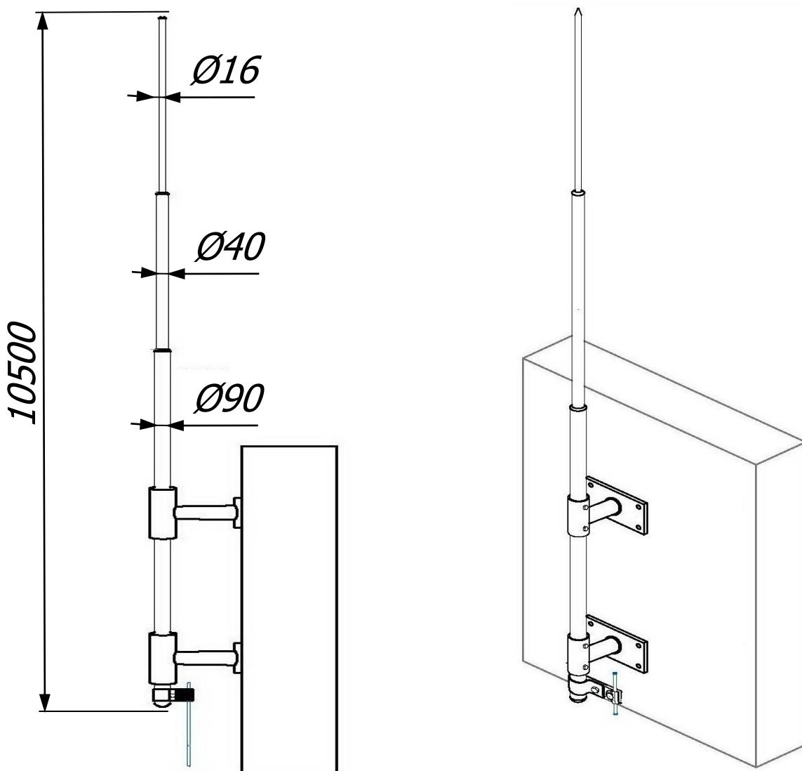
Молниеприёмная мачта 10,5 метра с креплением на стену и соединителем Громостар предназначена для защиты от ударов молнии элементов крыши или оборудования или конструкций, которые размещены на крышах зданий. Молниеприемник содержит все необходимые для монтажа компоненты, которые легко и надежно соединяются без использования сварки.
