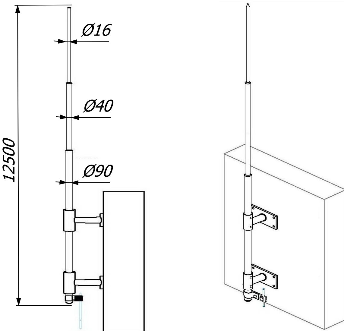
Молниеприёмная мачта 12,5 метра с креплением на стену и соединителем Громостар предназначена для защиты от ударов молнии элементов крыши или оборудования или конструкций, которые размещены на крышах зданий. Молниеприемник содержит все необходимые для монтажа компоненты, которые легко и надежно соединяются без использования сварки.
