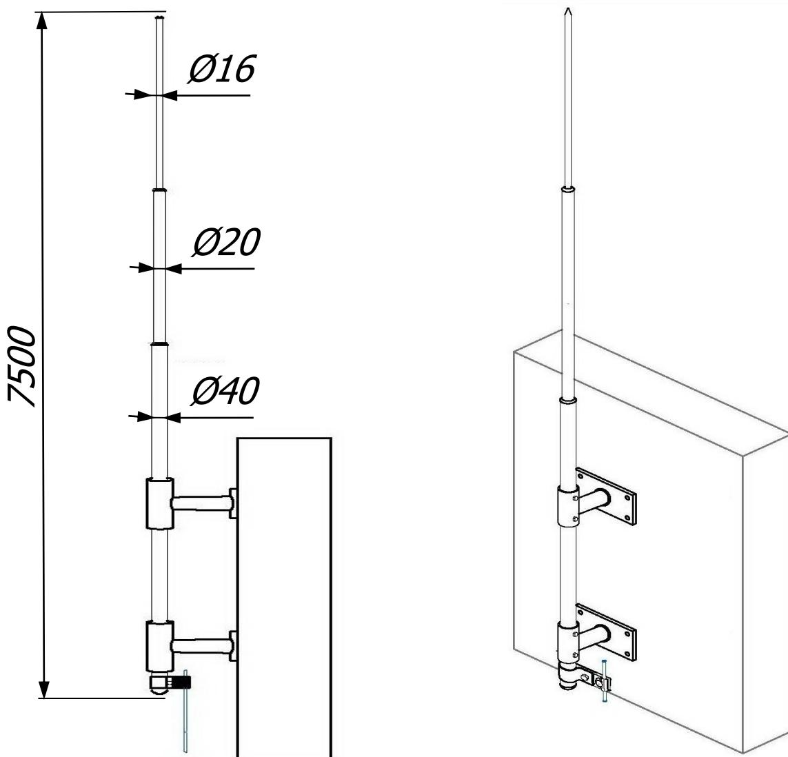
Молниеприёмная мачта 7,5 метра с креплением на стену и соединителем Громостар предназначена для защиты от ударов молнии элементов крыши или оборудования или конструкций, которые размещены на крышах зданий. Молниеприемник содержит все необходимые для монтажа компоненты, которые легко и надежно соединяются без использования сварки.
