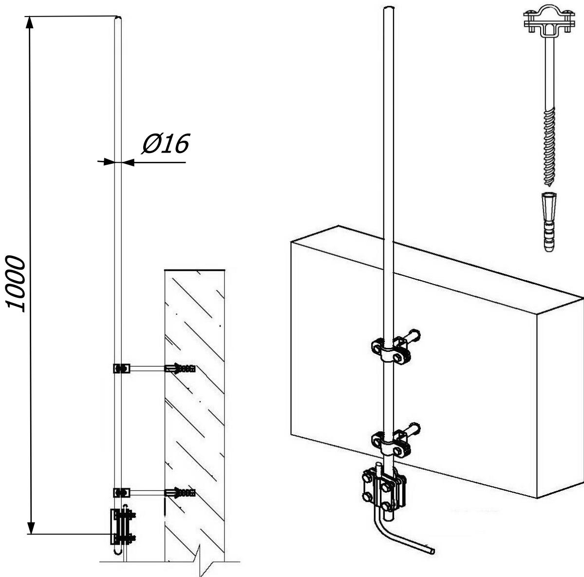
Стержневой молниеприёмник 1 метра с креплением на стену и соединителем Громостар предназначена для защиты от ударов молнии элементов крыши или оборудования или конструкций, которые размещены на крышах зданий. Молниеприёмник содержит все необходимые для монтажа компоненты, которые легко и надежно соединяются без использования сварки.
