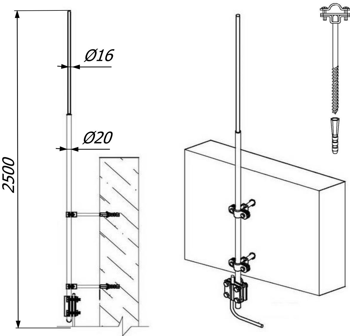
Стержневой молниеприёмник 2,5 метра с креплением на стену и соединителем Громостар предназначена для защиты от ударов молнии элементов крыши или оборудования или конструкций, которые размещены на крышах зданий. Молниеприемник содержит все необходимые для монтажа компоненты, которые легко и надежно соединяются без использования сварки.
