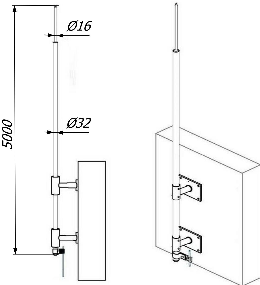
Молниеприёмная мачта 5 метра с креплением на стену и соединителем Громостар предназначена для защиты от ударов молнии элементов крыши или оборудования или конструкций, которые размещены на крышах зданий. Молниеприемник содержит все необходимые для монтажа компоненты, которые легко и надежно соединяются без использования сварки.
