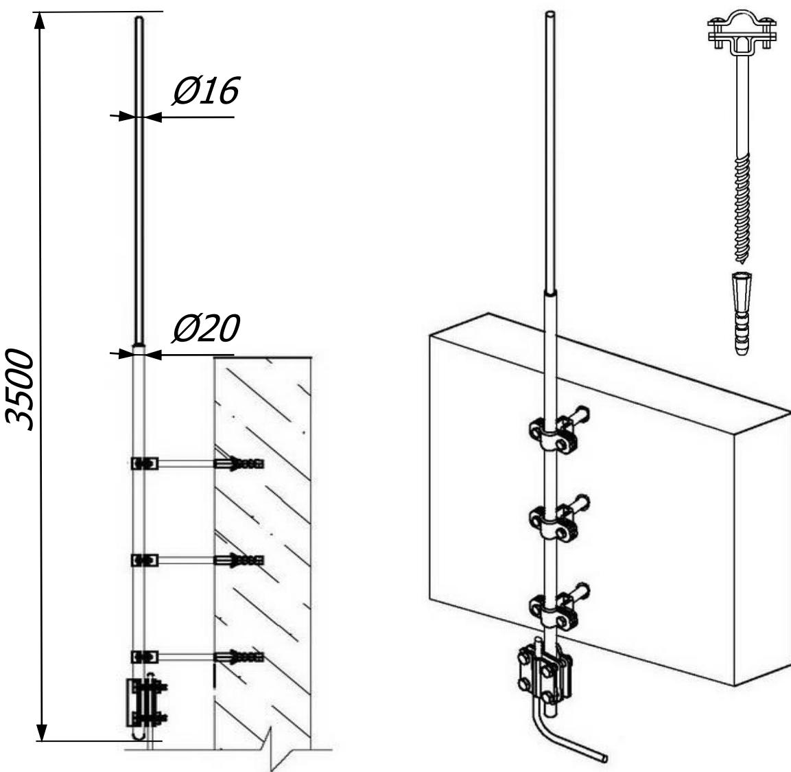
Стержневой молниеприёмник 3,5 метра с креплением на стену и соединителем Громостар предназначена для защиты от ударов молнии элементов крыши или оборудования или конструкций, которые размещены на крышах зданий. Молниеприемник содержит все необходимые для монтажа компоненты, которые легко и надежно соединяются без использования сварки.
