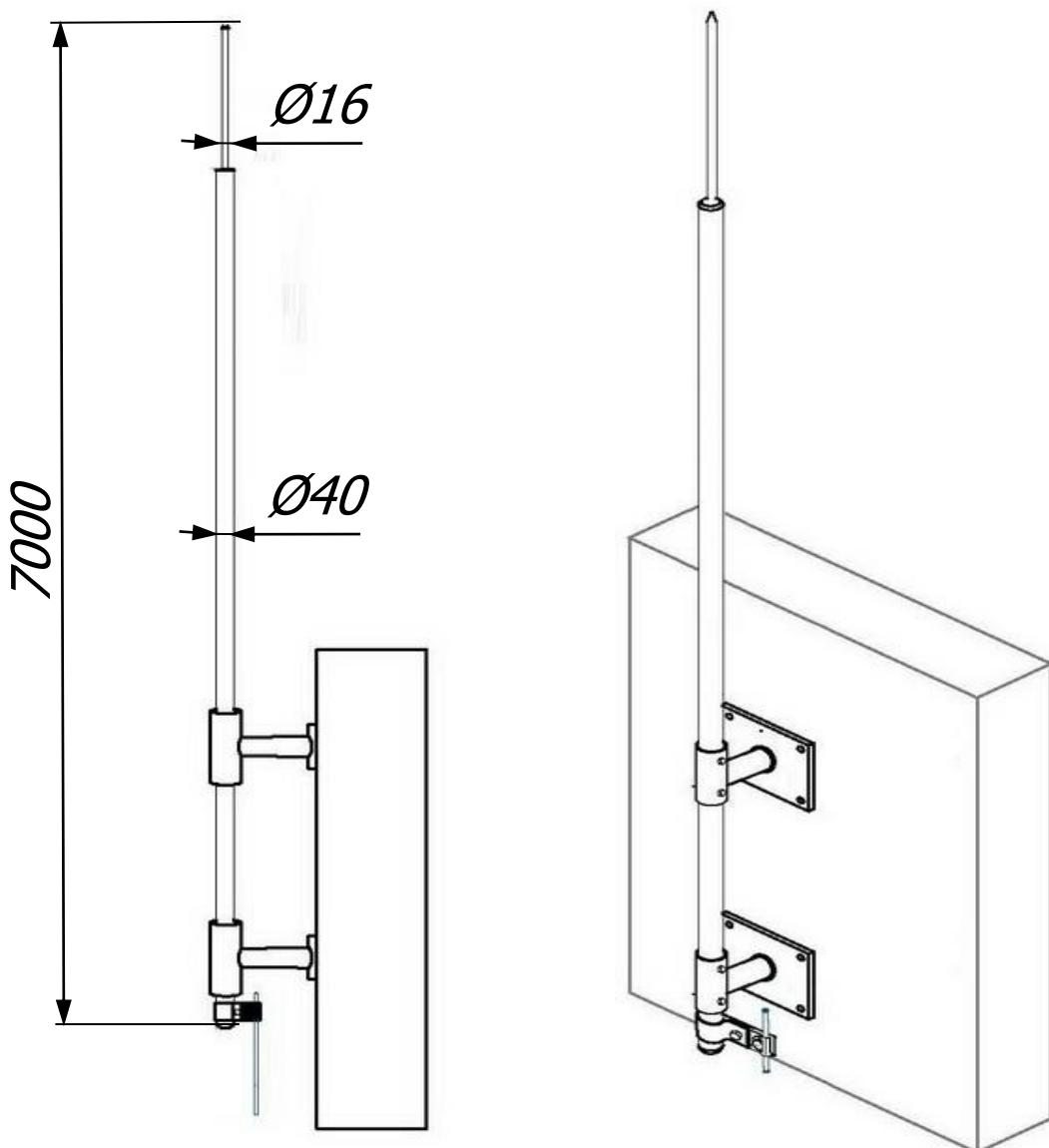
Молниеприёмная мачта 7 метра с креплением на стену и соединителем Громостар предназначена для защиты от ударов молнии элементов крыши или оборудования или конструкций, которые размещены на крышах зданий. Молниеприемник содержит все необходимые для монтажа компоненты, которые легко и надежно соединяются без использования сварки.
