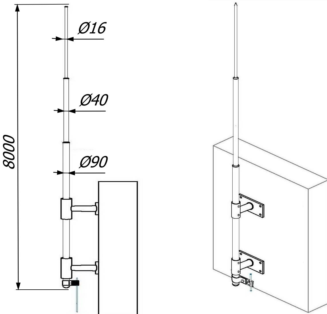
Молниеприёмная мачта 8 метра с креплением на стену и соединителем Громостар предназначена для защиты от ударов молнии элементов крыши или оборудования или конструкций, которые размещены на крышах зданий. Молниеприемник содержит все необходимые для монтажа компоненты, которые легко и надежно соединяются без использования сварки.
