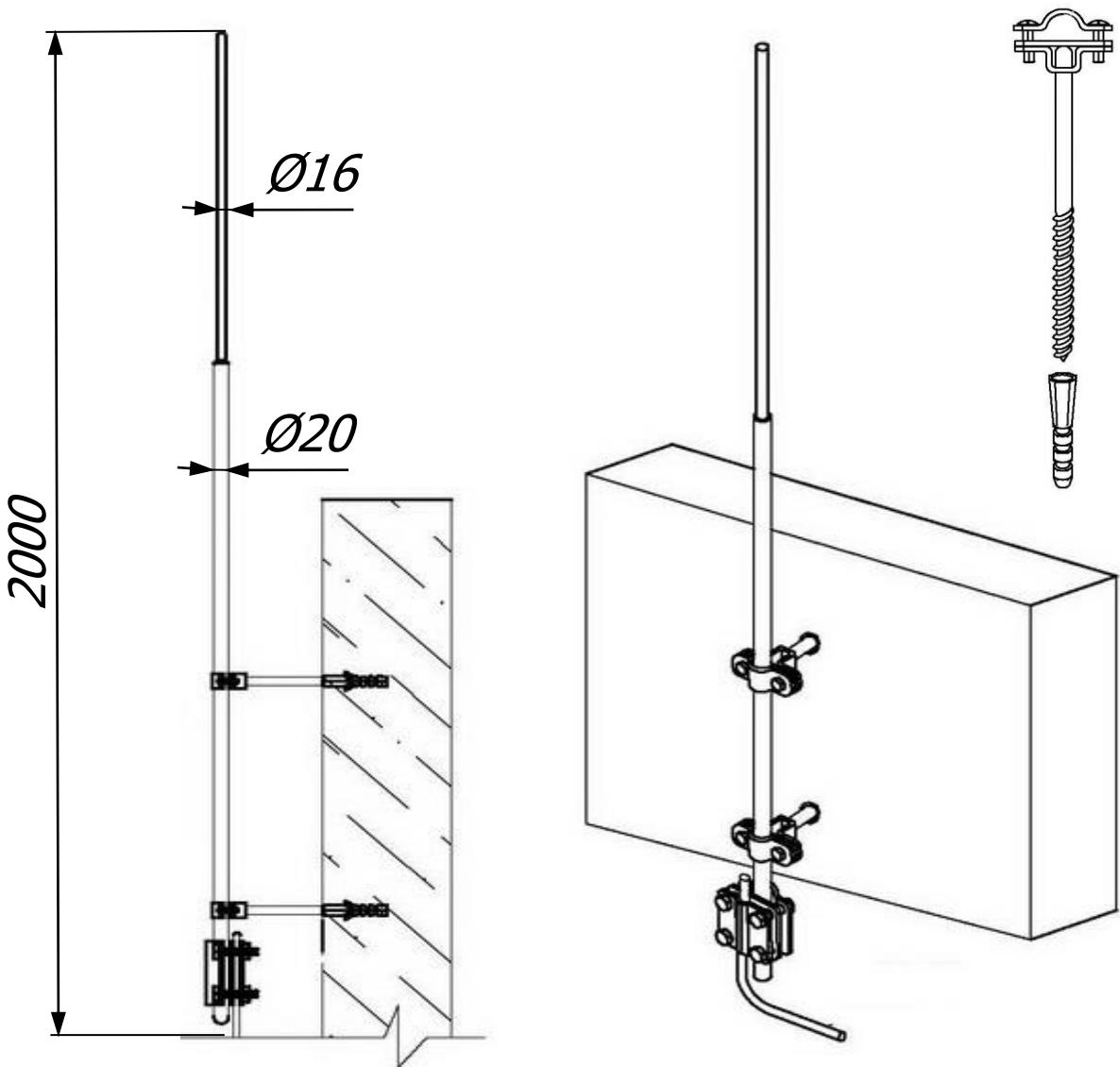
*Стержневой молниеприёмник 2 метра с креплением на стену и соединителем Громостар предназначена для защиты от ударов молнии элементов крыши или оборудования или конструкций, которые размещены на крышах зданий. Молниеприемник содержит все необходимые для монтажа компоненты, которые легко и надежно соединяются без использования сварки.*
