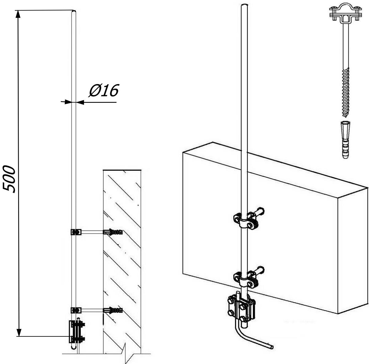
Стержневой молниеприёмник 0,5 метра с креплением на стену и соединителем Громостар предназначена для защиты от ударов молнии элементов крыши или оборудования или конструкций, которые размещены на крышах зданий. Молниеприёмник содержит все необходимые для монтажа компоненты, которые легко и надежно соединяются без использования сварки.
