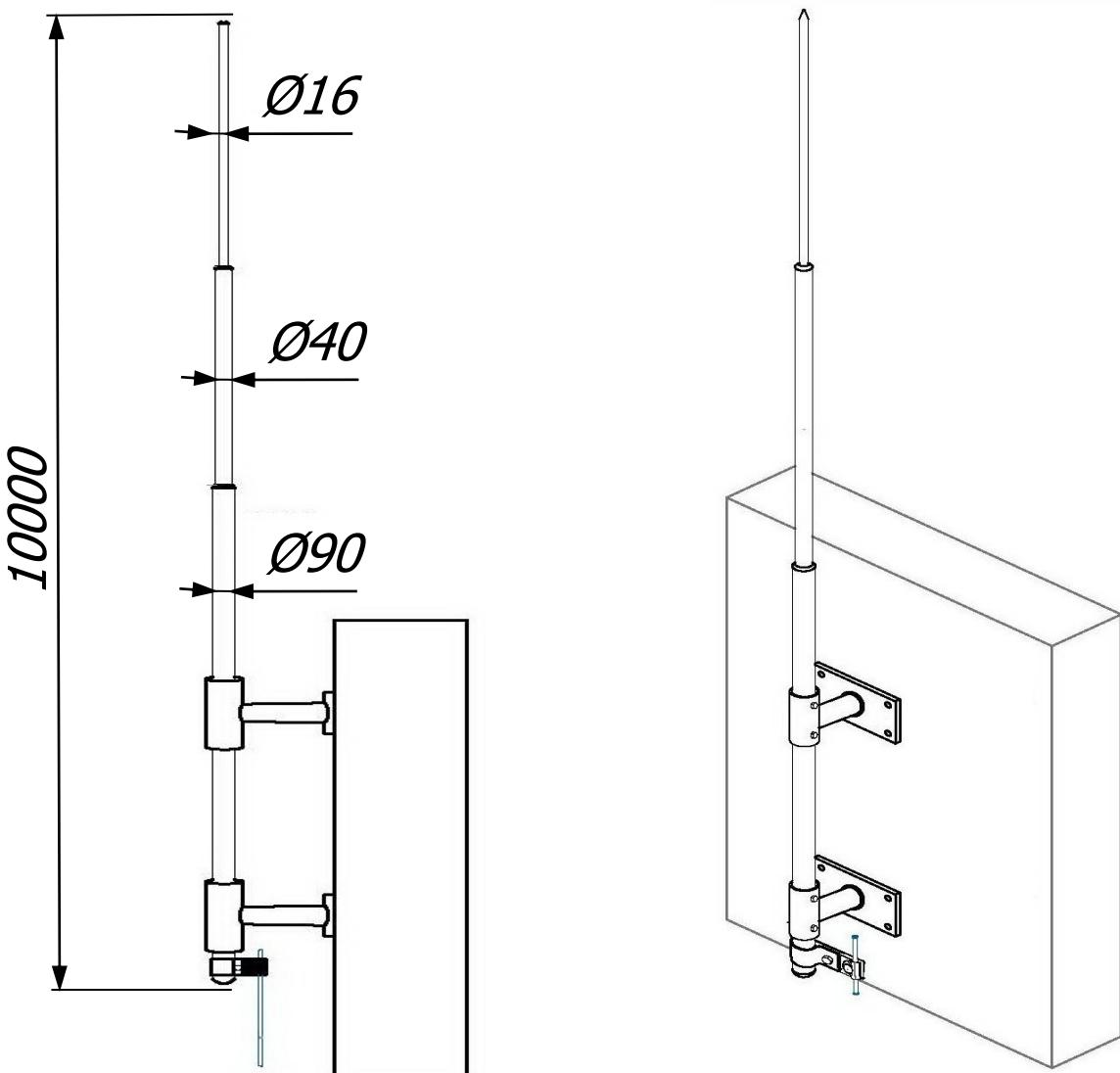
Молниеприёмная мачта 10 метра с креплением на стену и соединителем Громостар предназначена для защиты от ударов молнии элементов крыши или оборудования или конструкций, которые размещены на крышах зданий. Молниеприемник содержит все необходимые для монтажа компоненты, которые легко и надежно соединяются без использования сварки.
