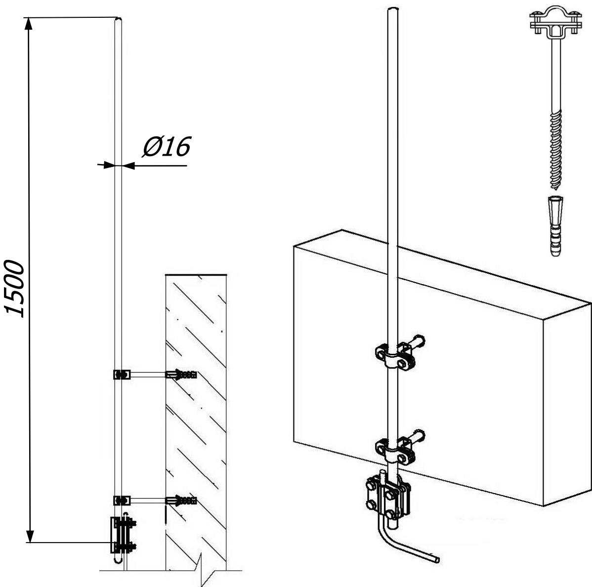
Стержневой молниеприемник 1,5 метра с креплением на стену и соединителем Громостар предназначена для защиты от ударов молнии элементов крыши или оборудования или конструкций, которые размещены на крышах зданий. Молниеприемник содержит все необходимые для монтажа компоненты, которые легко и надежно соединяются без использования сварки.
