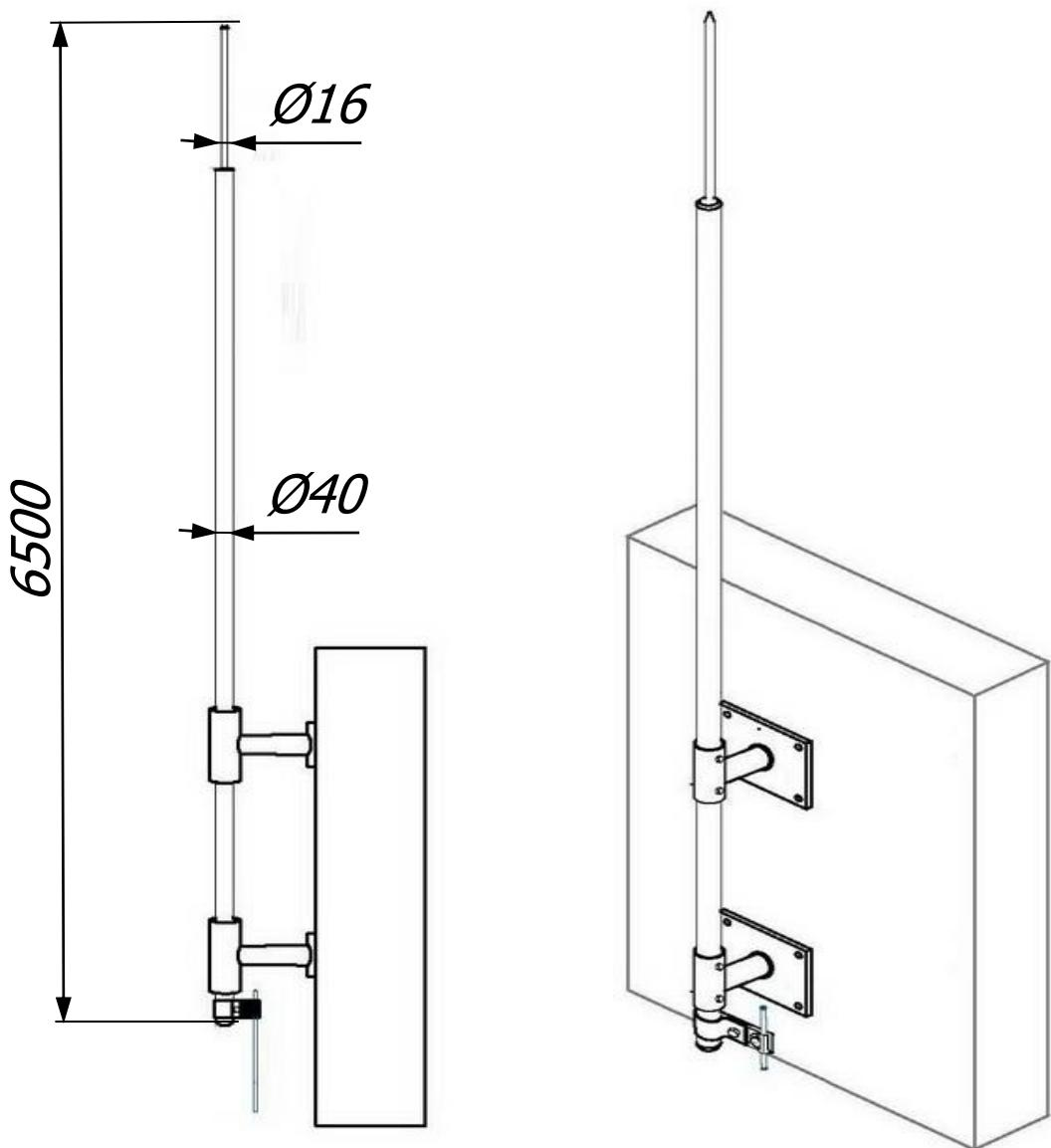
Молниеприёмная мачта 6,5 метра с креплением на стену и соединителем Громостар предназначена для защиты от ударов молнии элементов крыши или оборудования или конструкций, которые размещены на крышах зданий. Молниеприемник содержит все необходимые для монтажа компоненты, которые легко и надежно соединяются без использования сварки.
