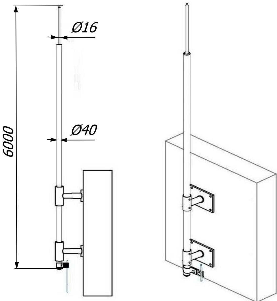
Молниеприёмная мачта 6 метра с креплением на стену и соединителем Громостар предназначена для защиты от ударов молнии элементов крыши или оборудования или конструкций, которые размещены на крышах зданий. Молниеприемник содержит все необходимые для монтажа компоненты, которые легко и надежно соединяются без использования сварки.
