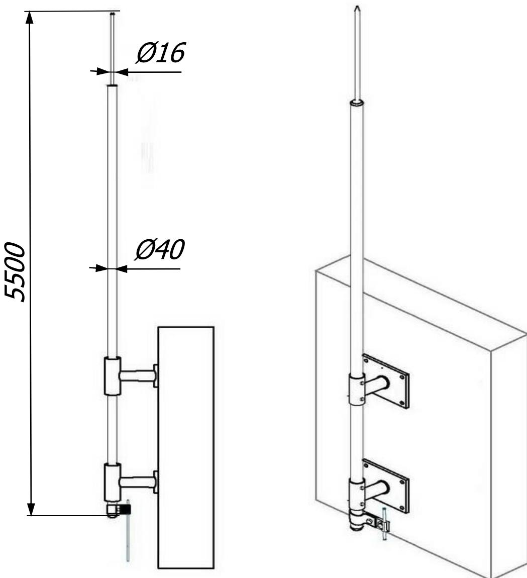
Молниеприёмная мачта 5,5 метра с креплением на стену и соединителем Громостар предназначена для защиты от ударов молнии элементов крыши или оборудования или конструкций, которые размещены на крышах зданий. Молниеприемник содержит все необходимые для монтажа компоненты, которые легко и надежно соединяются без использования сварки.
