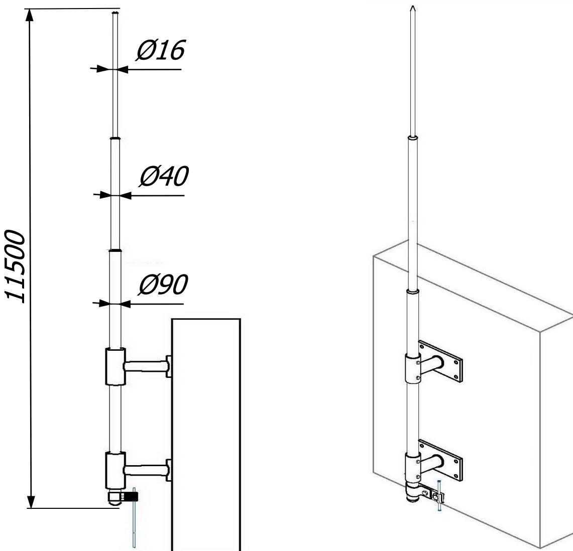
Молниеприёмная мачта 11,5 метра с креплением на стену и соединителем Громостар предназначена для защиты от ударов молнии элементов крыши или оборудования или конструкций, которые размещены на крышах зданий. Молниеприемник содержит все необходимые для монтажа компоненты, которые легко и надежно соединяются без использования сварки.
