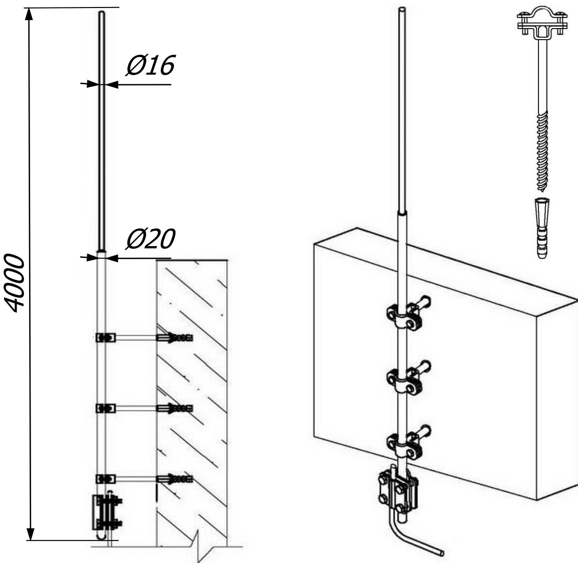
*Стержневой молниеприёмник 4 метра с креплением на стену и соединителем Громостар предназначена для защиты от ударов молнии элементов крыши или оборудования или конструкций, которые размещены на крышах зданий. Молниеприемник содержит все необходимые для монтажа компоненты, которые легко и надежно соединяются без использования сварки.*
