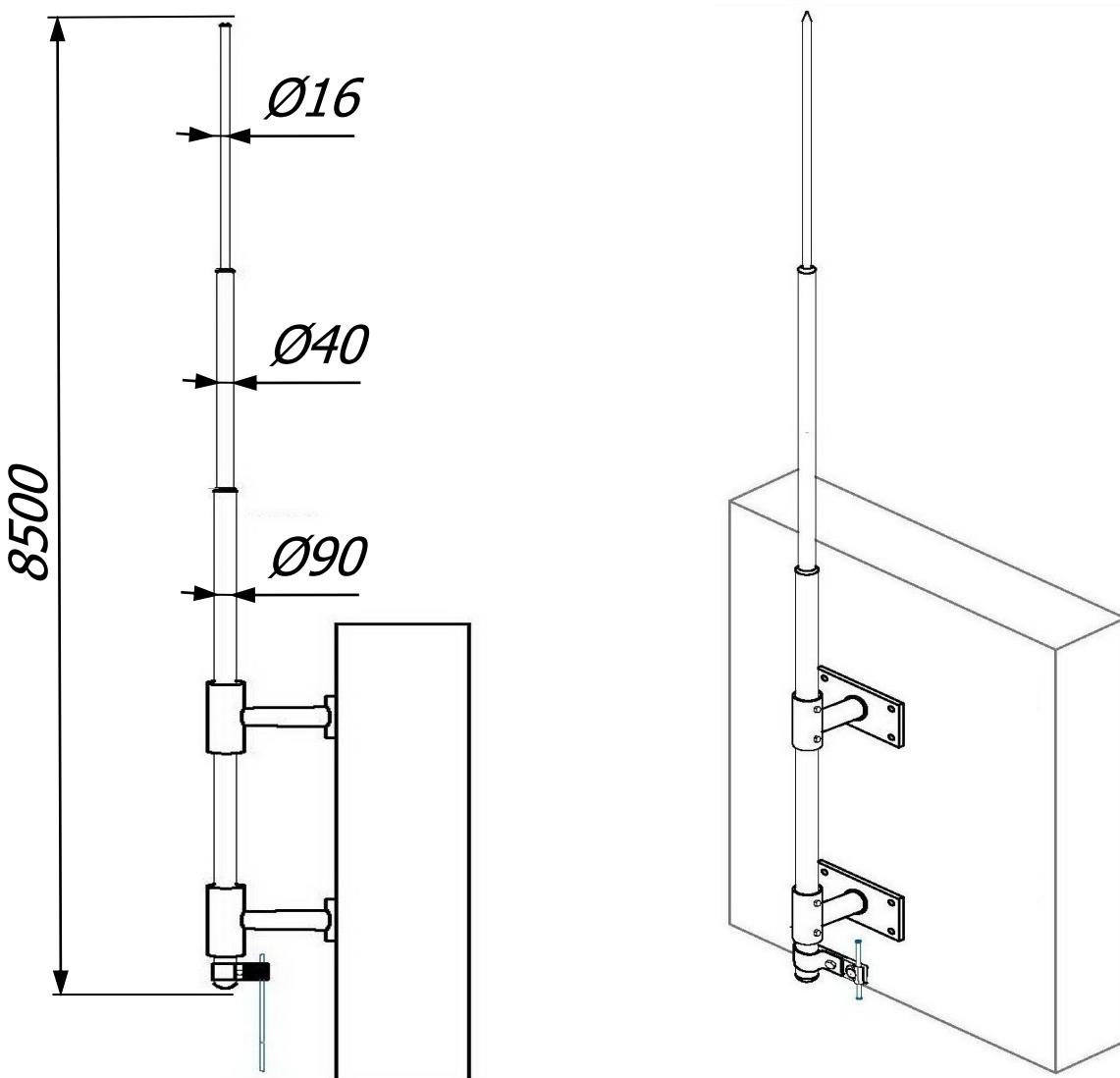
Молниеприёмная мачта 8,5 метра с креплением на стену и соединителем Громостар предназначена для защиты от ударов молнии элементов крыши или оборудования или конструкций, которые размещены на крышах зданий. Молниеприемник содержит все необходимые для монтажа компоненты, которые легко и надежно соединяются без использования сварки.
