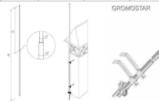
Молниеприёмник с крепление на стену 4 м. Gromostar выпускается из оцинкованной сталь St/Zn, меди Cu, нержавеющей стали VA и алюминия Al. Возможна порошковая окраска в стандартные цвета. Соответствует нормативным документам регламентирующими требования к молниезащите зданий: «Инструкция по молниезащите зданий и сооружений» РД 34.21.122-87 от 30 июля 1987 года и «Инструкция по устройству молниезащиты зданий, сооружений и промышленных коммуникаций» CO 153-343.21.122-2003 от 30 июня 2003 г.
