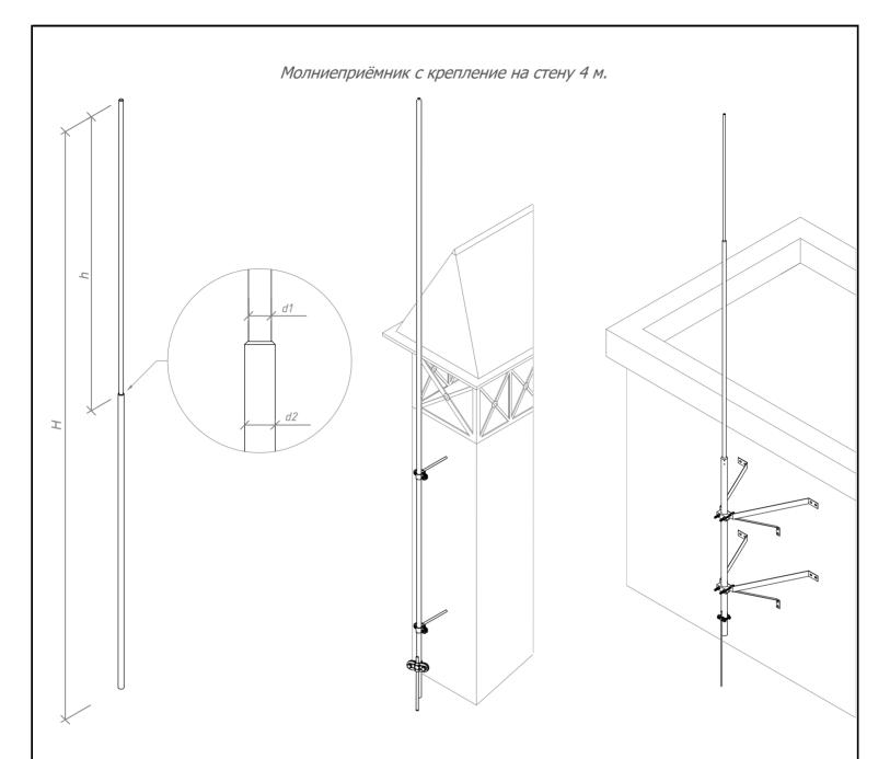
Молниеприёмник с крепление на стену 4 м. Gromostar предназначен для установки на объекты при выполнении работ по молниезащите. Молниеприёмник с крепление на стену имеет в комлекте: молниеприёмник, набор креплений на стену, соединитель проводника и молниеприёмника. Молниеприёмник с крепление на стену при правильных расчётах позволяет перехватывать молнии, тем самым защещать ваш объект. Подробности касающиеся способа установки и крепления найдете на сайте.
