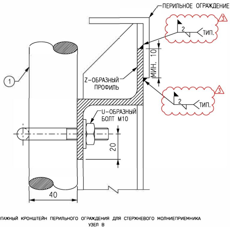
МОНТАЖНЫЙ КРОНШТЕЙН ПЕРИЛЬНОГО ОГРАЖДЕНИЯ ДЛЯ СТЕРЖНЕВОГО МОЛНИЕПРИЕМНИКА
