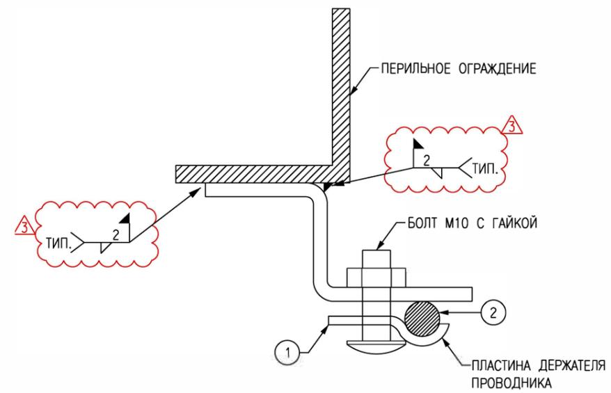
СОЕДИНЕНИЕ С МЕТАЛЛИЧЕСКИМ ПЕРИЛЬНЫМ ОГРАЖДЕНИЕМ
