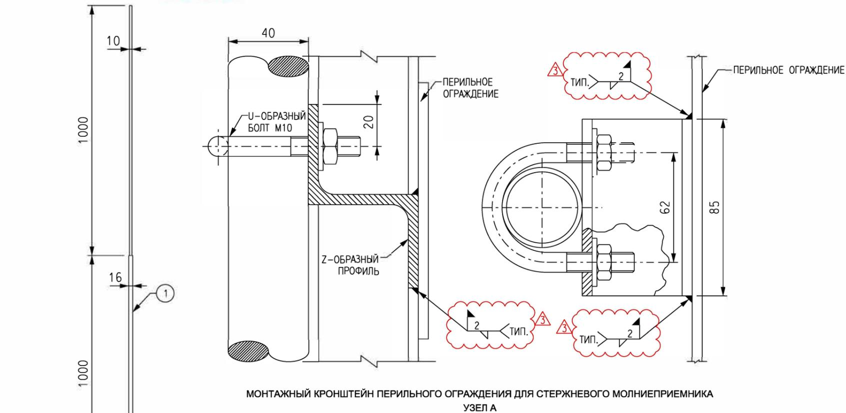
МОНТАЖНЫЙ КРОНШТЕЙН ПЕРИЛЬНОГО ОГРАЖДЕНИЯ ДЛЯ СТЕРЖНЕВОГО МОЛНИЕПРИЕМНИКА
