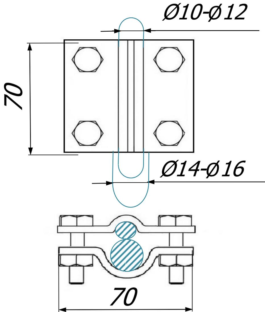
Соединитель круглого проводника  $\varnothing 10$  мм. -  $\varnothing 12$  мм. и прута  $\varnothing 14$  мм. -  $\varnothing 16$  мм. с четырьмя болтами зажатия, размером 70x70 мм предназначен для соединения круглых и плоских проводников. Соединители выпускаются из различных материалов что дает возможность соединять круглые и плоские проводники, молниеприёмники и стержней заземления всех видов. При помощи соединителя можно соединить проводник параллельно, перпендикулярно или Т-образно.
