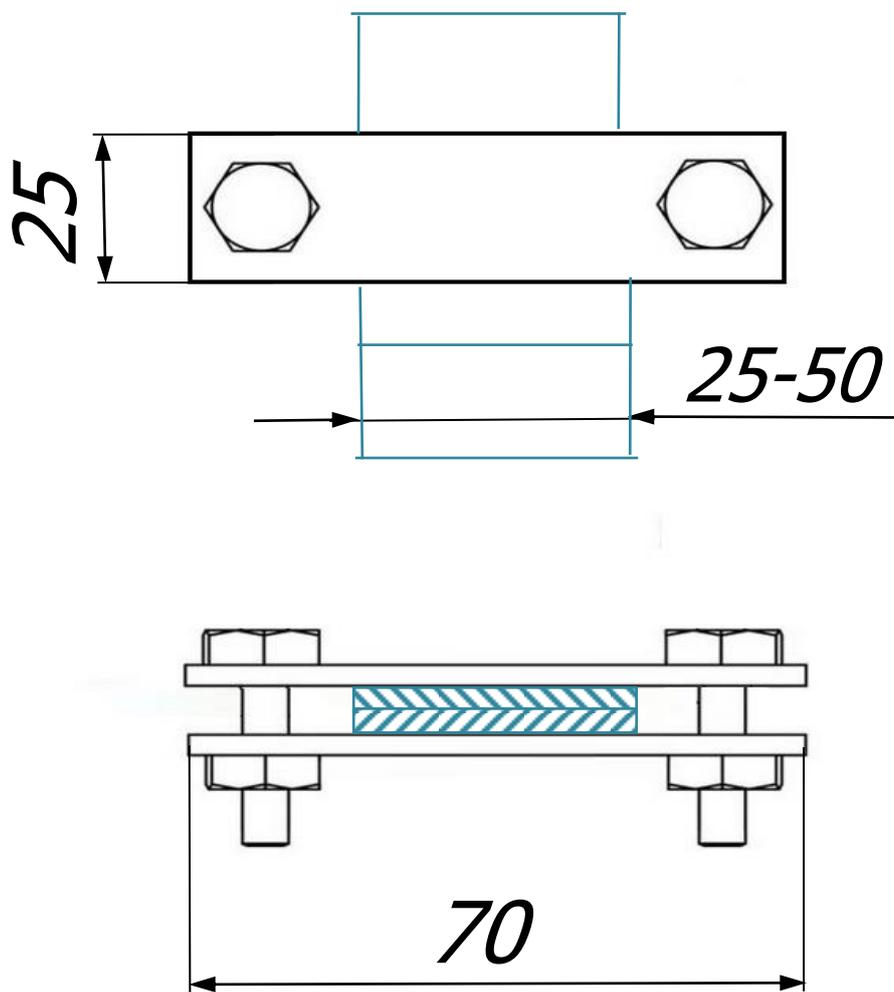
Соединитель плоского проводника с двумя болтами зажатия, размером 70x70 мм предназначен для соединения круглых и плоских проводников. Соединители выпускаются из различных материалов что дает возможность соединять круглые и плоские проводники, молниеприёмников всех видов. При помощи соединителя можно соединить проводник параллельно.
