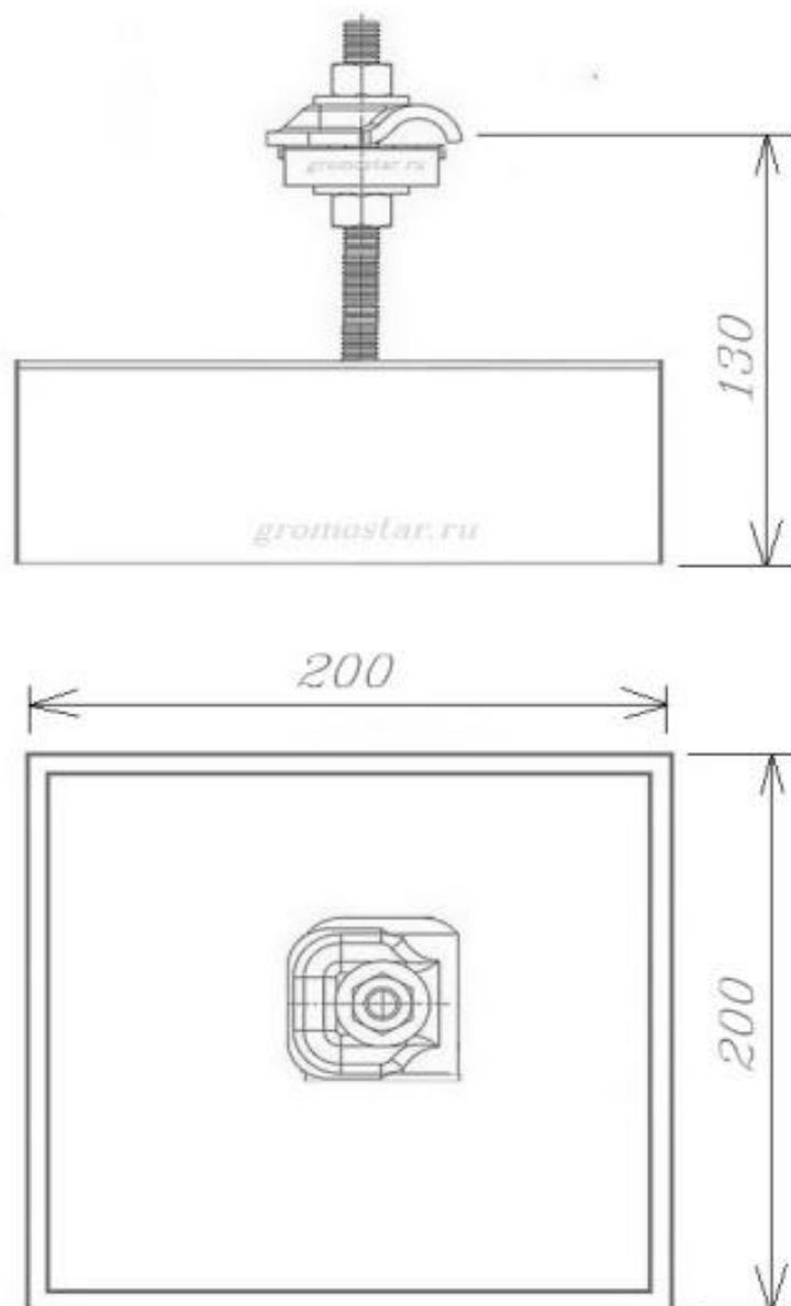
Держатель проводника для плоской кровли (негорючий) Gromostar для круглого проводника  $\varnothing 6$ - $\varnothing 10$  мм., размером 130x200x200 мм. предназначен для крепления проводника при устройстве молниезащиты. Держатель проводника для плоской кровли устанавливается на плоскую, инверсионную, ПВХ кровлю под собственным весом. Дополнительно можно приклеить. Держатель проводника для плоской кровли подробности касающиеся способа установки и крепления найдете на сайте.
