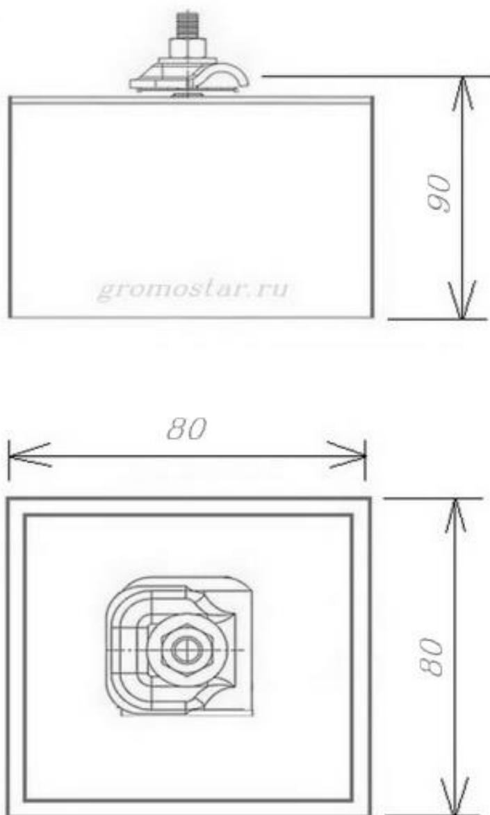
Держатель проводника круглого с бетоном (негорючий) Gromostar для круглого проводника  $\varnothing 6\text{-}\varnothing 10$  мм., размером 90x80x80 мм. предназначен для крепления проводника при устройстве молниезащиты. Держатель проводника круглого с бетоном устанавливается на плоскую, инверсионную, ПВХ кровлю под собственным весом. Дополнительно можно приклеить. Держатель проводника круглого с бетоном подробности касающиеся способа установки и крепления найдете на сайте.
