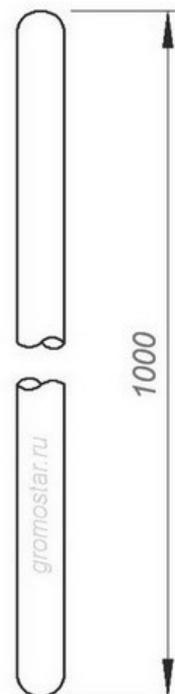
Gromostar выпускается из оцинкованной сталь St/Zn, меди Cu, нержавеющей стали VA и алюминия Al. Возможна порошковая окраска в стандартные цвета. Соответствует нормативным документам регламентирующими требования к молниезащите зданий: «Инструкция по молниезащите зданий и сооружений» РД 34.21.122-87 от 30 июля 1987 года и «Инструкция по устройству молниезащиты зданий, сооружений и промышленных коммуникаций» СО 153-343.21.122-2003 от 30 июня 2003 г.
