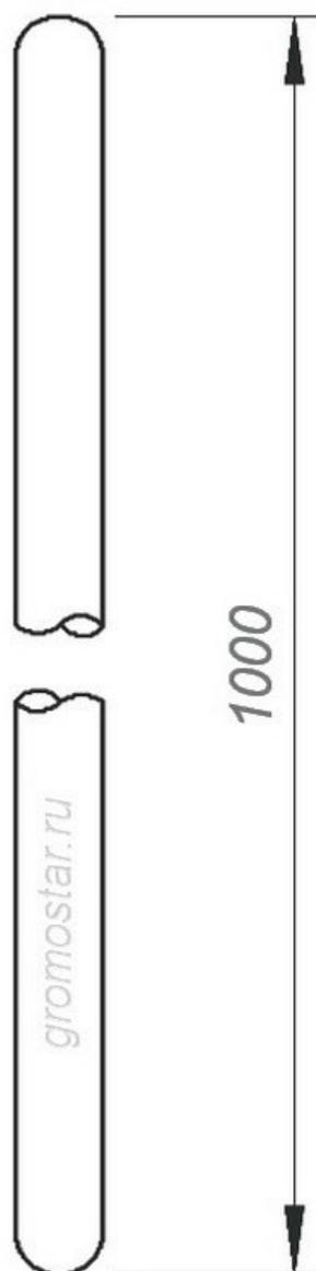
Молниеприёмник 1 м. Gromostar высотой 1 м., предназначен для установки на объекты при выполнении работ по молниезащите. Молниеприёмник при помощи различных креплений можно установить на кровлю, стену, трубы, конёк, грунт. Для подбора крепления смотрите группу 2. Молниеприёмник при правильных расчётах позволяет перехватывать молнии, тем самым защищать ваш объект. Подробности касающиеся способа установки и крепления найдете на сайте.
