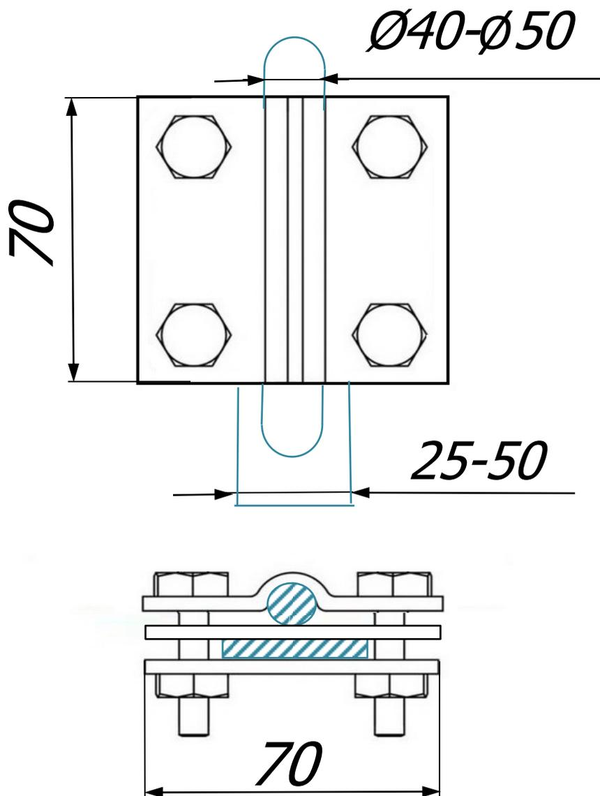
Соединитель плоского проводника и молниеприемной мачты  $\varnothing 40$  мм. -  $\varnothing 50$  мм. с четырьмя болтами зажатия и разделительной пластиной, размером 70x70 мм предназначен для соединения круглых и плоских проводников. Соединители выпускаются из различных материалов что дает возможность соединять круглые и плоские проводники, молниеприёмники и молниеприемные мачты всех видов. При помощи соединителя можно соединить проводник параллельно, перпендикулярно или Т-образно.
