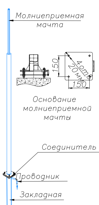
Узел Мачта с откидным механизмом с закладной
