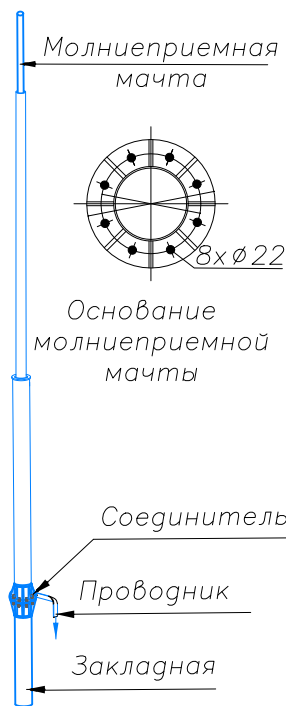
Узел Молниеприемная мачта с закладной на грунт
