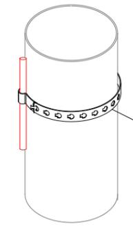
Вариант выполнения токоотвода на случай, где пустить токоотвод по водостоку останется невозможным
